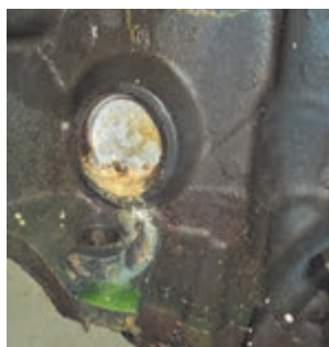
شکل ۱-۲ الف) نشستی از لوله‌ها و پولک اطراف سیلندر
