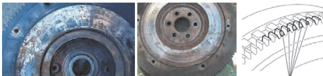
خرابی جای پیچ و سطح تماس با سیستم کلاچ
