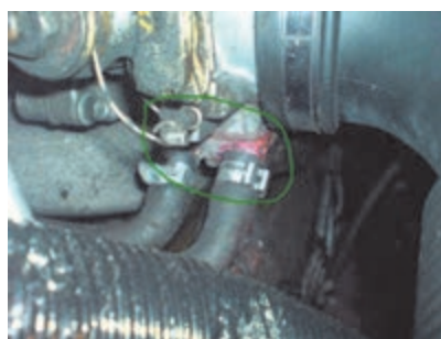
شکل ۱-۲ الف) نشستی از لوله‌ها و پولک اطراف سیلندر
