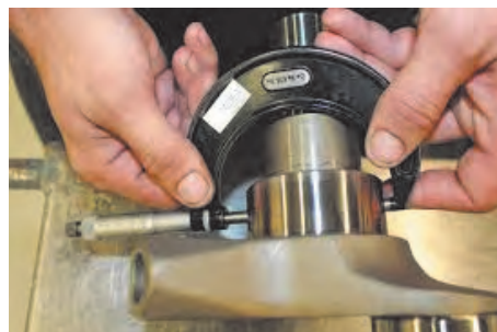
مرحله ۲: اندازه‌گیری قطر لنگ یا محور ثابت
