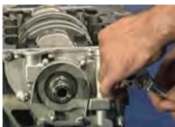
نصب مجموعه روغن بر روی بلوک سیلندر
