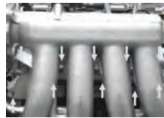
باز کردن پیچ‌های مانیفولد ورودی
