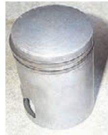
الف) پیستون قدیمی با وزن بیشتر
