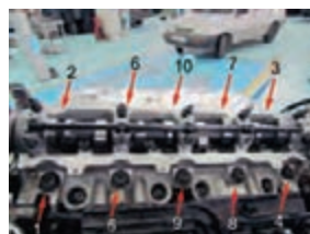
ترتیب باز کردن پیچ های سرسیلندر
