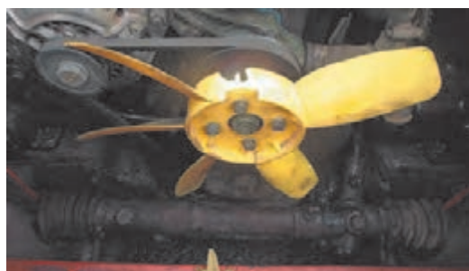
وجود شکستگی یا ترک پره‌ها
