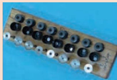
حفظ ترتیب تایپیت ها و شیم های سوپاپ
