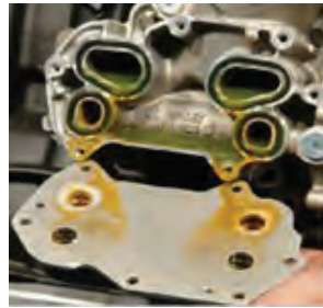
نصب درپوش خنک کن روغن
