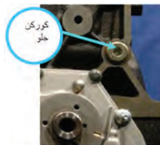
نصب پیچ‌های کورکن روی بلوک
