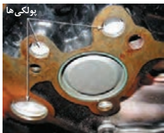
پولکی‌های نصب شده
