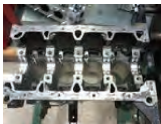
نصب نازل‌های روغن در صورت وجود
