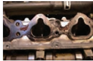
آثار نشتی مانیفولد دود روی سرسیلندر
