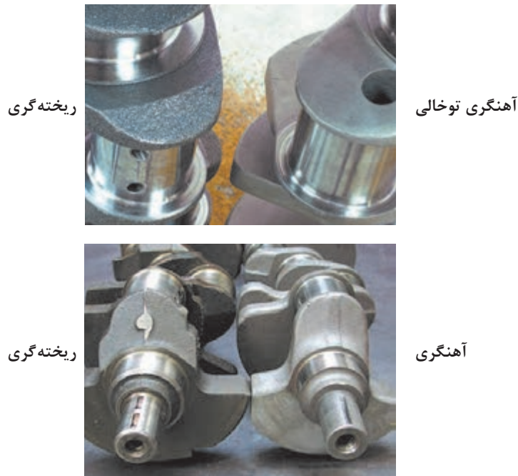
مقایسه ظاهری بین میل لنگ‌های تولید شده با روش ریخته‌گری و آهن‌گری
