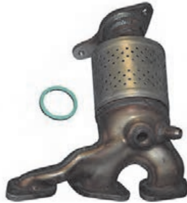
محل نصب مانیفولد خروجی و کاتالیست روی موتور خودرو مجموعه مانیفولد خروجی و کاتالیست شکل ۳-۵ مبدل کاتالیست یکپارچه
