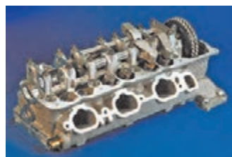
محل نصب مانیفولد خروجی روی
