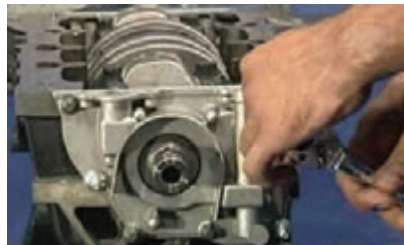
باز کردن پیچ های پمپ روغن
