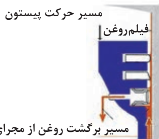
ب) برگشت روغن به کارتر توسط رینگ روغن
