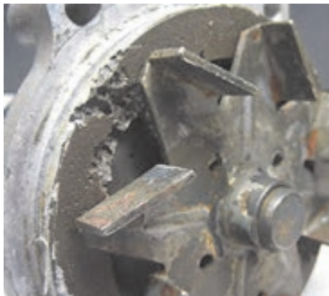
خرابی بلبرینگ و خوردگی داخلی
