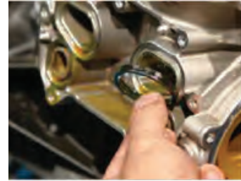
نصب اورینگ ها و واشرهای خنک کن روغن
