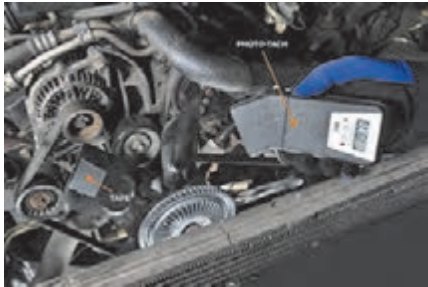
قبل از باز کردن: تفاوت دور پروانه و دور موتور با توجه به دمای مایع خنک کننده
