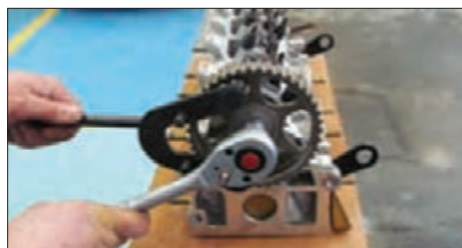
مراحل باز کردن چرخ تسمه
