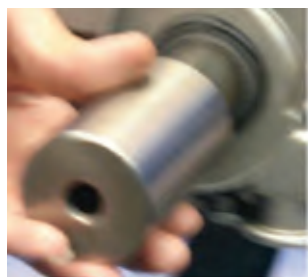
نصب کاسه نمدها با ابزار مخصوص
