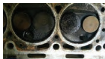
ورود روغن به داخل سیلندر از ناحیه گاید سوپاپ ورودی
