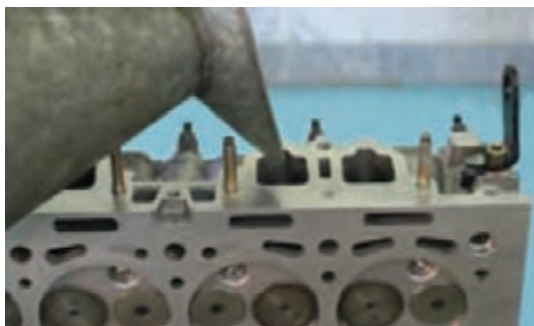
نشستی سنجی سوپاپ‌ها به وسیله مایع در راهگاه سوپاپ‌ها
