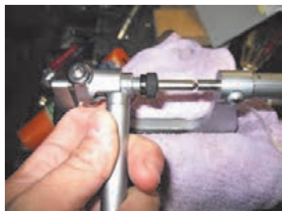
مرحله ۳: کالیبره کردن ساعت در میکرومتر و خواندن اختلاف (لقی)
