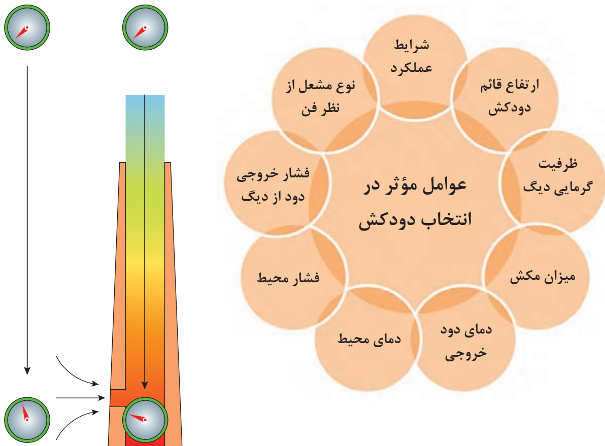
شکل ۳۶ - اختلاف فشار بین دودکش
