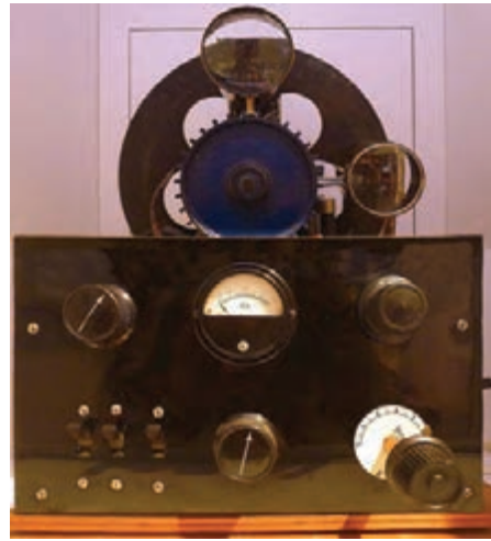
تصویر ۲۵ دستگاه پل نیپکو که منجر به اختراع تلویزیون شد
