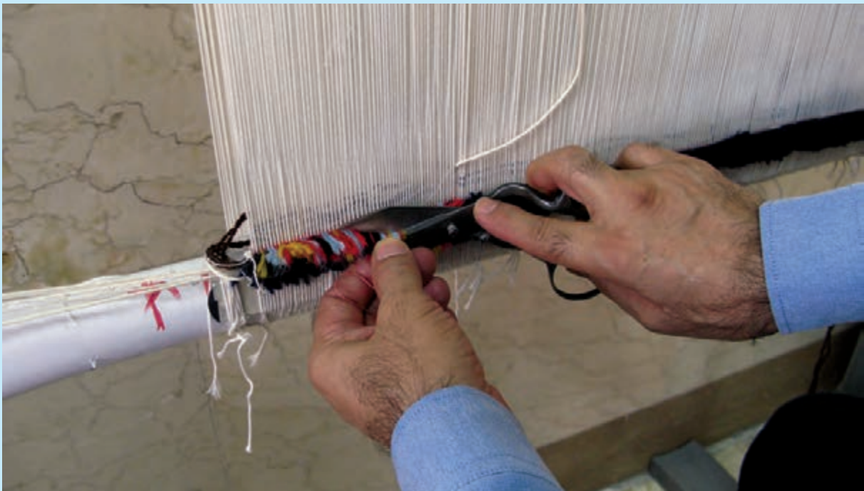
پرداخت اولیه (قیچی کردن پرزهای اضافی)
