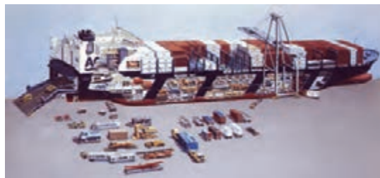
شکل ۱۴- کشتی حمل خودرو (با قابلیت حمل کانتینر) و تصویری از نمای داخلی آن
