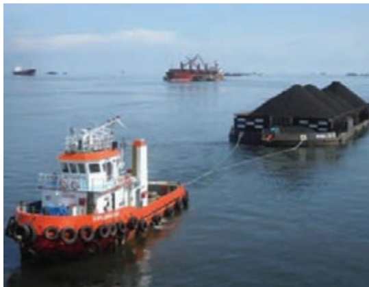
شکل ۲۲- یدک کش در حال حمل بارج
