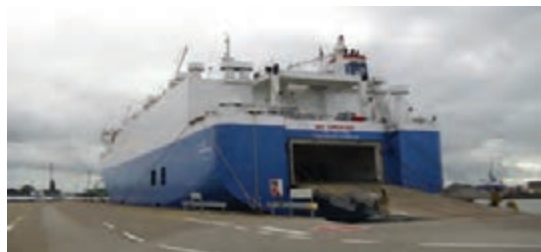
شکل ۱۴- کشتی حمل خودرو (با قابلیت حمل کانتینر) و تصویری از نمای داخلی آن
