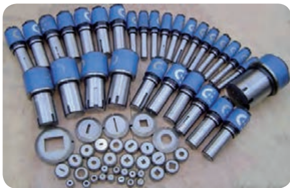
نمونه های سنبه‌های دستگاه پانچ CNC
