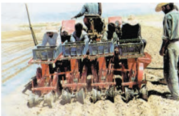
شکل ۱۲-۳- کاشت نشاها با ماشین نشاکار
