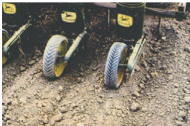
شکل ۵-۳- نحوه تنظیم بذر افشان تراکتوری در اراضی شور
