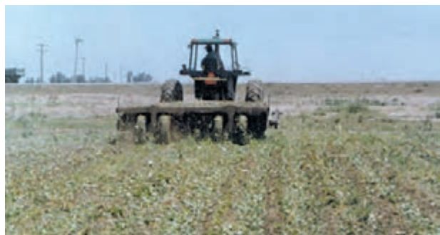
شکل ۱۲-۵- برداشت ماشینی سرزنی چغندر
