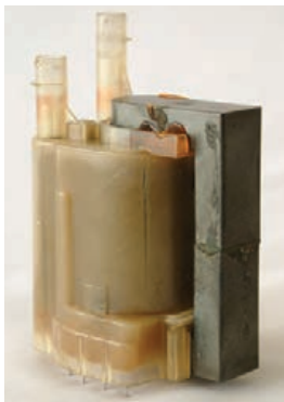
شکل ۱-۱۳۳- شکل ظاهری ترانسفورماتور TR526
