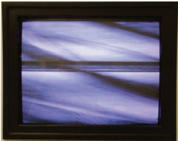
شکل ۱-۴۹- عدم تنظیم فرکانس نوسان ساز افقی
