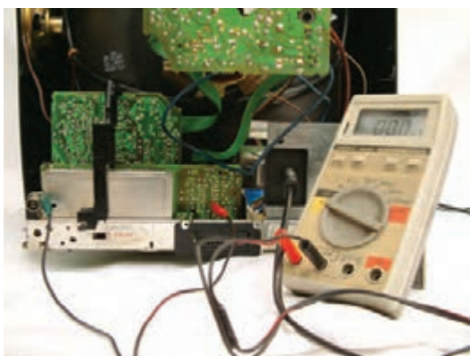
شکل ۱-۶۱°- اتصال ولت‌متر به پایه‌ی ۱۰
