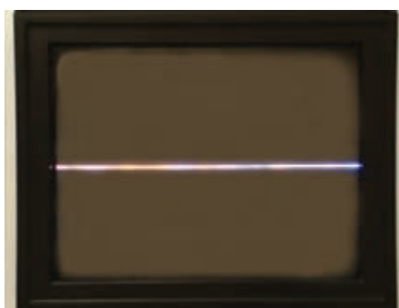
شکل ۲-۴۰- نوسان ساز عمودی از کار افتاده است.
