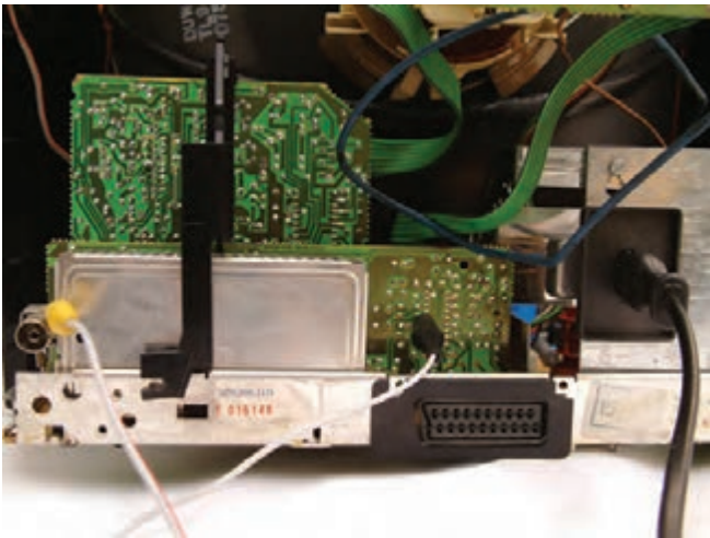
شکل ۱-۶۸ - پایه ۵ آی سی ۲۲۶۰ به شاسی اتصال کوتاه شده است.
