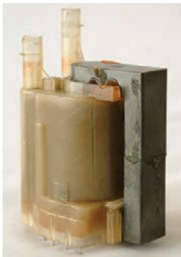
شکل ۱-۱۱۱ - ترانسفورماتور ولتاژ زیاد
