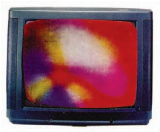
شکل ۸۰-۱- عدم ایجاد خلوص رنگ
