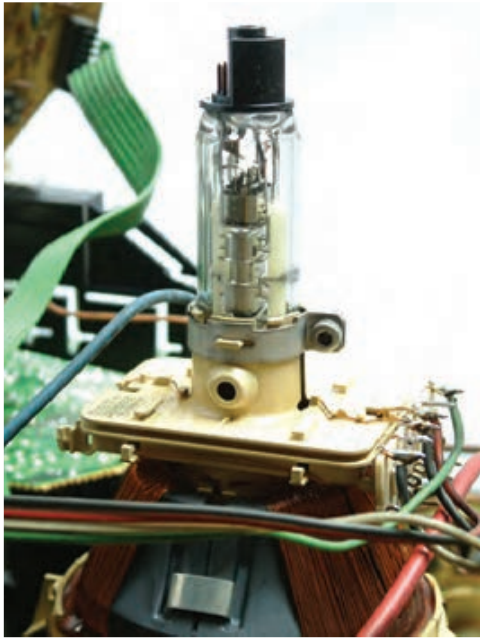
شکل ۱-۷۱-الف - شکل لامپ تصویر و پایه‌های آن
