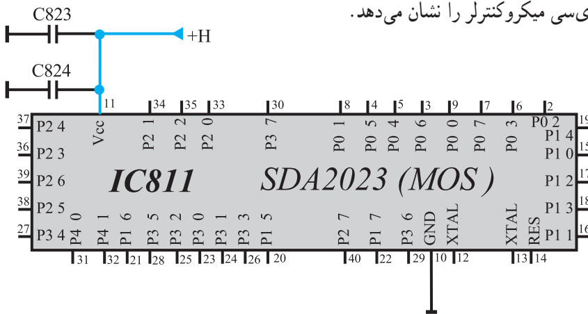
شکل ۲-۵۰- پایه ۱۱ آی سی میکروکنترلر
