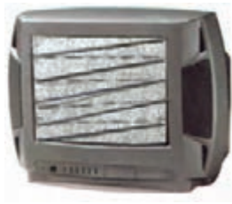
شکل ۱۱۰-۱ خطوط برگشت رویت می شود.
