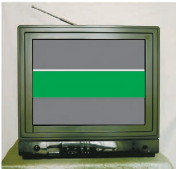
شکل ۲-۱۱۶- تصویر تلویزیون وقتی C518 قطع است.
