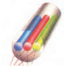
شکل ۹۳-۱- سیستم تولید اشعه In Line
