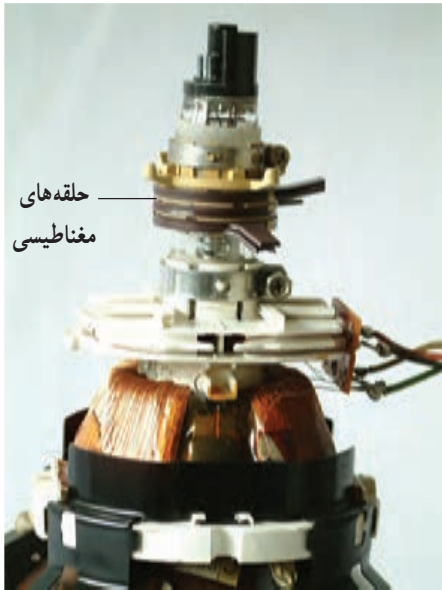
شکل ۹۸-۱- حلقه های مغناطیسی روی گردن لامپ
