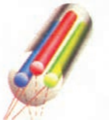
شکل ۹۴-۱- سیستم تولید اشعه \Delta
