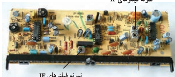
شکل ۱۶۵-۲- نمونه فیلترهای IF که نباید هسته‌ی آن‌ها تغییر داده شود.
