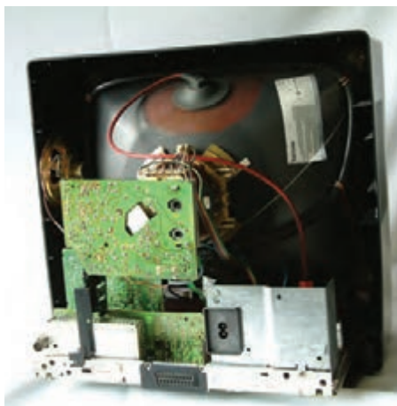
شکل ۱۹-۲- تلویزیون بدون قاب پشت
