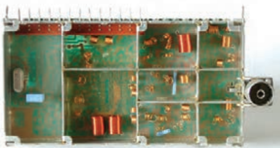
شکل ۲-۳۷- قطعات تیونر
