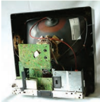
شکل ۱۶۶-۲- تلویزیون بدون قاب پشت
