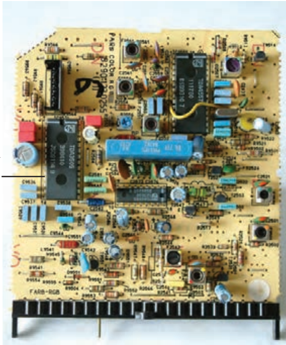
شکل ۴-۱۳۰- محل نصب آی‌سی ۹۵۳۱
