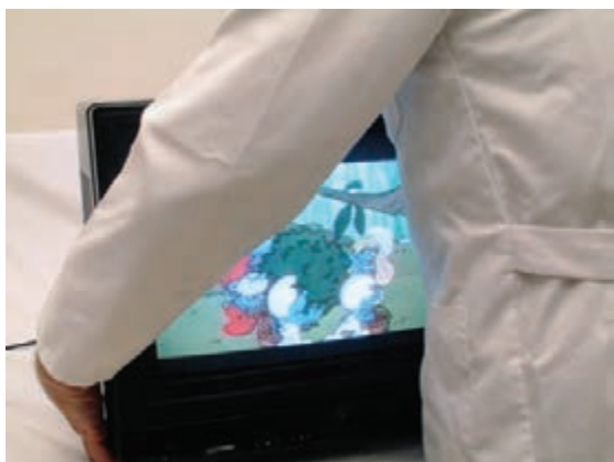
شکل ۴-۳۲- جابه‌جا کردن تلویزیون روشن صحیح نیست.
