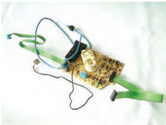
شکل ۱۷۹-۴ سیم ۷ رشته‌ای متصل به بُرد سوکت لامپ تصویر
