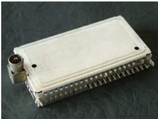
شکل ۲-۲۶-۲ تیونر و پایه‌های آن
