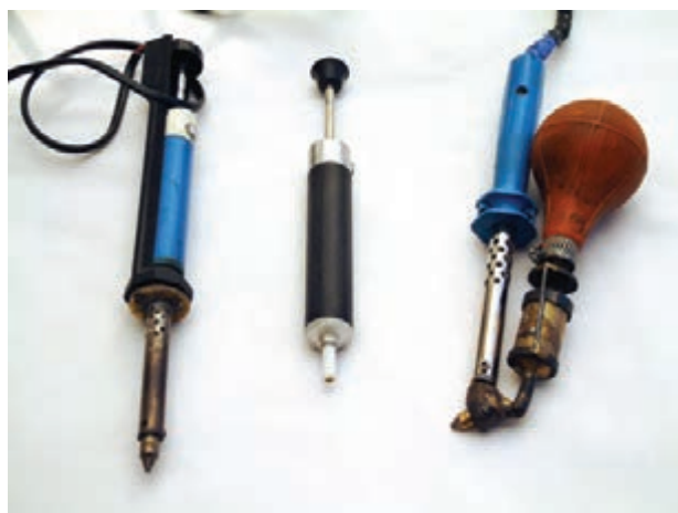
شکل ۴-۷۹- قلع کش حرارتی و پیستونی
