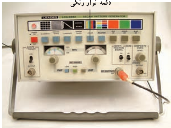
شکل ۲-۱۷۳- دگمه نوار رنگی روی پترن ژنراتور
