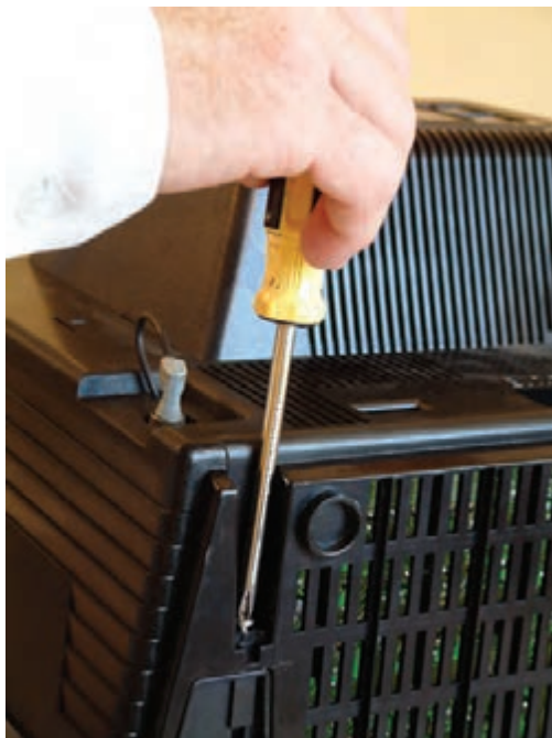
شکل ۲-۴۲- نحوه‌ی باز کردن قاب پشت تلویزیون
