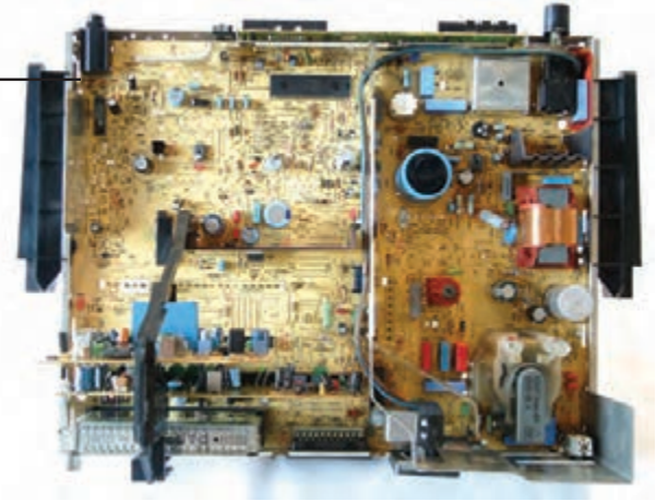
شکل ۳-۲۶ محل نصب آی سی ۳۶۵ در برد اصلی
