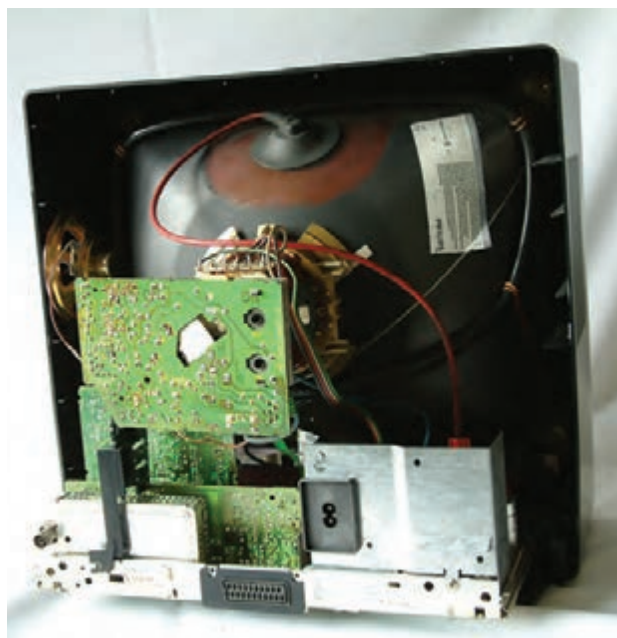
شکل ۴-۳۵- تلویزیون بدون قاب پشت
