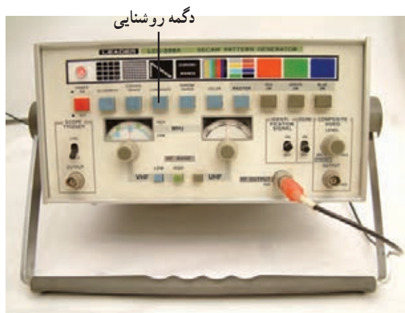
شکل ۲-۱۷۱ دگمه Luminun در روی پترن ژنراتور
