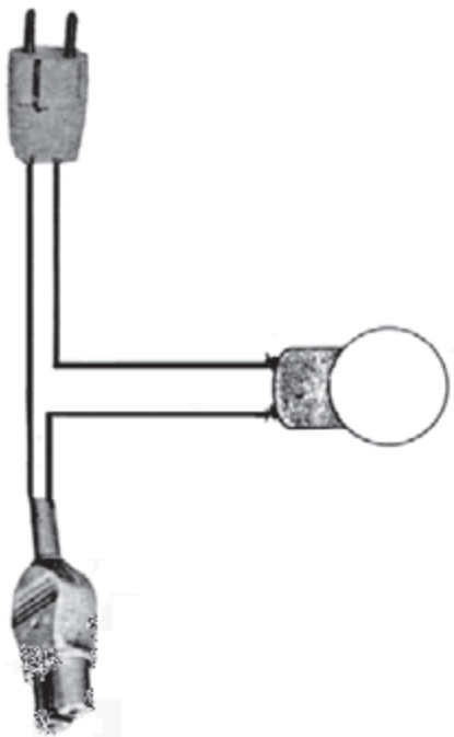
شکل ۱۴۴-۱ پریز سری با لامپ جهت حفاظت در مقابل اتصال کوتاه
