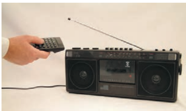
شکل ۳-۴۸- تست کنترل از راه دور توسط رادیو
