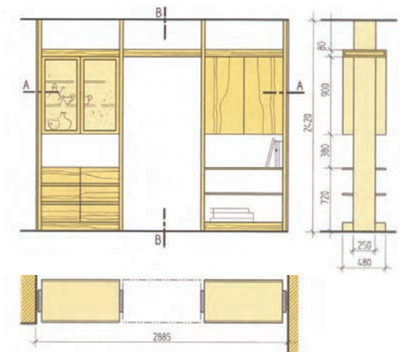
شکل (۳-۹۱) ترسیم نقشه پلان و نماهای پارتیشن با در برای رفت و آمد به فضای مجاور
