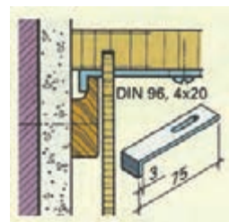
شکل (۴-۴۹) یراق برای آویزان کردن کابینت دیواری با فلز لبه کونیاپی و شکاف پیچ نشان داده شده است.
