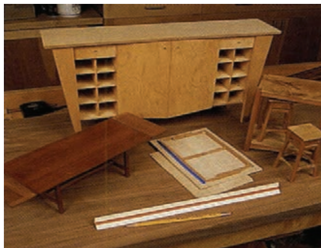
شکل (۳-۶۳) نمونه مدل‌های ساخته شده به منظور رفع اشکالات برای ساخت نمونه اصلی
