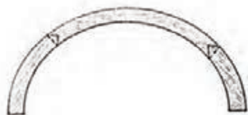
شکل (۳-۱۳۴) اتصال طولی قطعات قوس دار
