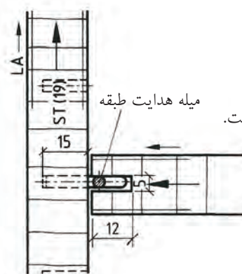
شکل (۴-۵۲) رسم یراق اتصال طبقه کابینت به وسیله زیر سری مفتول زبانه خم در تصویر مجسم و برش پیشانی و برش عمودی کنشکاف وار مفتول در انتهای عرض طبقه بسته است.
