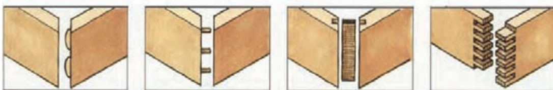
شکل (۵-۴۷) اتصال گوشه‌ای تصویر مجسم اتصالات انگشتی، قلیف زبانه جدا، دویل و بیسکویتی
