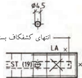
شکل (۴-۴۹) یراق برای آویزان کردن کابینت دیواری با فلز لبه کونیاپی و شکاف پیچ نشان داده شده است.
