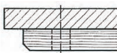
شکل (۴-۲۷) ترسیم هاشور راه چوب و سرچوب ماسیو پیچ شده
