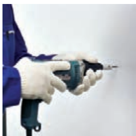
برای نصب پانل ها از پیچ مخصوص استفاده می شود نحوه صحیح در دست گرفتن پیچ گوشتی برقی
