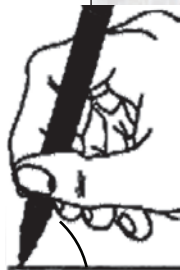
شکل ۳-۱۳ زاویه‌ی قلم کمتر از ۸۰ درجه نباشد.
