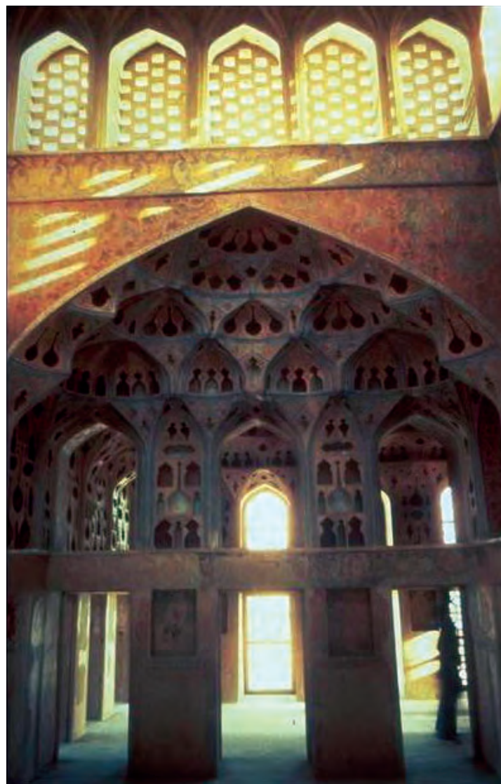
تصویر ۲-۸ - نور از طریق پنجره‌های مشبک آجری و یا گلولی به داخل تابیده می‌شود
