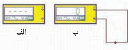
شکل ۲-۷۹ - آزمایش اطمینان از سلامت اهم متر
