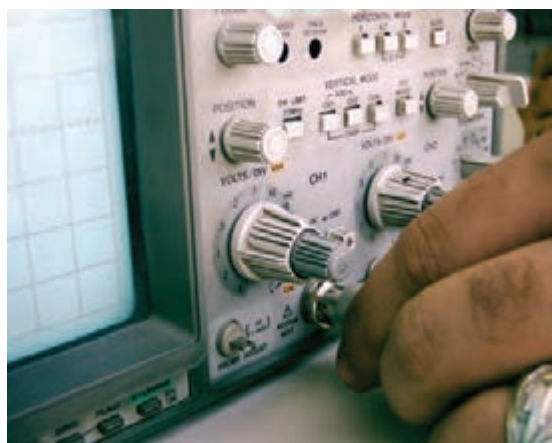
شکل ۱۱۴-۲ نحوه‌ی اتصال BNC به اسیلوسکوپ
