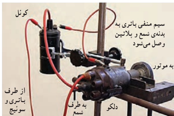
شکل ۲-۱۴۴- مدار شبیه‌سازی شده‌ی سیستم جرقه‌زنی
