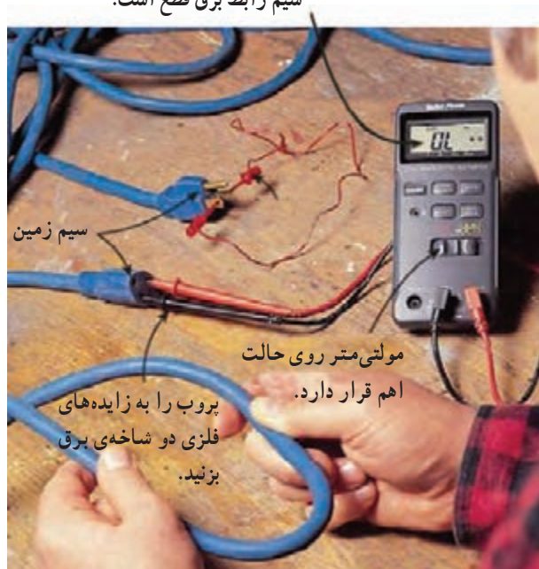
شکل ۲-۸۰ - آزمایش سیم رابط برق دستگاه.
