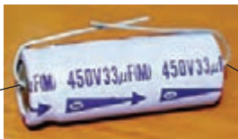
الف - توجه به قطب‌های خازن الکترولیتی
