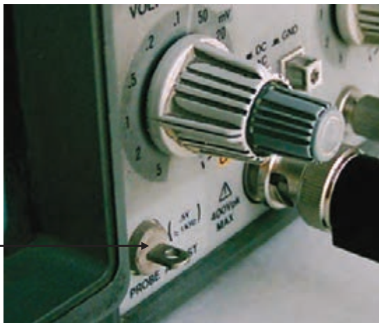
شکل ۱۱۶-۲- این ترمینال روی اسیلوسکوپ قرار دارد و سیگنال مربعی با دامنه‌ی ۵/۰ تا یک ولت و فرکانس یک کیلوهرتز تولید می‌کند.
