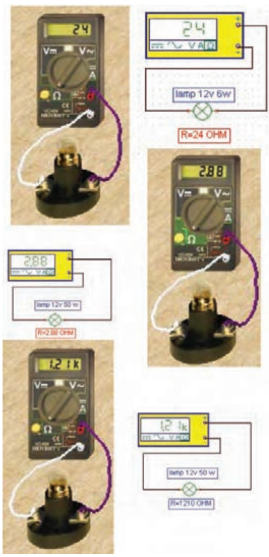
شکل ۸۹-۲- اندازه گیری مقاومت لامپ‌های روشنایی
