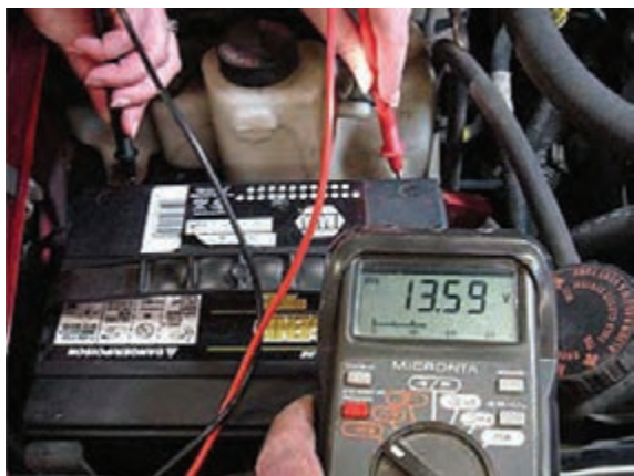
شکل ۵۰-۱ اندازه‌گیری ولتاژ با ولت‌متر دیجیتال
