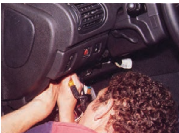
شکل ۲-۹۵- آزمایش برقراری جریان الکتریکی مدار
