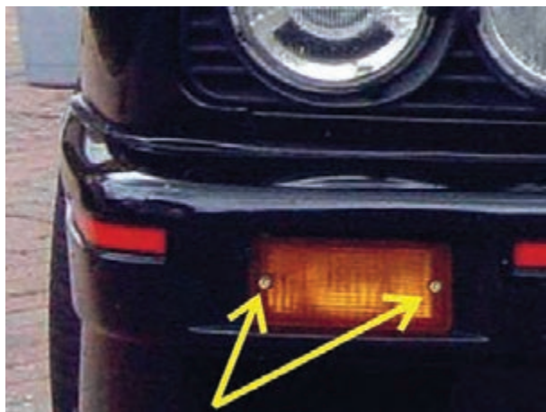
شکل ۱-۵۰ پیچ‌های اتصال تلق چراغ راهنما
