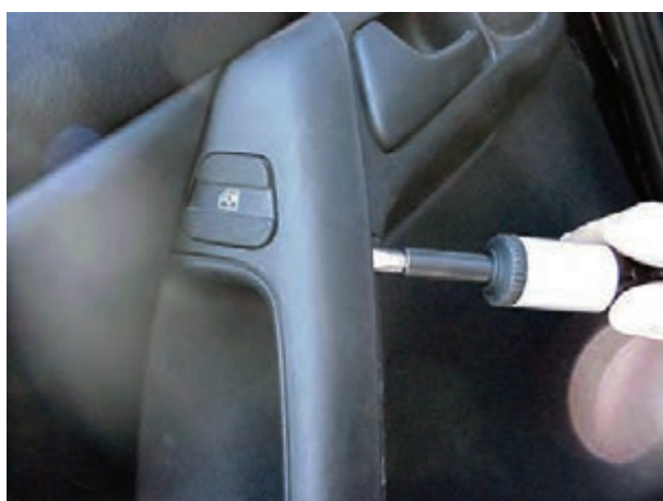
شکل ۲-۱۱۰- جدا کردن قاب سوئیچ شیشه بالابر
