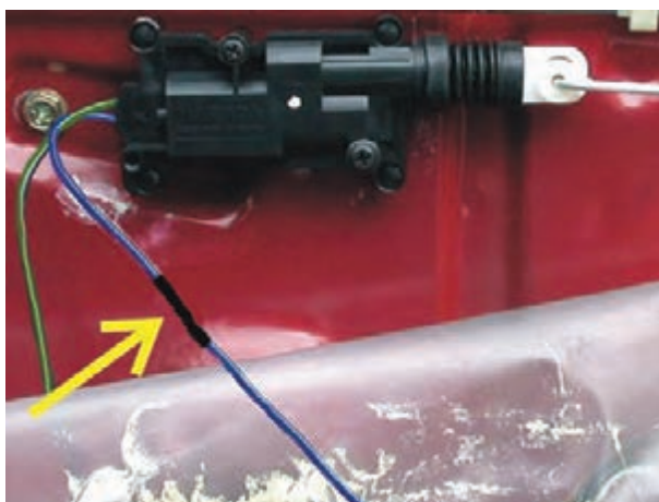
شکل ۴۹-۲- عایق کاری محل اتصال سیم‌ها به یکدیگر
