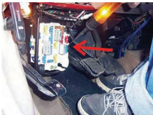
شکل ۱۸۹-۲- آزمایش پایه‌های فیوز
