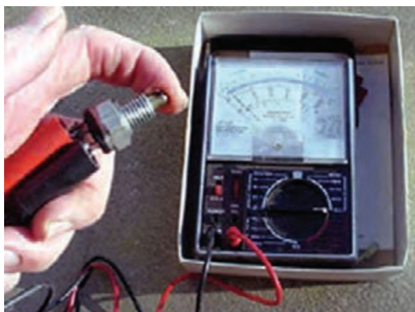
شکل ۱۰۵-۱- آزمایش سوئیچ چراغ‌های دنده عقب
