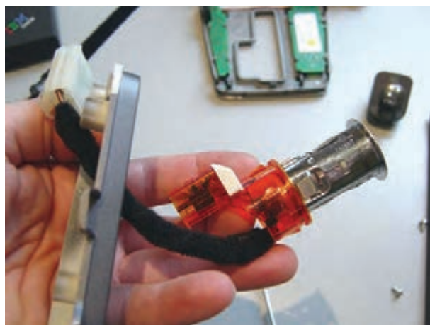
شکل ۱-۲۳۴- خارج کردن سیم و سوکت اتصال الکتریکی فنکد از داخل قاب روی پانل
