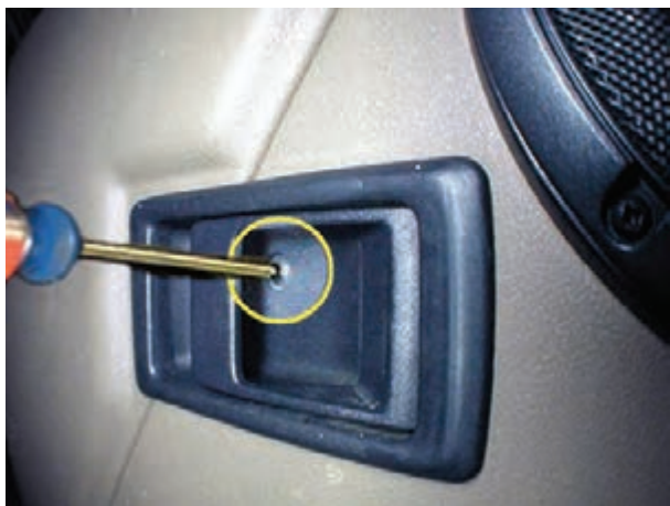
شکل ۲-۳۶- باز کردن قاب دستگیره‌ی قفل در
