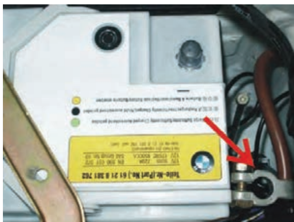
شکل ۲-۱۰۹- باز کردن اتصال منفی باتری
