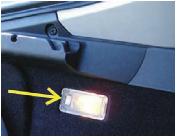
شکل ۲۱۸-۱- چراغ صندوق عقب و سوئیچ روی آن
