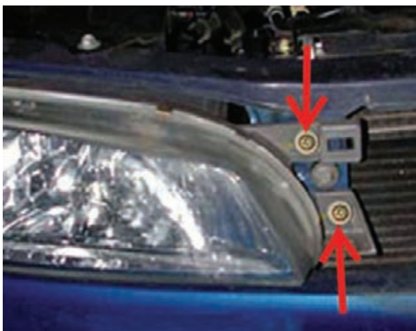
شکل ۱-۴۰- پیچ‌های نگه‌دارنده‌ی چراغ‌های بزرگ جلو
