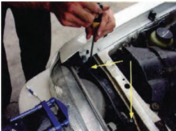
شکل ۱۶۷-۱- پیچ‌های تنظیم چراغ بزرگ جلو
