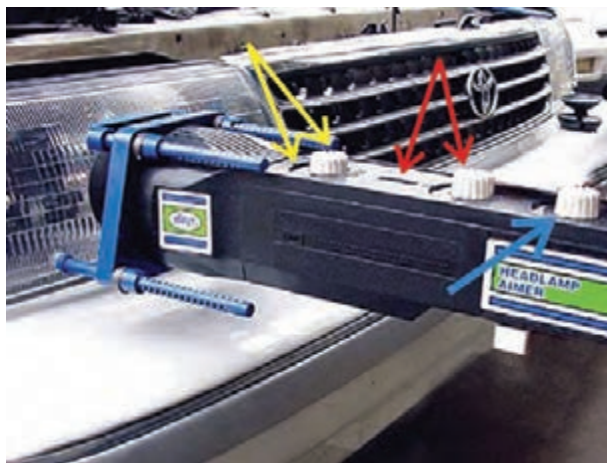
شکل ۱۶۱-۱- پیچ‌های تنظیم دستگاه تنظیم نور چراغ‌ها
