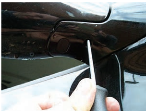
شکل ۱۷۶-۲- بازکردن پیچ روی پایه ی بیرونی آینه
