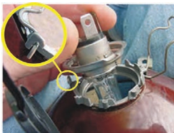
شکل ۱-۴۳- نحوه‌ی ثابت شدن لامپ درون کاسه‌ی چراغ
