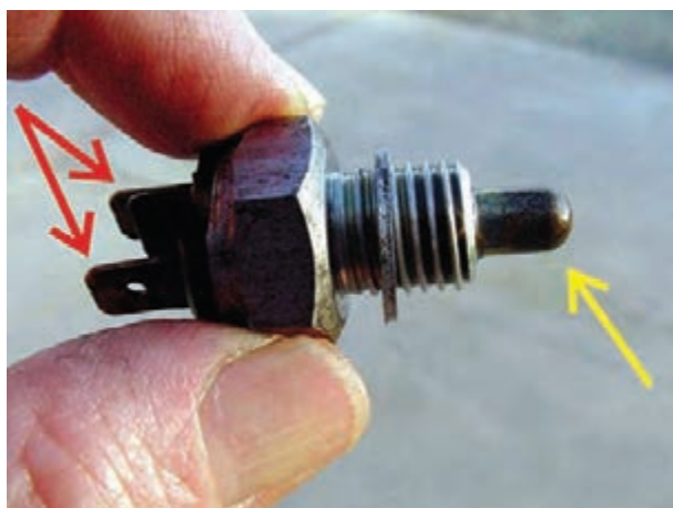
شکل ۱۰۴- پلانجر و ترمینال‌های سوئیچ دنده عقب
