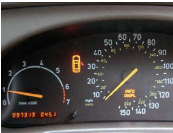
شکل ۲۱۳-۱- چراغ اخطار بازبودن درهای خودرو
