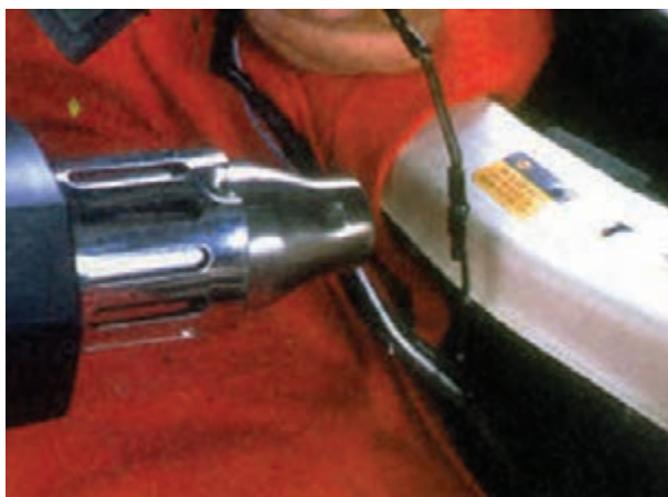
شکل ۱-۱۵۰- عایق کاری محل اتصال سیم ها
