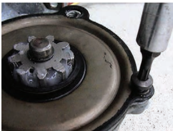
شکل ۱۳۱-۲- بستن پیچ های درپوش به بدنه
