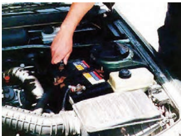
شکل ۱۶۴-۲ بازکردن کابل اتصال بدنه‌ی باتری
