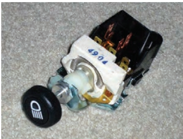
شکل ۱-۷۱- سوئیچ چراغ‌های روشنایی نوع چرخشی
