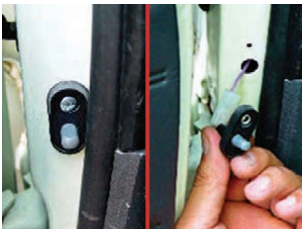
شکل ۱۹۲-۱- باز کردن سوئیچ لای در
