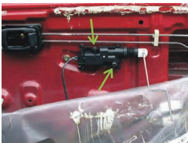
شکل ۲-۲۹ اتصال عملگر الکتریکی در روی در خودرو
