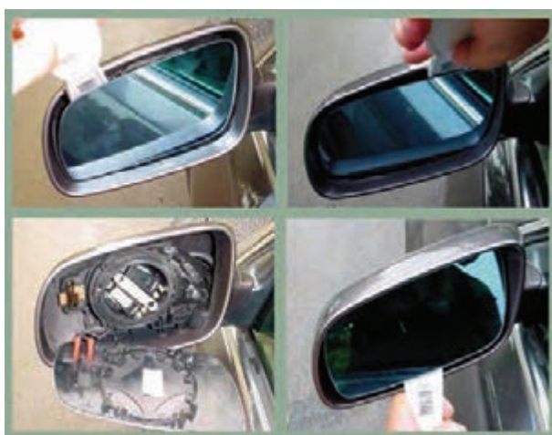
شکل ۱۶۷-۲- بیرون آوردن آینه از داخل قاب آن
