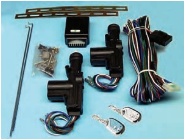
شکل ۱-۲- اجزای مدار قفل مرکزی
