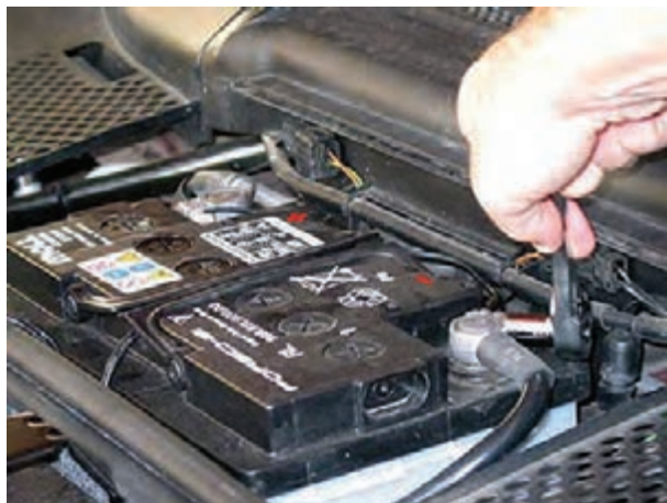
شکل ۲-۳۳- باز کردن اتصال بدنه‌ی باتری
