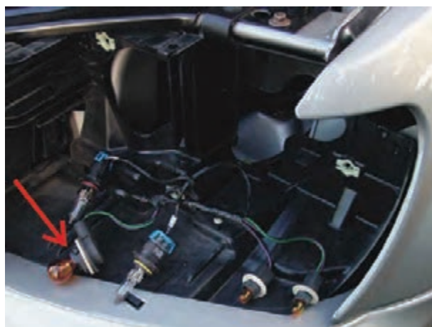
شکل ۱-۵۱ لامپ چراغ‌های روشنایی در یک نوع خودرو
