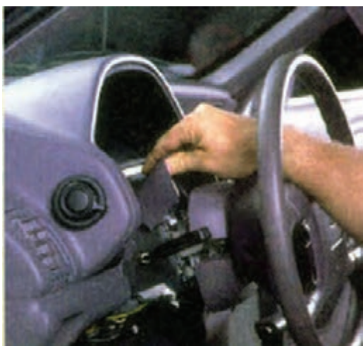
شکل ۹۱-۱- بیرون آوردن قاب سوئیچ روشنایی
