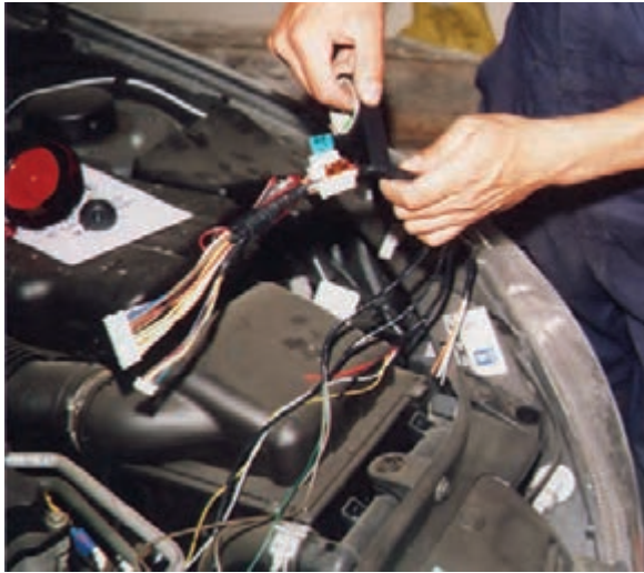
شکل ۲-۷۷- نحوه‌ی عایق‌بندی سیم‌های مدار الکتریکی دزدگیر
