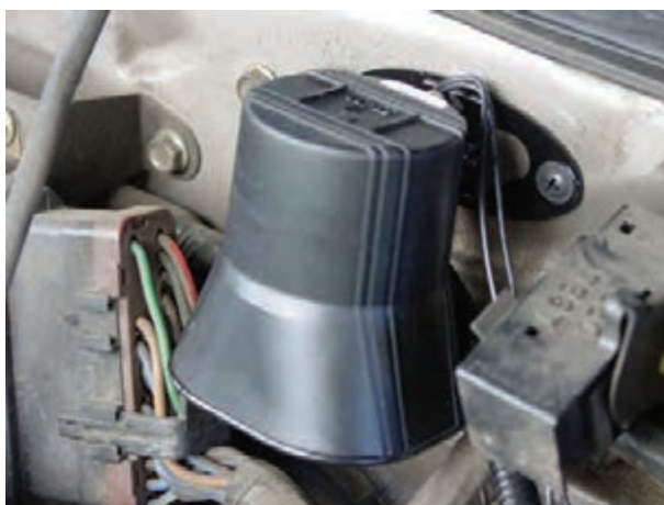
شکل ۵۸-۲- یک نوع آژیر سیستم دزدگیر خودرو
