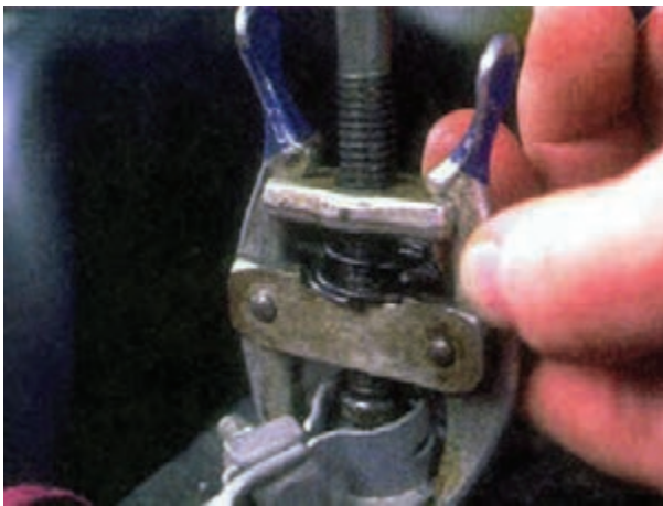
شکل ۱-۸۹- باز کردن بست اتصال بدنه‌ی باتری
