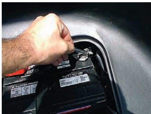
شکل ۱-۵۲ باز کردن بست ترمینال منفی باتری
