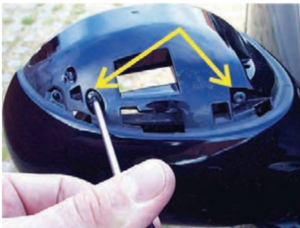
شکل ۱۷۴-۲- باز کردن پیچ‌های قاب بیرونی آینه
