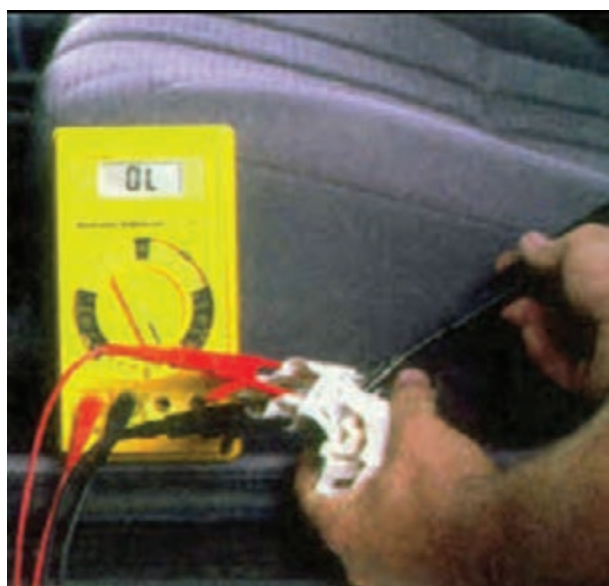
شکل ۱-۹۸- آزمایش حالت استپ موقت دسته ی راهنما
