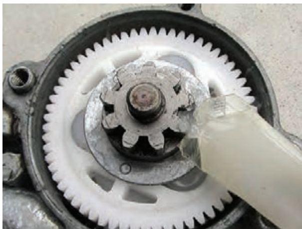
شکل ۱۳۰-۲- روغن کاری چرخ دنده ها
