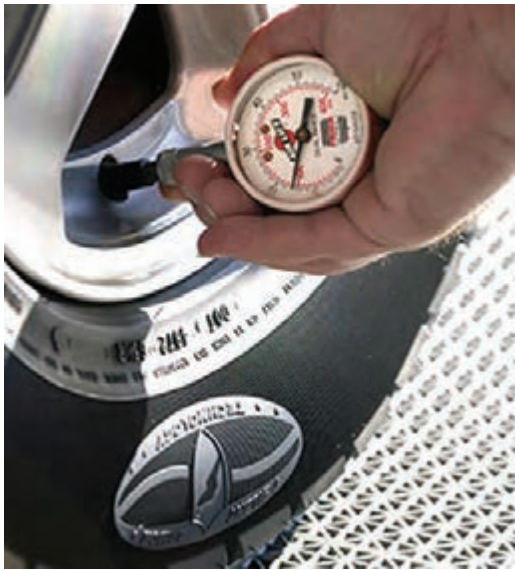
شکل ۱۵۸-۱- کنترل فشار باد تایر
