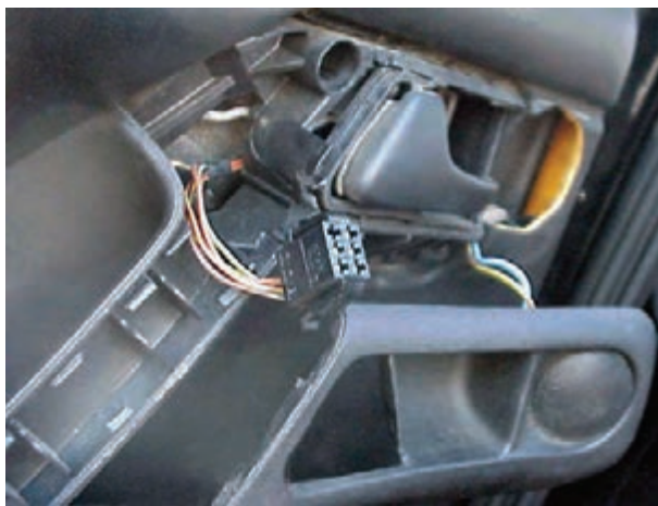
شکل ۲-۱۱۲- جدا کردن قاب روی اهرم قفل دستی در
