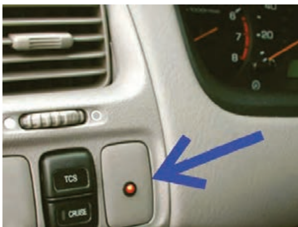
شکل ۲-۶۶ – محل نصب دیود نوری (LED) در یک نوع خودرو
