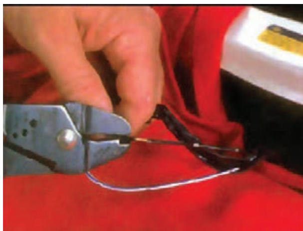
شکل ۱۴۶-۱- استفاده از انبر مخصوص برای قطع سیم
