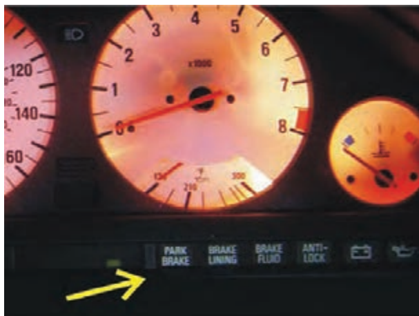
شکل ۲۰۵-۱- چراغ‌های اخطار سیستم ترمز
