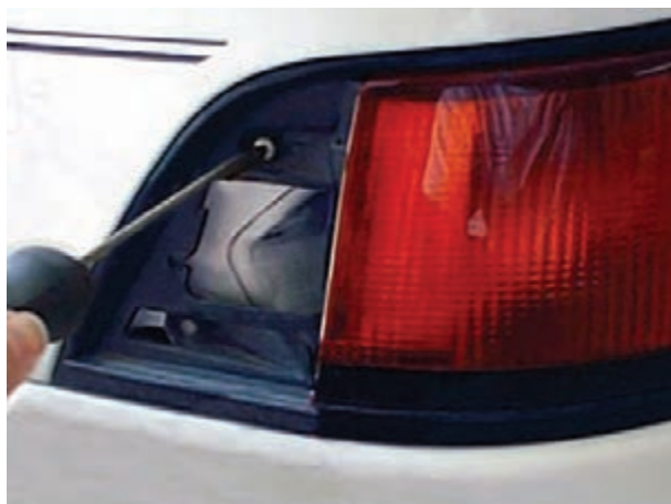
شکل ۱-۵۶- باز کردن پیچ‌های قاب چراغ
