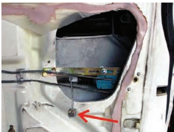
شکل ۲-۳۸- باز کردن بست فلزی از روی میله‌ی قفل کن دستی
