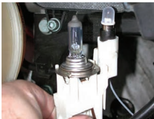
شکل ۱-۴۹ - پایه‌ی مشترک لامپ‌های چراغ روشنایی و پارک
