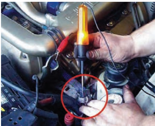
شکل ۱-۱۴۵- آزمایش برقراری جریان مدار چراغ‌های روشنایی
