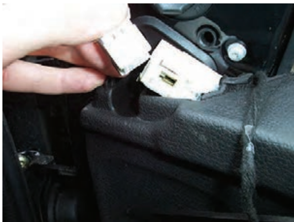
شکل ۱۶۶-۲- جدا کردن سوکت سیم کشی آینه
