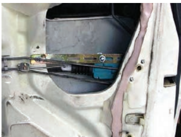
شکل ۲-۳۷- نحوه‌ی اتصال عملگر الکتریکی
