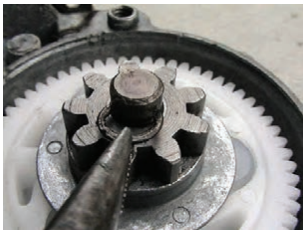
شکل ۱۲۹-۲ جانداختن خار فنری
