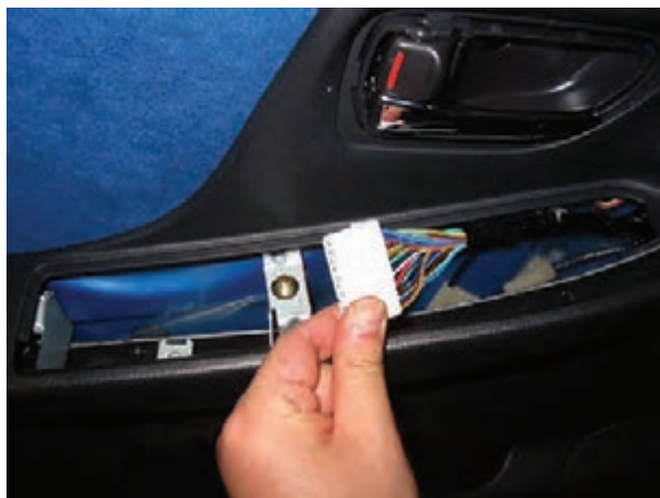
شکل ۱۸۵-۲- سوکت اتصال دسته سیم به سوئیچ‌ها
