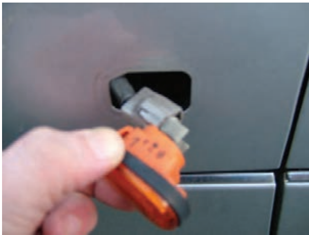
شکل ۱-۶۷- خارج کردن چراغ راهنمای بغل از محل خود در روی بدنه‌ی خودرو
