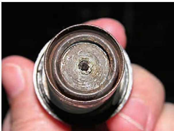
شکل ۱-۲۲۵- المنت حرارتی داخل سوئیچ فشاری
