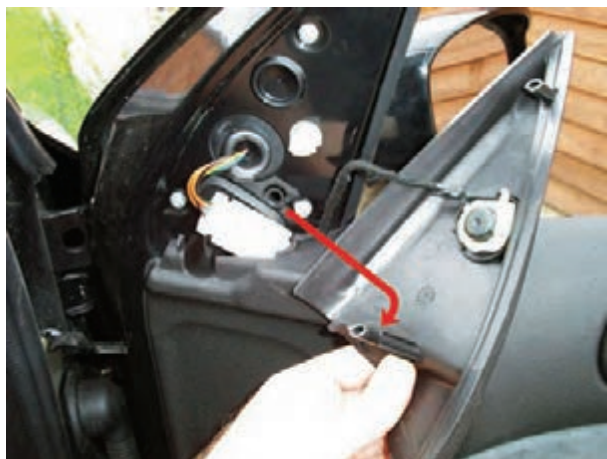
شکل ۱۶۵-۲ خارهای روی قاب و محل نصب آن
