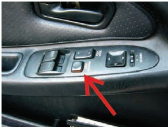
شکل ۱۳۷-۲- سوئیچ قفل کن سیستم شیشه بالابر
