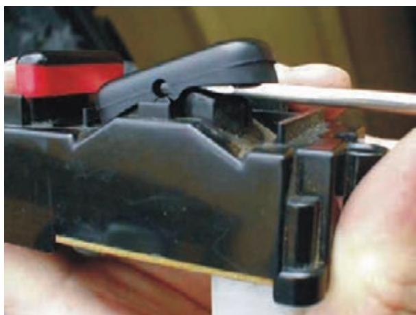
شکل ۲-۱۴۵- تعویض شستی معیوب
