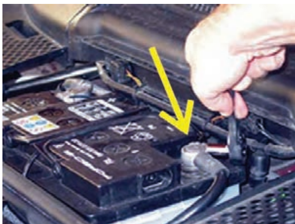
شکل ۱۴۱-۲- باز کردن کابل اتصال بدنه‌ی باتری
