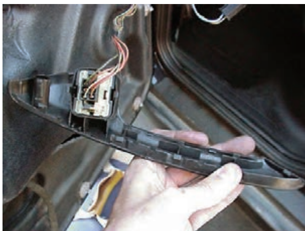
شکل ۱۱۸-۲- اتصال سوکت سوئیچ شیشه بالابر
