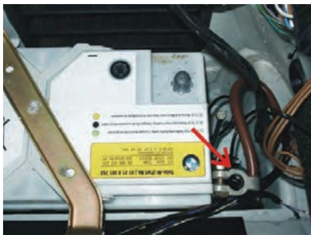
شکل ۳۵-۱- جدا کردن بست اتصال کابل بدنه‌ی باتری
