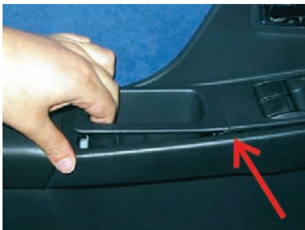
شکل ۱۸۳-۲- خارج نمودن قاب سوئیچ‌ها
