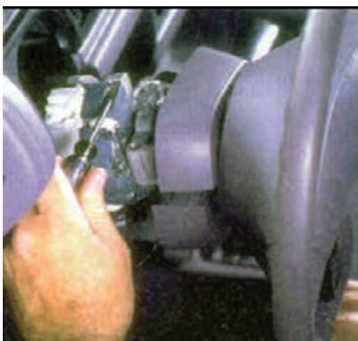
شکل ۹۵-۱- باز کردن پیچ بدنه‌ی سوئیچ روشنایی
