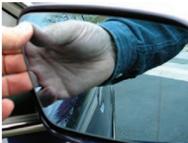
شکل ۱۶۹-۲- خارج کردن شیشه‌ی آینه از داخل قاب بیرونی
