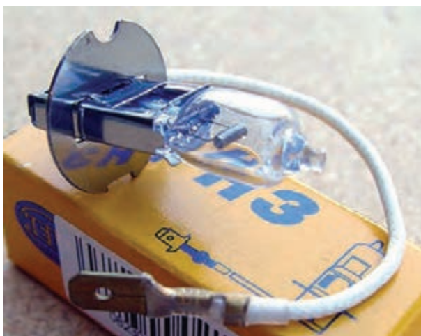
شکل ۱-۳۱- لامپ مورد استفاده در چراغ‌های مه‌شکن، نورافکن‌ها
