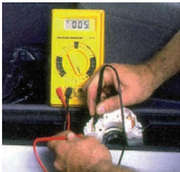
شکل ۱-۹۷- آزمایش سوئیچ روشنایی
