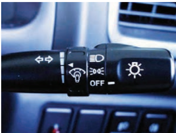
شکل ۱-۷۲- سوئیچ چراغ‌های روشنایی (طرح دسته‌ی راهنما)
