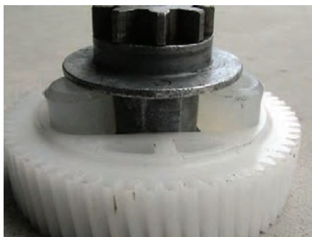
شکل ۱۲۸-۲ سوار کردن چرخ دنده‌ی فلزی
