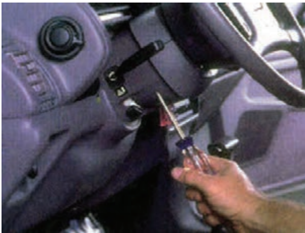
شکل ۱-۹۰- باز کردن پیچ‌های قاب سوئیچ روشنایی
