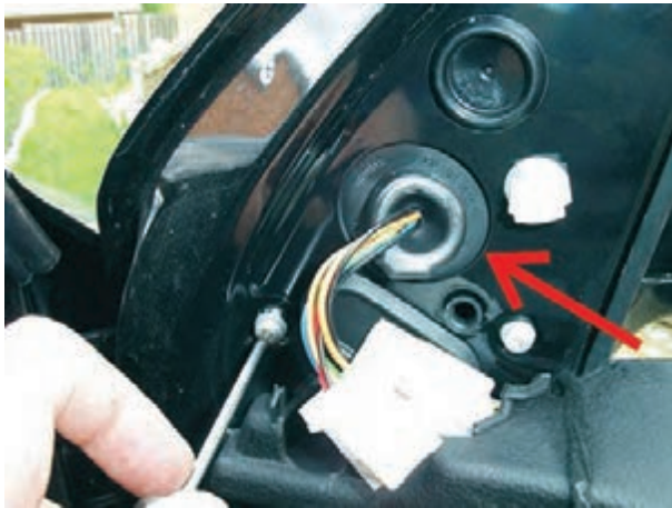
شکل ۱۷۸-۲- باز کردن پیچ نگه‌دارنده‌ی پایه‌ی اصلی آئینه
