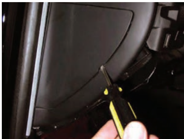
شکل ۱۱۸-۱- آزاد کردن خار پوشش محافظه‌ی جعبه‌ی فیوز
