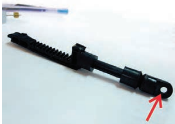
شکل ۱۸-۲- شانه‌ی دندانه‌دار دو قسمتی (محور عملگر)
