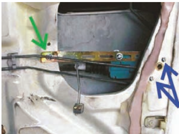
شکل ۳۹-۲- باز کردن پیچ‌های اتصال عملگر الکتریکی
