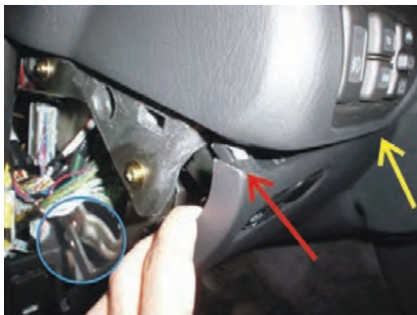
شکل ۱-۸۵- خارج کردن قاب از روی بدنه‌ی پانل
