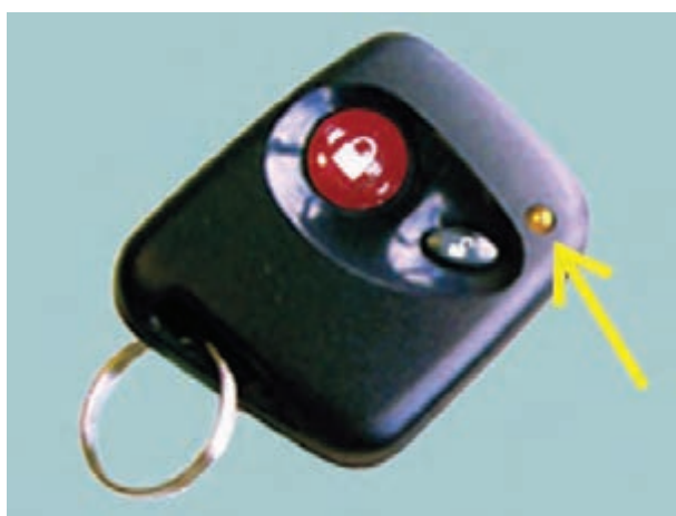
شکل ۲-۷- دیود نوری روی قاب ریموت کنترل
