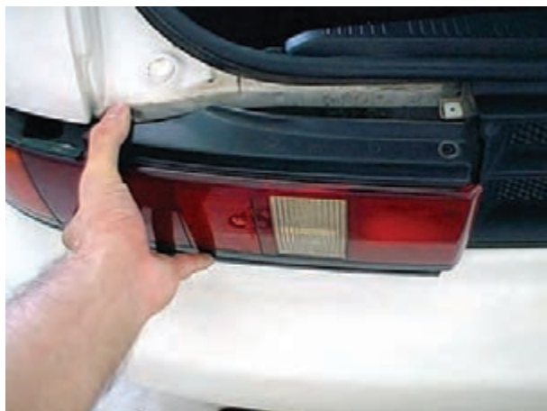
شکل ۱-۵۸- جدا کردن چراغ عقب از بدنه‌ی خودرو
