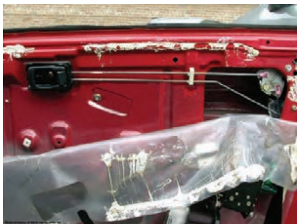
شکل ۲-۲۶- جدا کردن پلاستیک محافظ روی در
