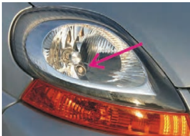
شکل ۱-۲۲- چراغ جانبی (پارک) تعبیه شده در داخل کاسه‌ی چراغ جلو در یک نوع خودرو
