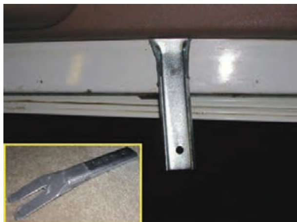
شکل ۲-۳۵- اهرم خاردرآر و نحوه‌ی استفاده از آن
