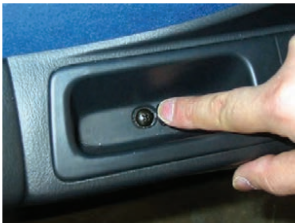
شکل ۱۸۲-۲- پیچ اتصال قاب سوئیچ به بدنه
