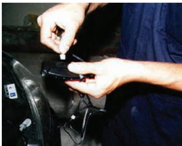
الف – اتصال سوکت سیم‌کشی به چشمی الکترونیک
