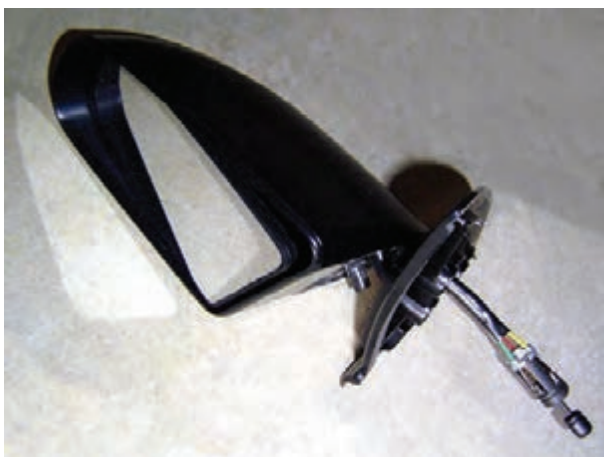
شکل ۱۵۶-۲- آینه‌ی جانبی و مکانیزم حرکت آن
