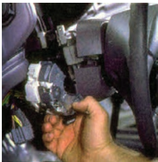
شکل ۹۶-۱- خارج کردن سوئیچ روشنایی از محل خود
