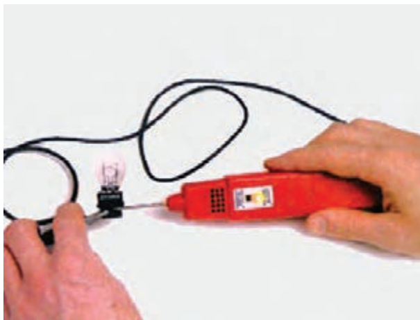
شکل ۲۱۹-۱- آزمایش لامپ چراغ صندوق عقب خودرو
