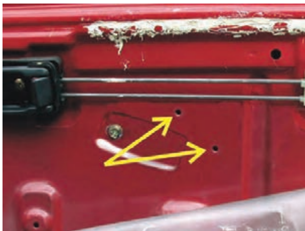
شکل ۲-۲۷ سوراخ کاری بدنه‌ی داخلی در خودرو
