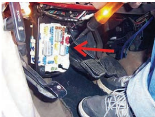
شکل ۱۲۰-۱- آزمایش جعبه‌ی فیوز با چراغ آزمایش
