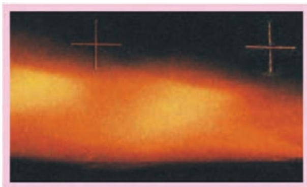
شکل ۱۷۰-۱ تنظیم نبودن نور چراغ‌ها
