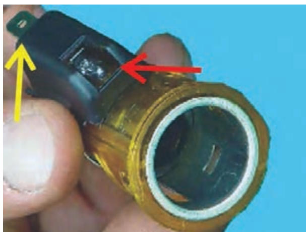
شکل ۱-۲۲۴- لامپ فندک و ترمینال الکتریکی آن
