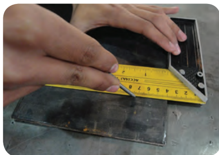
رعایت زاویای تمایل سوزن خط‌کش
