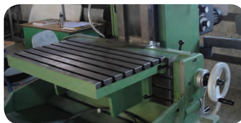
میز ماشین فرز و سیستم حرکتی آن
