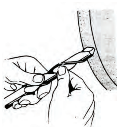
تیز کردن مته با دست و سنگ دو طرفه
