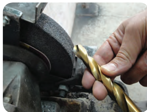
تیز کردن مته با دست و سنگ دو طرفه
