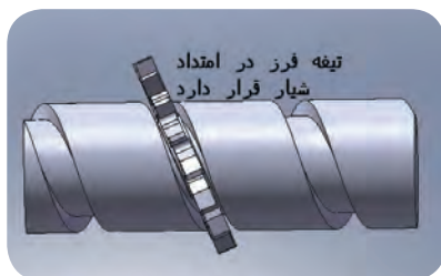
موقعیت اولیه قرارگیری تیغه فرز نسبت به قطعه کار قبل از فرزکاری
