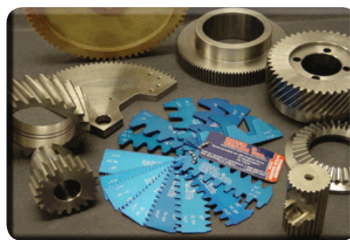
استفاده از شابلن در کنترل دندهی چرخ دنده
