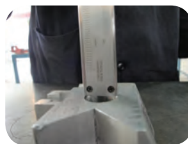
کنترل عمق سوراخ با استفاده از کولیس
