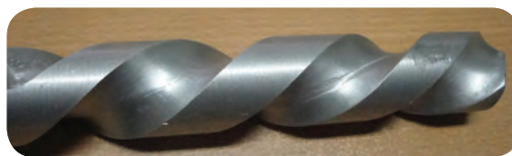
ایجاد شیار مارپیچ در یک میله گرد
