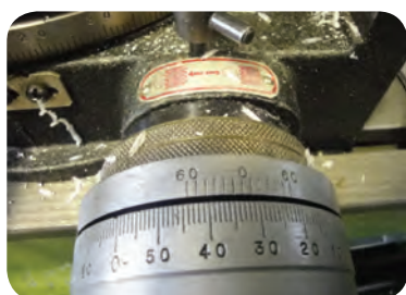
حلقه مدرج دستگیره میزگردان برای جابجایی دقیق‌تر
