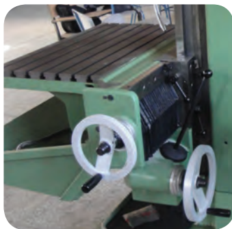
مکانیزم جابجایی میز ماشین
