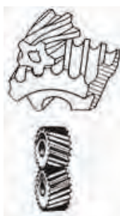
درگیری دو چرخ‌دنده مارپیچی
