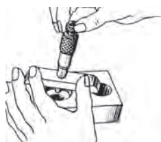
کنترل عمق سوراخ با استفاده از میکرومتر
