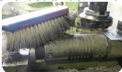
استفاده از قلم مو یا فرچه مویی برای دور کردن براده
