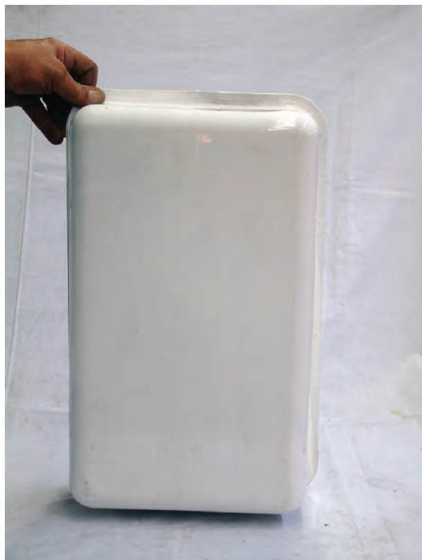
شکل ۱-۲۹- مخزن سوخت آب گرمکن نفت سوز
