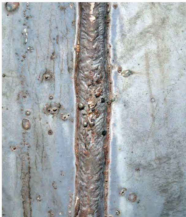
شکل ۱-۷- درز جوشکاری شده
