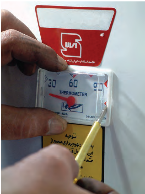
شکل ۱۱۶-۱- جدا کردن ترمومتر
