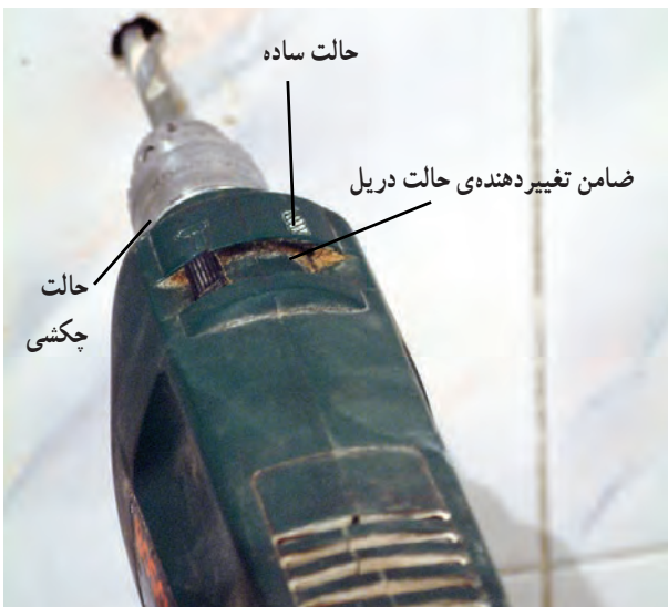
شکل ۲۱۲-۳ سوراخ کردن محل علامت‌گذاری شده
