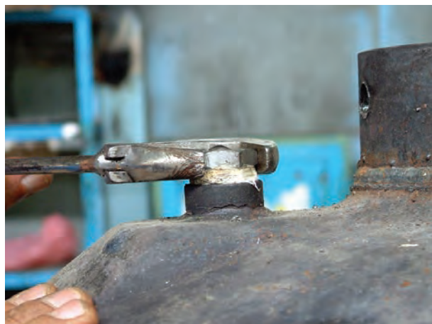
شکل ۱-۲۴- نحوه‌ی بازکردن میله‌ی منیزیم از محل خود
