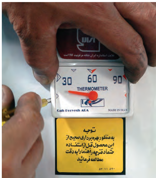
شکل ۱۱۷-۱ جدا کردن ترمومتر از روپوش
