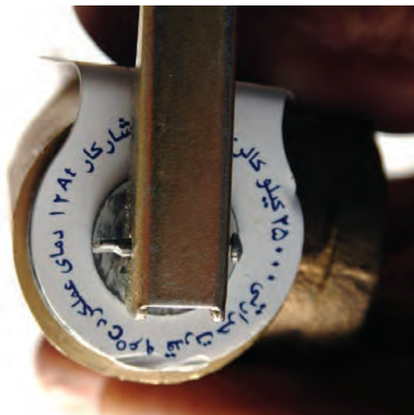
شکل ۲-۱۰۸- شیر اطمینان فشاری و حرارتی
