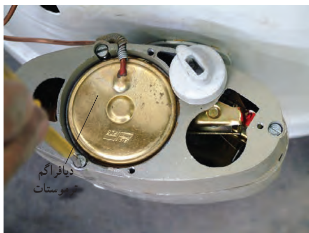
شکل ۵۵-۱- ب - دیافراگم ترموستات
