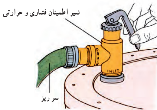
شکل ۲-۱۰۹- شیر اطمینان فشاری - حرارتی
