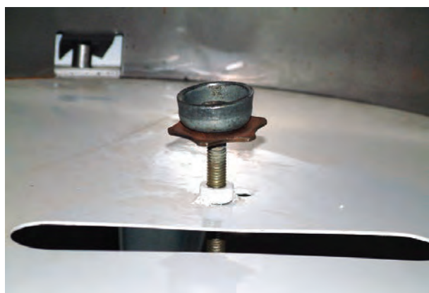
شکل ۹-۱- جک نصب شده بر روی شاسی
