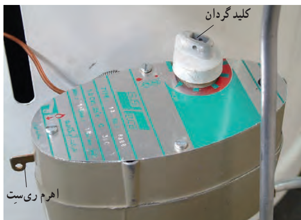
شکل ۱-۳۸- کاربرد اتور آب گرمکن نفت سوز
