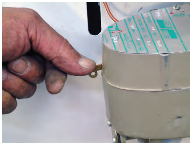
شکل ۱-۴۴ با فشار اهرم ری سرت به سمت پایین، نفت از مخزن سوخت به کاربراتور می‌رود.
