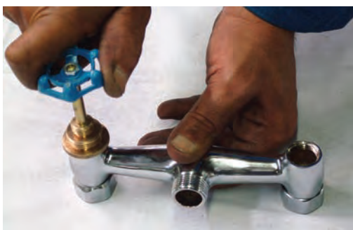
شکل ۲-۶۸- شیر تراش در حال کار شیر تراش
