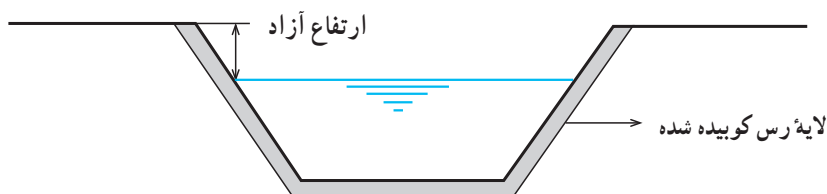
شکل ۱۶-۲- مقطع یک کانال با پوشش خاک رس
