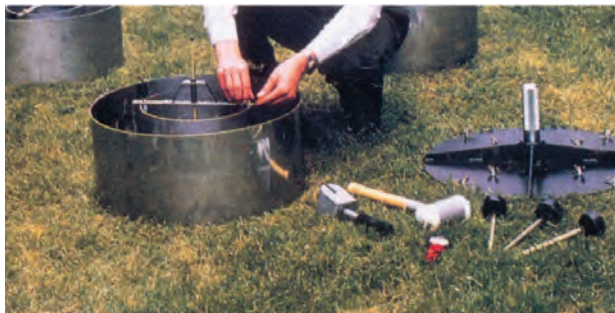
شکل ۳-۱ نحوه کار گذاشتن استوانه مضاعف
