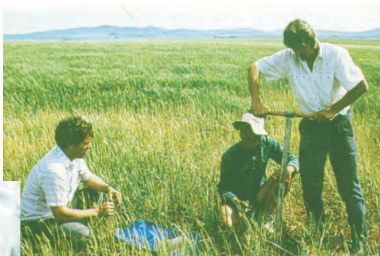
شکل ۱۳-۱ نحوه کار با اوگر
