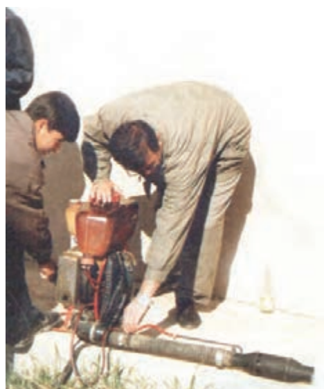
شکل ۲۵-۳- آماده سازی و روشن کردن شعله افکن
