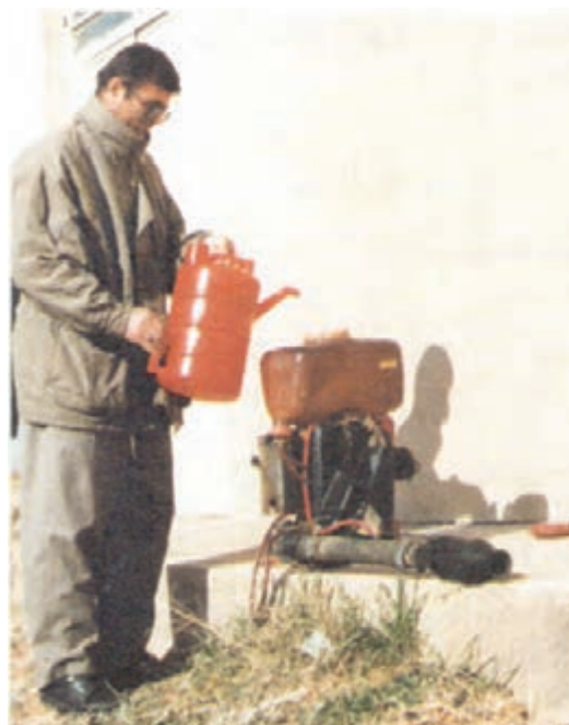
شکل ۲۴-۳- پر کردن مخزن شعله افکن
