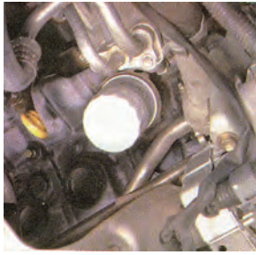
شکل (۲-۶۰) کنترل فیلتر از نظر نشتی
