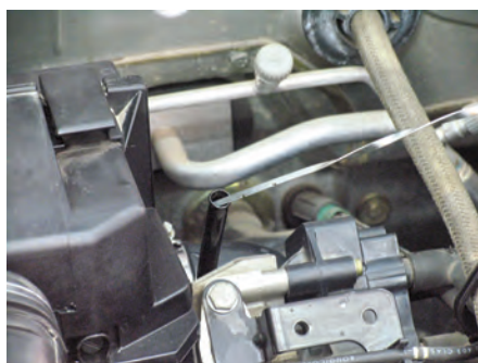
شکل (۲-۵۹) کنترل روغن
