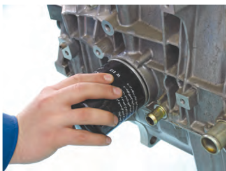
شکل (۲-۵۴) نصب و محکم کردن فیلتر
