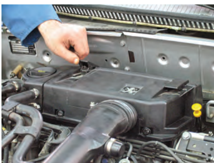
شکل (۲-۶۳) بازکردن در هواکش
