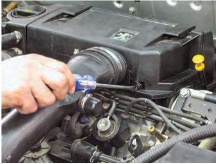
شکل (۲-۶۵) نصب در پوش محافظه فیلتر هوا
