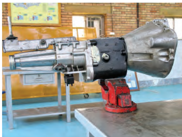
شکل ۱۶۳- جعبه دنده خودروی محرک عقب
