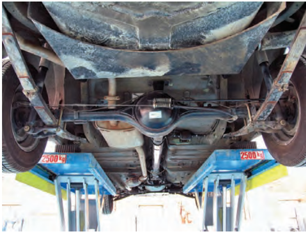
شکل ۳۱۵- دیفرانسیل در خودرو محرک عقب
