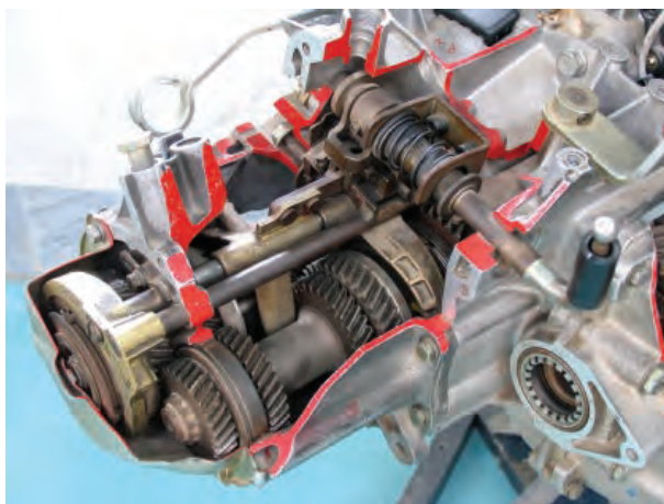
شکل ۱۶۲- جعبه دنده خودروی محرک جلو
