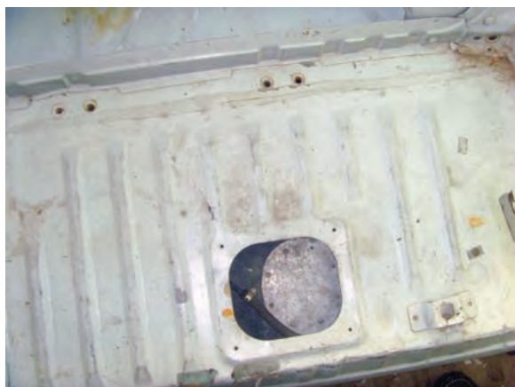
شکل ۱-۲۳ مخزن سوخت از داخل صندوق عقب
