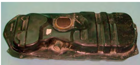
شکل ۱-۲۶ مخزن سوخت آماده نصب
