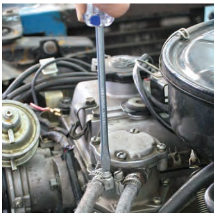
شکل ۱-۴۴-ب: نصب لوله‌ها
