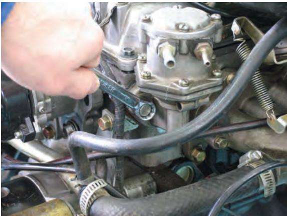
شکل ۴۲-۱ پیاده کردن پمپ
