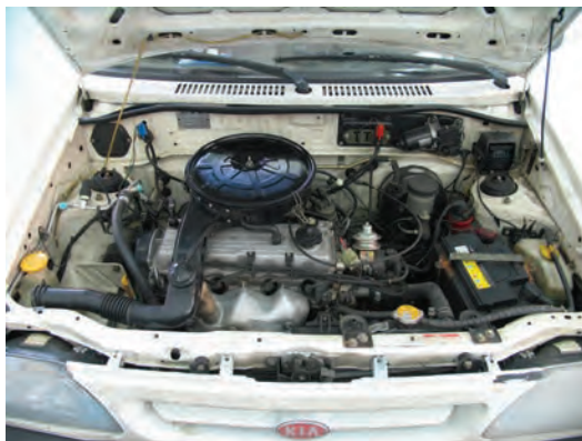
شکل ۹۹-۱ خودرو با سیستم سوخت‌رسانی کاربراتوری
