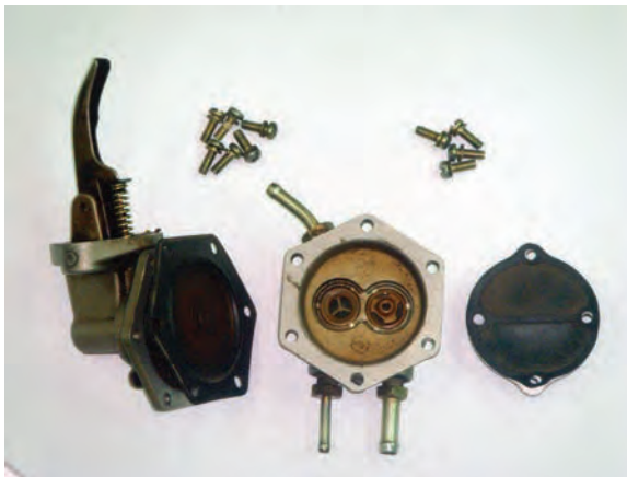
شکل ۴۳-۱ اجزای پمپ سوخت
