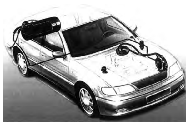
شکل ۱-۱۴ سیستم سوخت‌رسانی گاز خودرو
