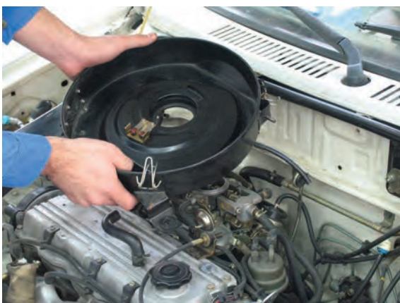
شکل ۱۱۴- ۱ پیاده کردن مجموعه هواکش
