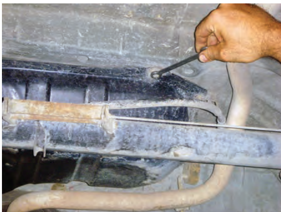
شکل ۱-۲۵ باز کردن پیچهای دور باک
