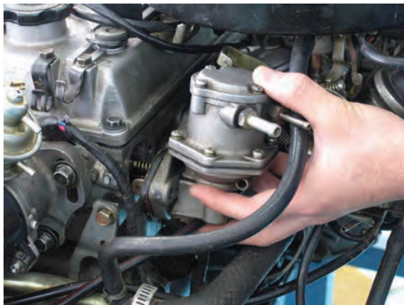
شکل ۴۴-۱ الف: نصب پمپ
