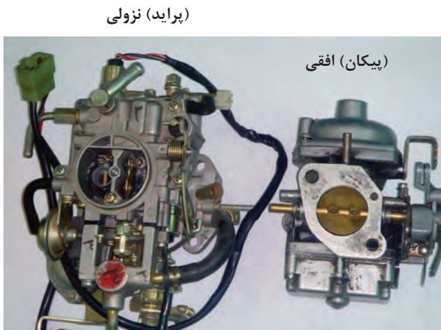
شکل ۱-۶۴ کاربراتورها از نظر حرکت سوخت (نزولی - افقی)
