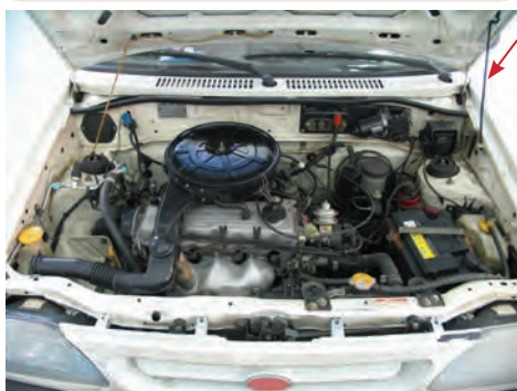
شکل ۱۱۹- ۱ نصب صحیح اهرم نگه‌دارنده درپوش موتور خودرو
