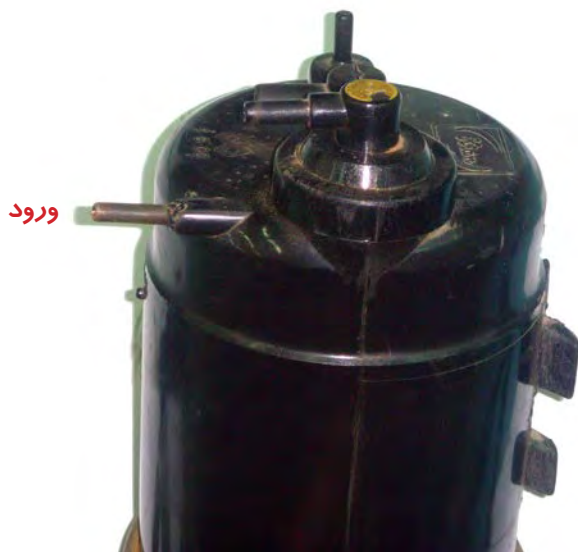
شکل ۱-۹۶ شیر ورودی سوخت‌های تبخیر شده به کنیستر
