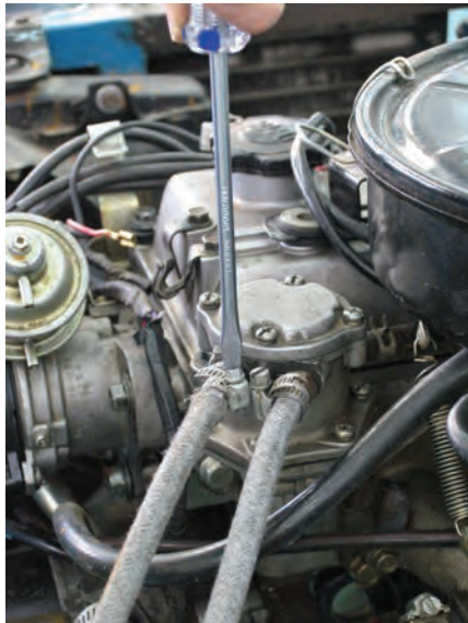
شکل ۱-۳۲ اتصال لوله سوخت به پمپ
