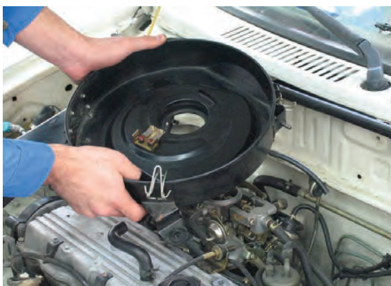
شکل ۱۰۰-۱ پیاده کردن مجموعه هواکش
