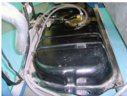
شکل ۱-۲۷ مخزن نصب شده و آماده سوخت گیری
