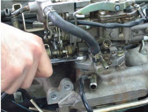
شکل ۱-۱۱۰ باز کردن پیچ‌های اتصال کاربراتور به موتور
