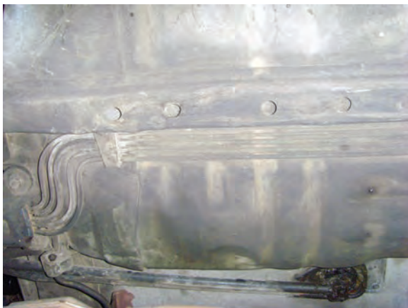
شکل ۱-۳۳ لوله سوخت از مخزن تا پمپ
