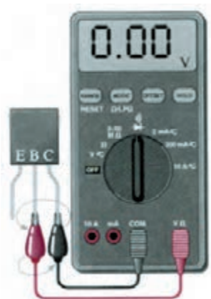
شکل ۵۰-۱۲ ترانزیستور معیوب (اتصال کوتاه)
