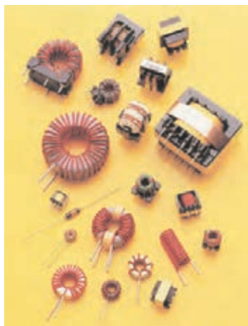
شکل ۸-۱۲ چند نمونه سلف کوچک
