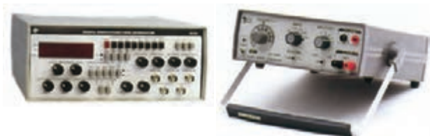
الف - سیگنال ژنراتور ب - فانکشن ژنراتور
