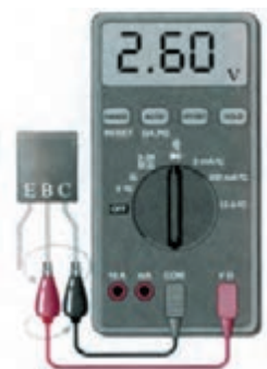
شکل ۴۹-۱۲ ترانزیستور معیوب (قطع)
