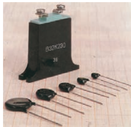
شکل ۱۴-۲ شکل ظاهری واریستور و نماد آن
