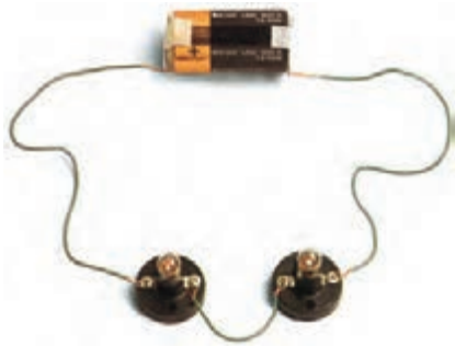
شکل ۲-۲۹ مدار واقعی دو لامپ به صورت سری
