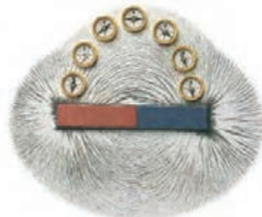
شکل ۳-۸ اثر میدان مغناطیسی روی قطب نما و براده‌های آهن
