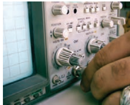
شکل ۶-۶ نحوه‌ی اتصال BNC به اسیلوسکوپ
