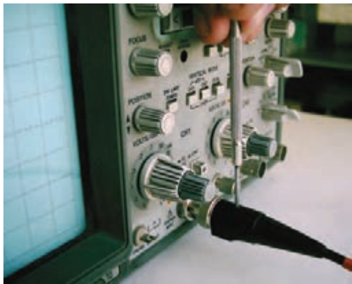
شکل ۸-۶ نحوه‌ی تنظیم پروب
