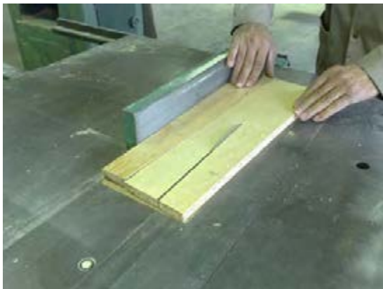
شکل ۱۲-۱۳. برش پایه‌ها با اره گرد مفصوص MDF.
