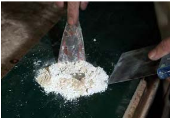
شکل ۴-۱۴. پگه‌نگی کار کردن با کاردک و لیسه.
