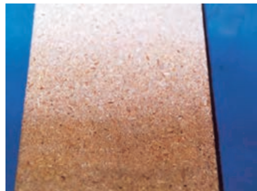
شکل ۴-۲- سطوح تخته فرده چوب، به دلیل خلل و فرج بسیار و شکل ظاهری بد، باید به صورت سرتاسری بتونه شود.
