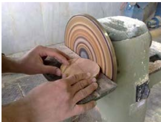
شکل ۱۹۱-۱۲. پرداخت قطعه چوب دایره شکل.
