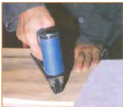
شکل ۵-۳۳. کار با دستگاه منگنه
