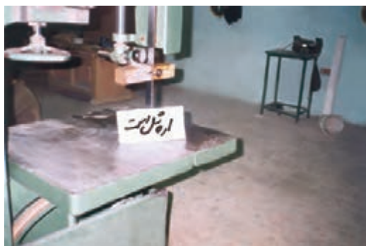
شکل ۹-۵- وقتی تیغه اره شل است، ممتماً از تابلوی مربوطه استفاده کنید.
