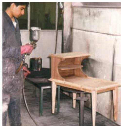
شکل ۲۴-۴. رنگ‌کاری با پیستوله (رنگ شفاف).
