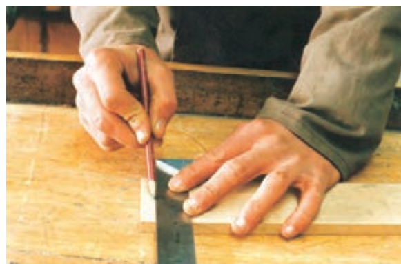
شکل ۹-۶۸- فم کشی ممل اتصال با گونیا.
