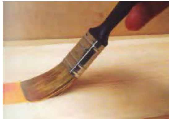
شکل ۴-۴۳- قلم مو را در جهت الیاف چوب بکشید.
