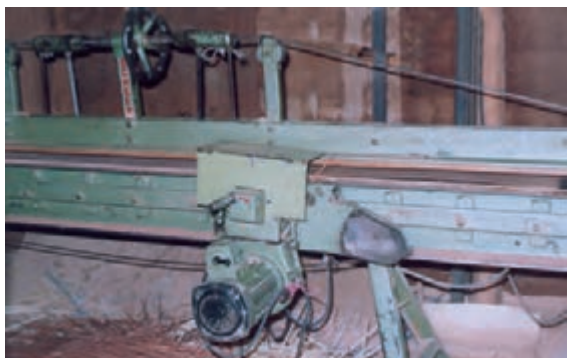
شکل ۵-۲۵- یک دستگاه درز کن (روکش).
