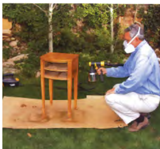
شکل ۲۳-۴. رنگ‌کاری با پیستوله (رنگ پوششی).
