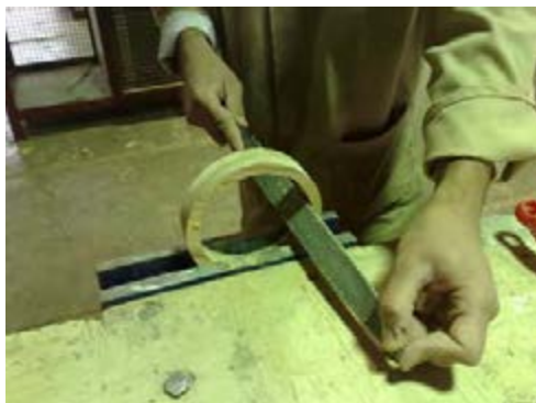
شکل ۱۹۳-۱۲. پرداخت ملقه‌ی چوبی.
