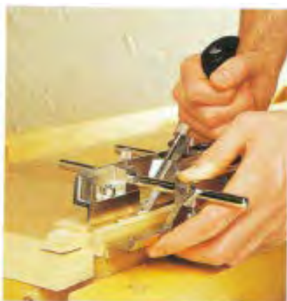
شکل ۱۰۰- شیار انداختن داخل قیده‌های عرضی.
