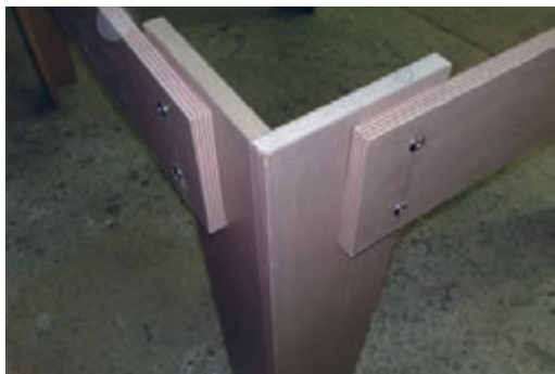
شکل ۱۲-۱۶- اتصال پایه به قید توسط پیچ فیکس.
