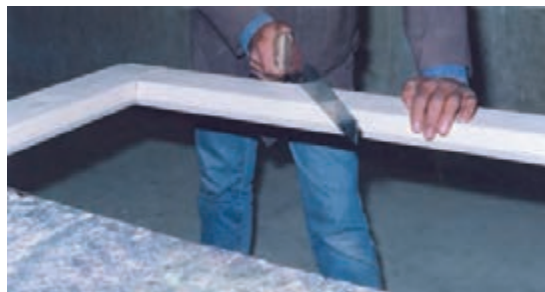
شکل ۱۱-۲۶- ایجاد شیار با اره‌ی دستی.
