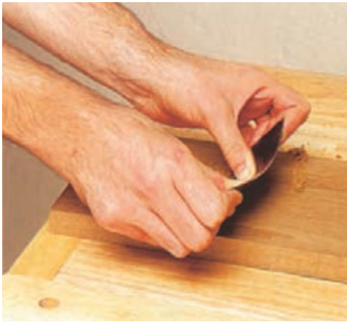
شکل ۲-۱۲. از فم کردن زیاد لیسه هنگام لیسه‌کاری مودداری شود.
