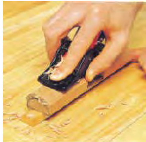
شکل ۲۶- نمونه ی پرداخت قطعه ای با مقطع نیم گرد.
