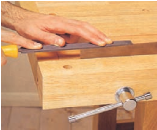
شکل ۲-۷- نمونه‌ی سوهان زدن ضخامت لیسه.
