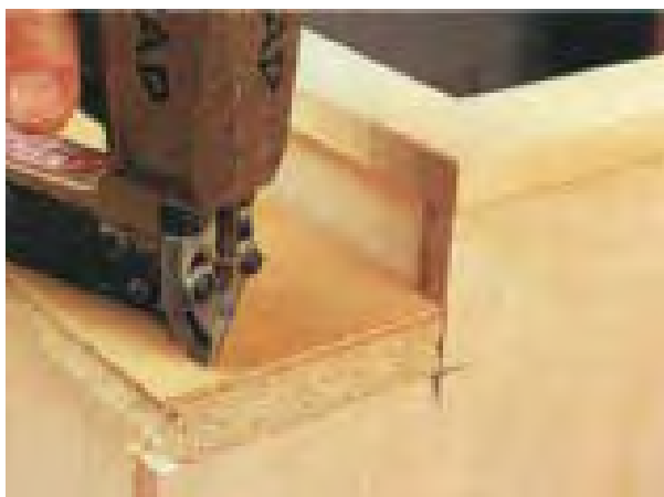
شکل ۸-۲۱- اتصال سه‌لایی به تخته خرده چوب.
