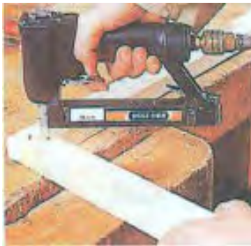
شکل ۸-۳- منگنه زدن گوشه های فارسی با منگنه زن بادی.
