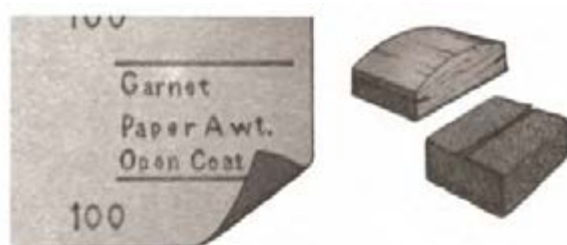
شکل ۷-۲۴- ورق سنباده استاندارد.
