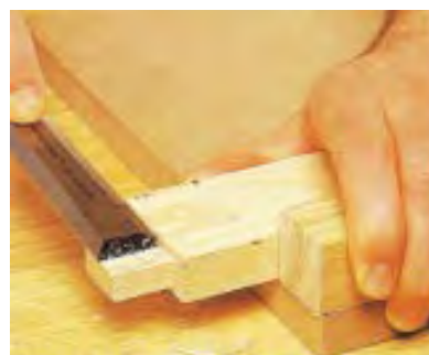
شکل ۹۸- اندازه کردن زبانه با مغار.
