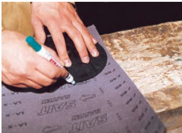
شکل ۷-۳۵- ترسیم گردی دیسک روی سنباده.
