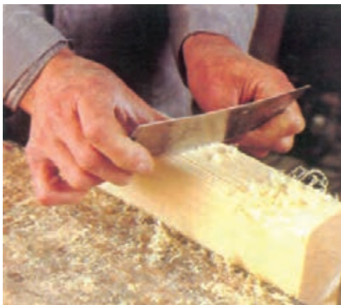
شکل ۲۹- برای لیس کاری، لیس را کمی خم کرده روی سطح چوب هدایت کنید.
