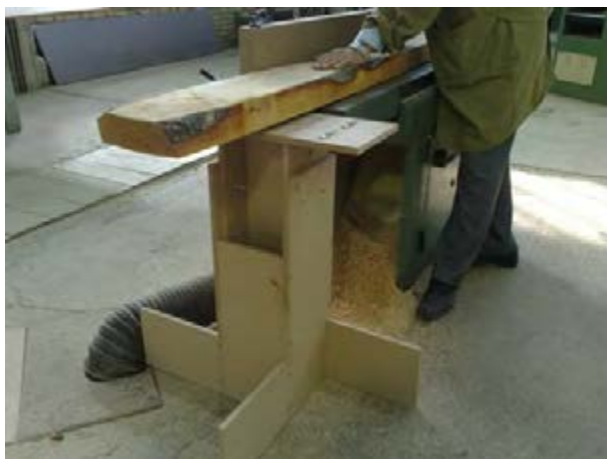
شکل ۹-۱۴- کاربرد میز کمکی برای ماشین کفرند.
