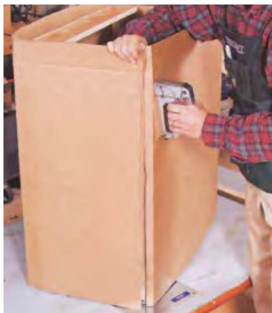
شکل ۸-۲۲- کاربرد منگنه‌ی دستی در بسته‌بندی کالاها.
