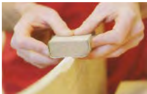
شکل ۳-۲۱. طریقه‌ی سنباده‌کاری نر قطعات با دو دست.
