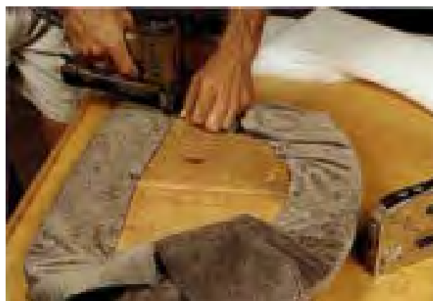
شکل ۸-۵. کاربرد منگنه در (ویه‌کوبی).
