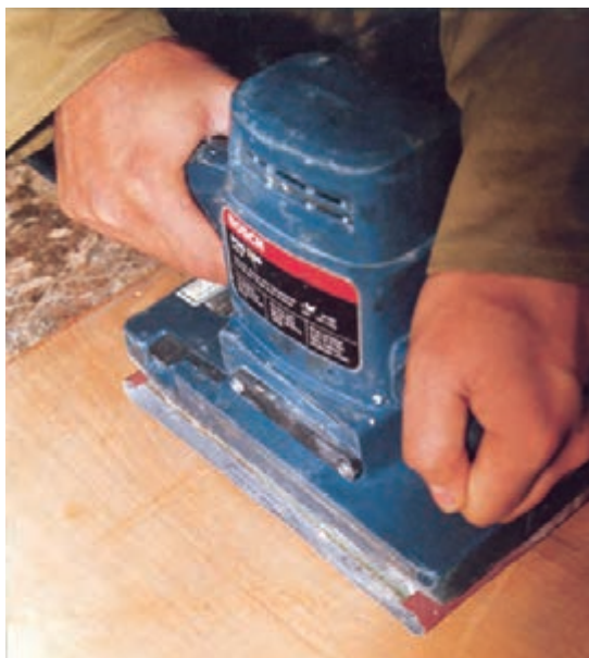
شکل ۷-۱۱. سنباده کاری در جهت الیاف.
