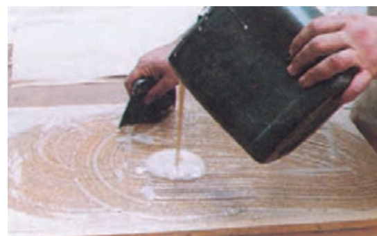
شکل ۴-۶- پفش کردن چسب به وسیله‌ی شانه‌ی چسب‌زنی.
