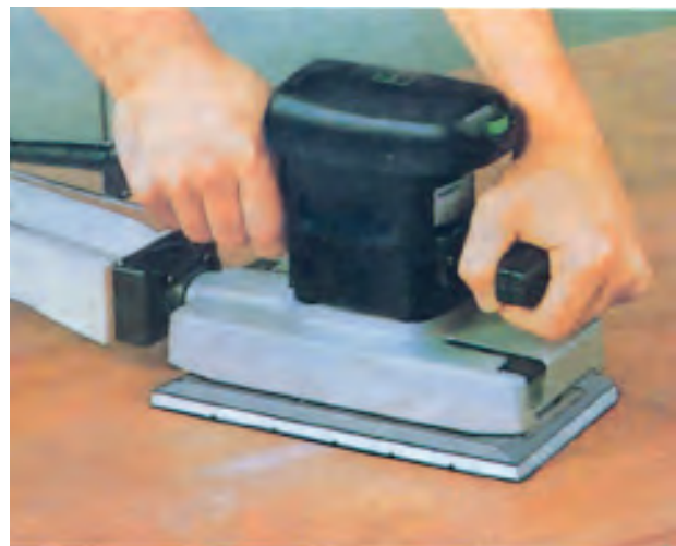
شکل ۳-۱۴- سنباده‌زنی با یک دستگاه سنباده لرزان کامل.
