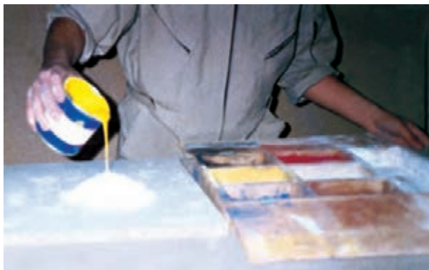
شکل ۴-۳- مواد تشکیل دهنده‌ی بتونه (روغنی).
