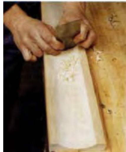
شکل ۲-۵- کاربرد لیسه با لبه‌ی نیم گرد.
