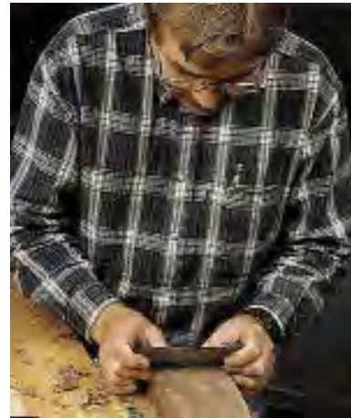
شکل ۲-۳۰. پرداخت سطوح قوس دار به وسیله لیسه.
