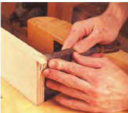
شکل ۵-۳۸- استفاده از کاتر، برای گرفتن روکش اضافی دو سر قطعه.
