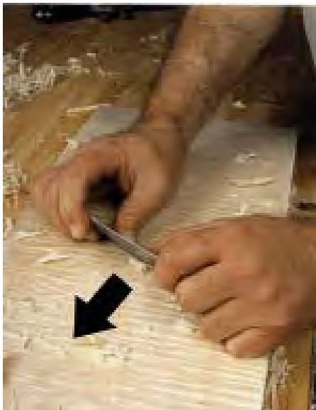
شکل ۲۸- نمونه ی گرفتن لیس با شست دست و هدایت آن.
