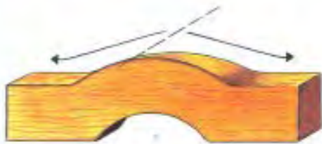
شکل ۲-۳۳. رندیدن در جهت الیاف.
