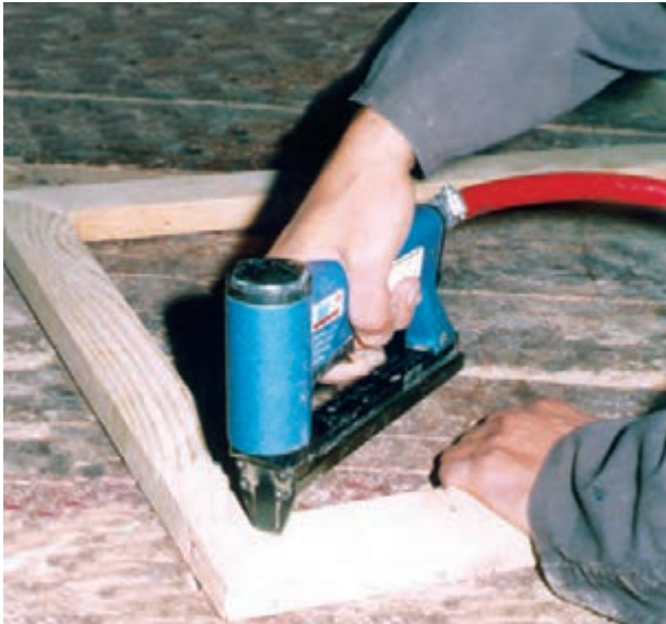
شکل ۱۶-۸. منگنه (زن روی درزهای ۴۵ درجه شده.
