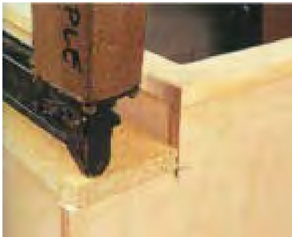
شکل ۸-۲۰- اتصال تخته خرده چوب به کابینت.
