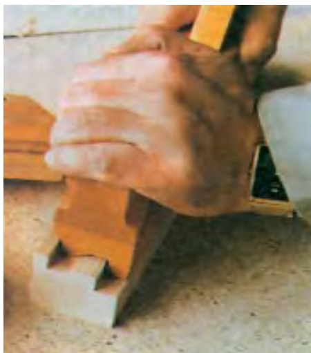
شکل ۷-۱۰-۴- رنده دستی افزار (پروفیلی)، برای تهیه زهوار تزئینی.
