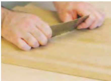
شکل ۲-۱۳. جهت حرکت لیسه، هنگام پُرزگیری.
