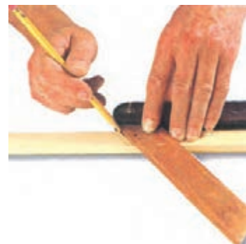
شکل ۱۰-۱۰. فطاکشی زهوار، با زاویه‌ی ۴۵ درجه.
