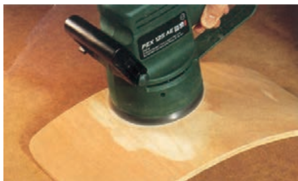
شکل ۷-۲۷. هنگام تعویض ورق سنباده باید دو شاخه دستگاه را از پریز خارج کنید.
