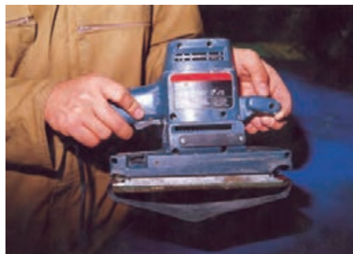
شکل ۷-۴۶- شل و سفت بسته شدن سنباده به دستگاه.
