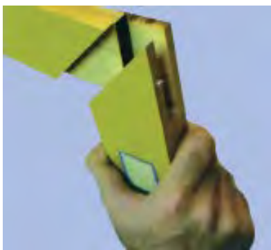
شکل ۱-۳۶- اتصال، باید با فشار محکم دست جا برود.
