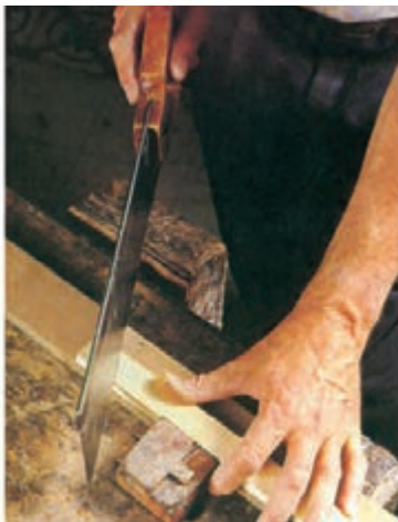
شکل ۱۱-۱۰. برش زهوار، با زاویه‌ی ۴۵ درجه.
