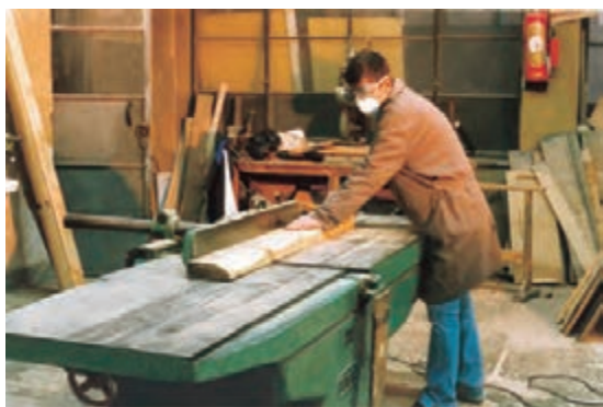
شکل ۹-۹- مقدار باز بودن زیاد گونیا، فطر آفرین است.
