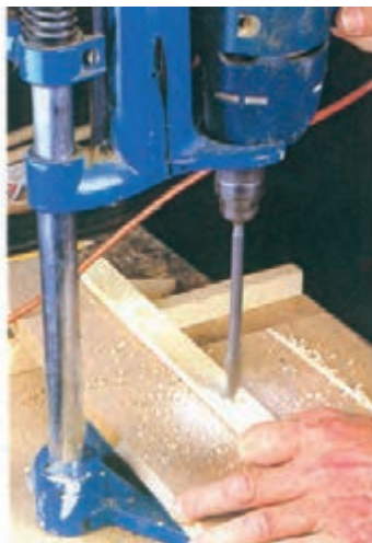
شکل ۱۲-۱۰. سوراخ‌کاری زهوار.
