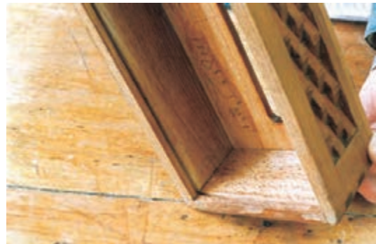
شکل ۹-۶۷- کنشکاف داخل بدنه‌های یک جعبه دستمال کاغذی.
