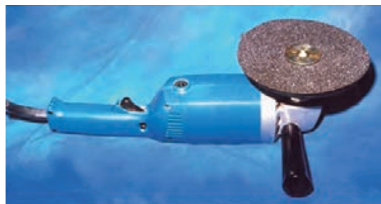
شکل ۷-۱۴- دستگاه سنباده دیسکی (ماشین پوست).
