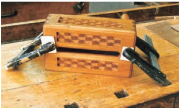
شکل ۹-۷۰- بستن سقف به بدنه‌ها.
