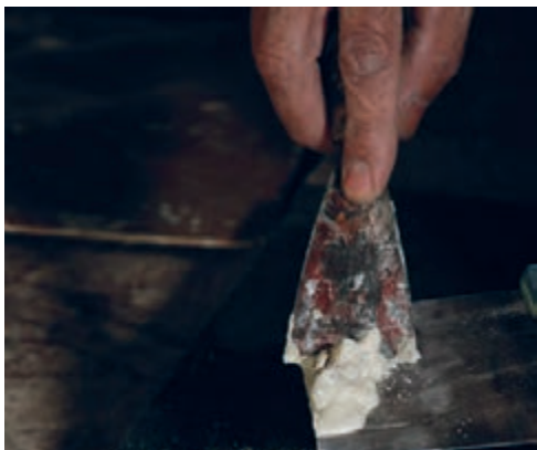
شکل ۴-۱۸- با کشیدن لیسه و کاردک به هم، باید آنها را تمیز کرد.
