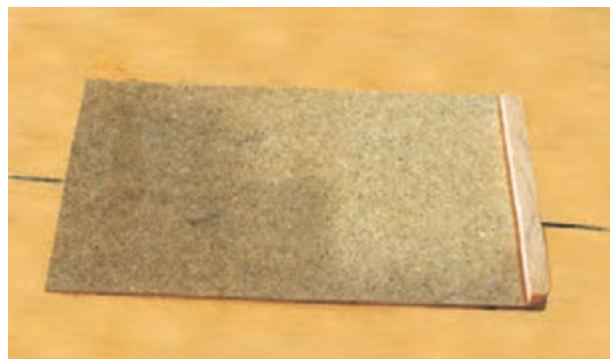
شکل ۹-۶۷- پسباندن زهوار به لبه‌ی کف جعبه.
