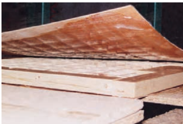
شکل ۱۱-۳۷- قرار دادن صفحه‌ی دوم، روی کلاف.
