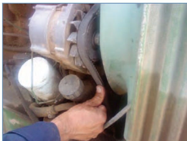
شکل ۳۶-۶ فشار دادن تسمه با شست
