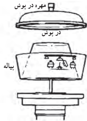
شکل ۳-۵ - قطعات پیش صافی
