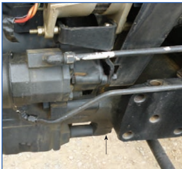
شکل ۱۷-۳- محل پیچ‌های اتصال موتور به جلوی تراکتور
