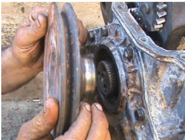
شکل ۴-۵۷- خارج کردن پولی میل لنگ
