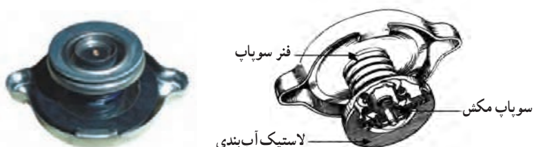
ب) اجزای در رادیاتور
