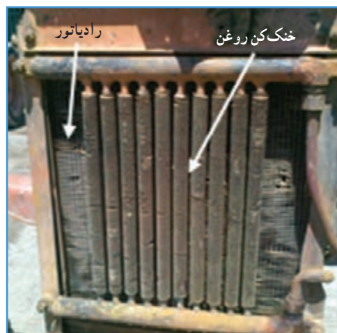
الف) خنک کن روغن تراکتور U650
