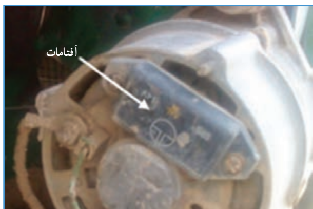
الف) آفتامات روی آلترناتور تراکتور JD3140
