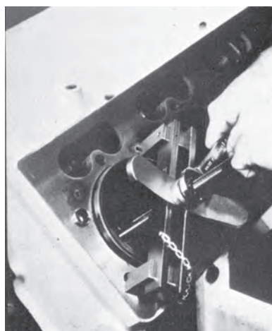
شکل ۱۴۳-۴- نحوه پیاده کردن بوش سیلندر
