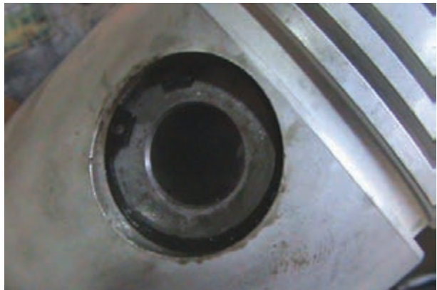
شکل ۱۲۵-۴ جا افتادن خار انگشتی در شیار پیستون
