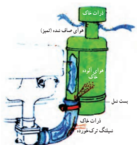
شکل ۱۹-۵- محل بریدگی و سوراخ شدگی در شیلنگ‌ها
