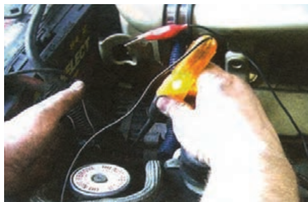
شکل ۷۷-۶- اتصال لامپ آزمایش به مدار
