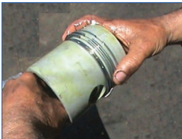
شکل ۱۹۶-۴- تنظیم کردن دهانه رینگ‌ها
