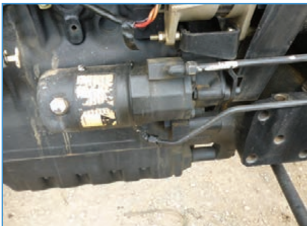
شکل ۲۳-۲. پمپ هیدرولیک فرمان و صافی تراکتور MF285
