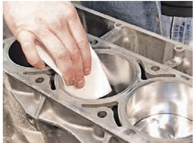
شکل ۴-۲۸- تمیز کردن داخل سیلندر
