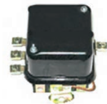
ب) آفتامات جدا از آلترناتور تراکتور U650
