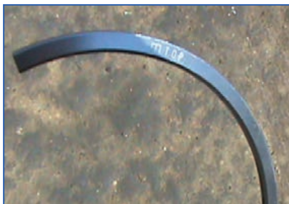
شکل ۱۳۴-۴ علامت TOP روی رینگ
