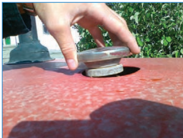
شکل ۷-۳- باز کردن در رادیاتور تراکتور MF285
