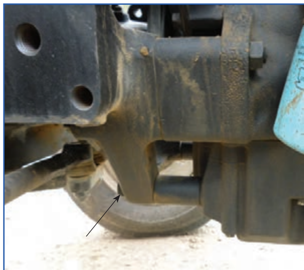
شکل ۱۷-۳- محل پیچ‌های اتصال موتور به جلوی تراکتور
