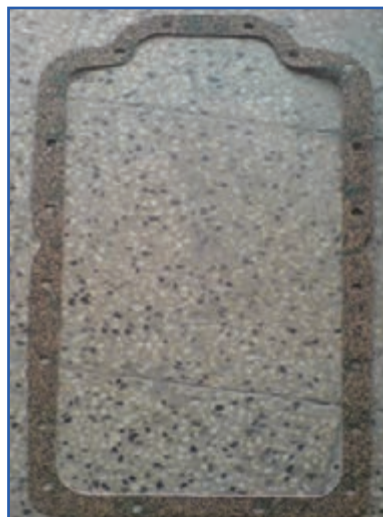
الف) واشر کارتر ویکتوری MF285
