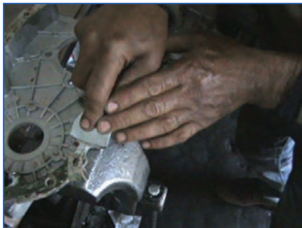
شکل ۷۶-۴- تمیز کردن واشر محفظه جلو موتور
