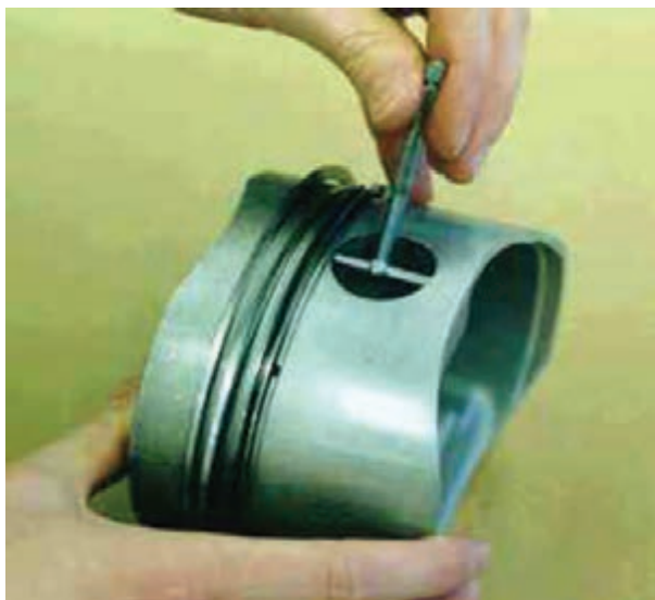
شکل ۱۱۷-۴ اندازه‌گیری سوراخ انگشتی روی پیستون
