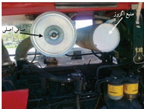
شکل ۲۶-۲. صافی اصلی تراکتور MF399
