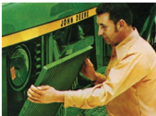
شکل ۱۰-۵ باز کردن شبکه بغل
