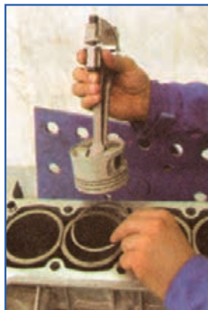
شکل ۱۲۷-۴ طرز قرار دادن رینگ داخل سیلندر
