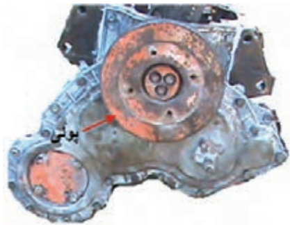
شکل ۴-۶۴- پولی نصب‌شده روی میل‌لنگ
