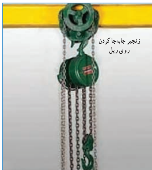
شکل ۲۰-۴ - اتصال جرثقیل سقفی به ریل
