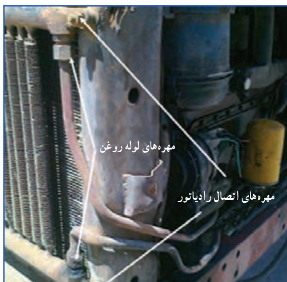
شکل ۳۸- ۷- مهره های لوله روغن سمت رادیاتور روغن
