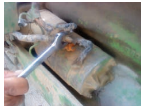
شکل ۵۰-۶ باز کردن کابل مثبت از استارت
