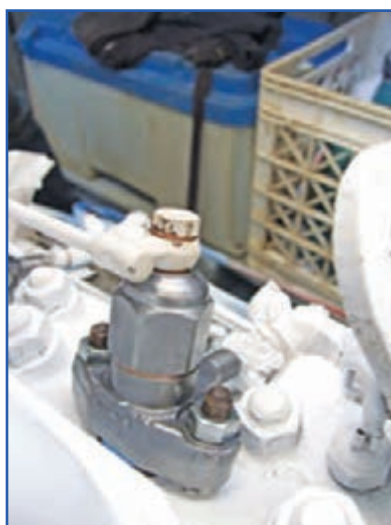
شکل ۵۴-۴- مراحل بستن انژکتور
