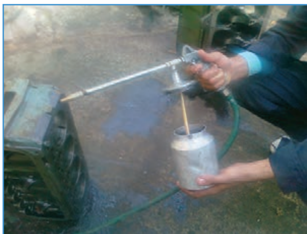
شکل ۱-۳- باز کردن مخزن پیستوله شستشو
