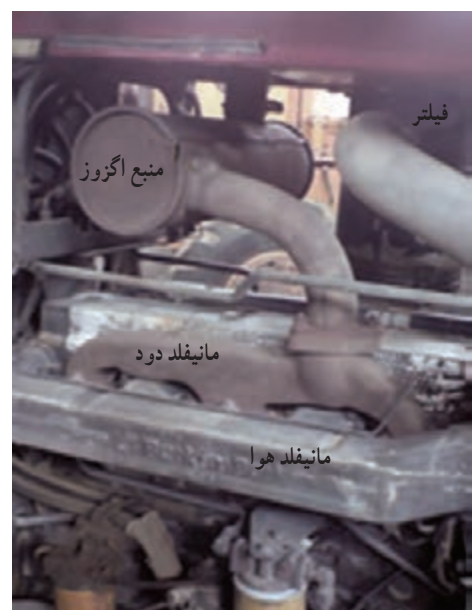
شکل ۵-۲۲- محل مانیفولد دود و هوا در تراکتور MF399
