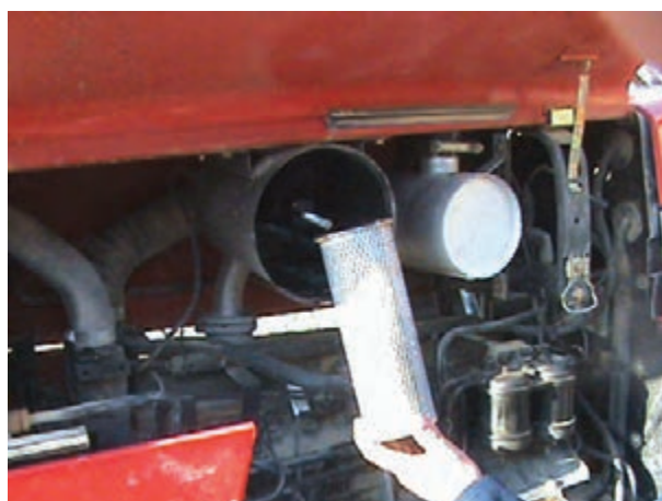
الف) خارج کردن صافی ثانویه
