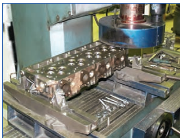
شکل ۳۲-۴- دستگاه کف تراشی سرسیلندر
