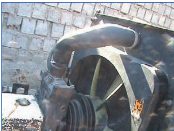
الف) باز کردن لوله لاستیکی رادیاتور
