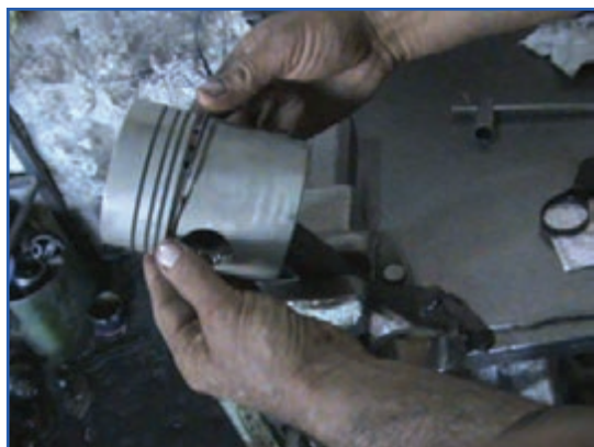
شکل ۱۳۸-۴ جازدن رینگ با دست
