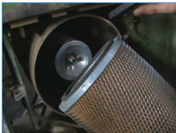
شکل ۵-۵ - صافی خشک و محل قرار گرفتن آن
