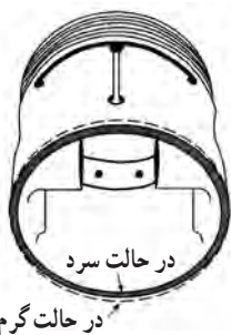
شکل ۱۹-۲ وضعیت پیستون در حالت گرم و سرد
