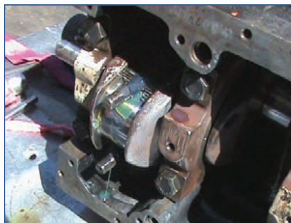
شکل ۲۰۳-۴ جا زدن شاتون روی میل لنگ
