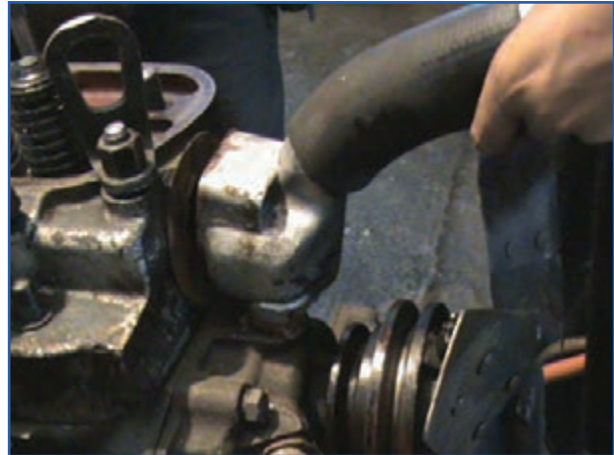
ب) باز کردن محفظه ترموستات تراکتور U650
