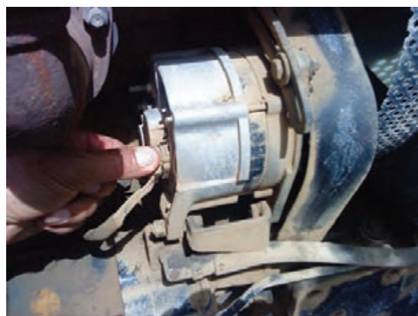
شکل ۲۸-۶- جدا کردن فیش از آلترناتور
