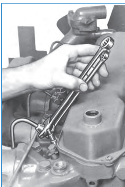
شکل ۲۲-۴ باز کردن لوله‌های فشارقوی انژکتورها
