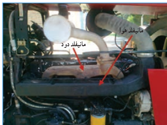
شکل ۲۷-۲. مانیفلد هوا و دود تراکتور MF399
