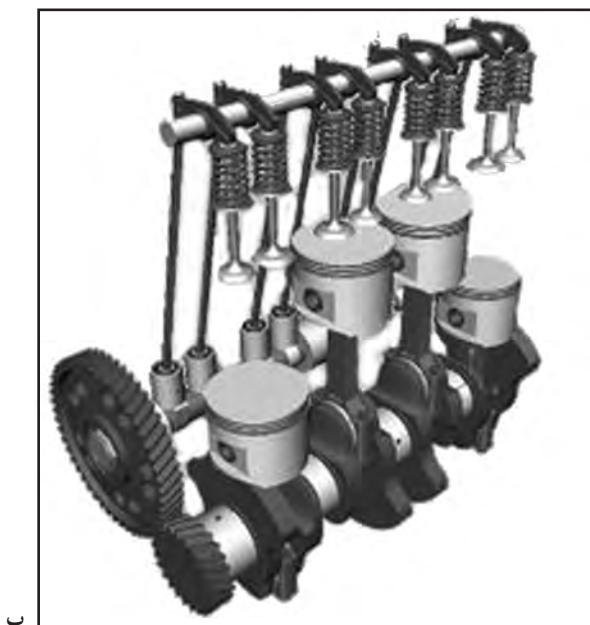
شکل ۸-۲ — قطعات مکانیزم باز و بسته شدن سوپاپ‌ها
