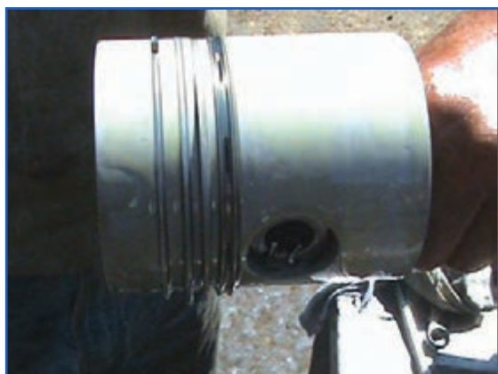
شکل ۱۴۰-۴ روغن کاری همه رینگ‌ها و پیستون
