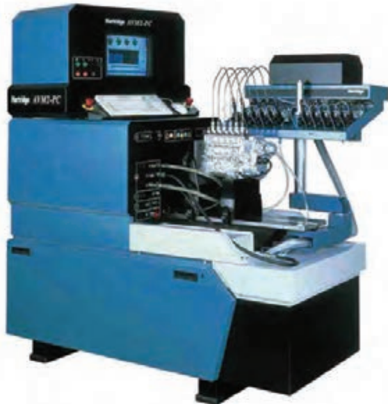
شکل ۲۴- دستگاه آزمودن و تنظیم پمپ انژکتور
