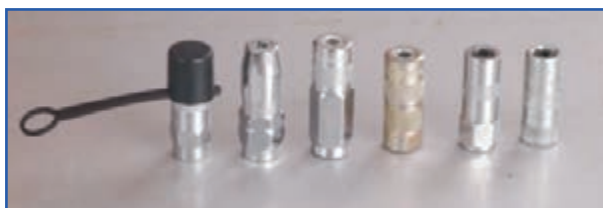
شکل ۵۱-۷- انواع سر گریس پمپ
