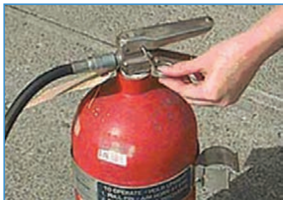
شکل ۱۱-۱- نحوه خارج کردن ضامن کپسول
