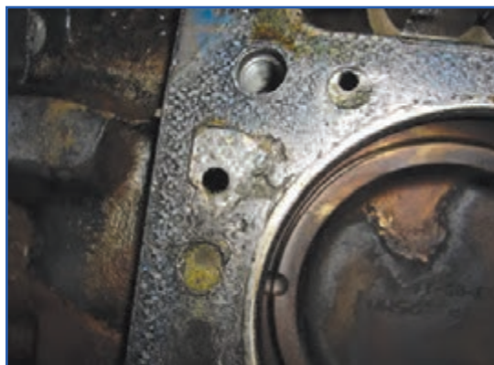
شکل ۴۲-۴ واشر سرسیلندر چسبیده به سیلندر
