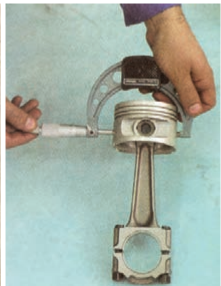
(الف) اندازه گیری قطر دامن پیستون
