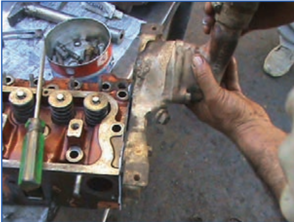
الف) باز کردن محفظه ترموستات تراکتور MF399
