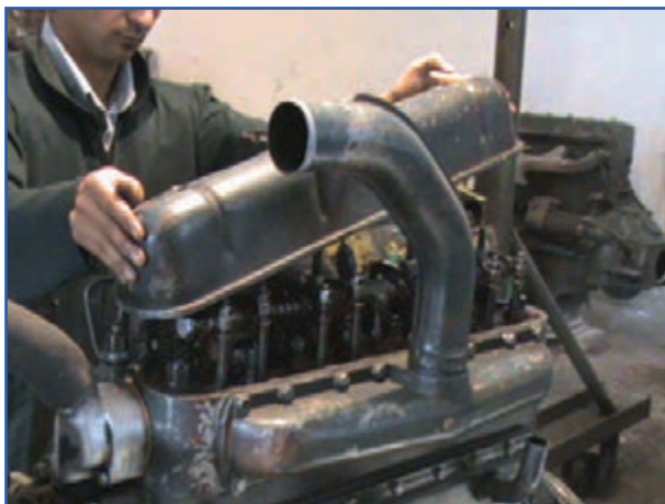
شکل ۴۰-۷- برداشتن قالیپاق سوپاپ
