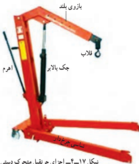
شکل ۱۷-۴ اجزای جرثقیل متحرک دستی
