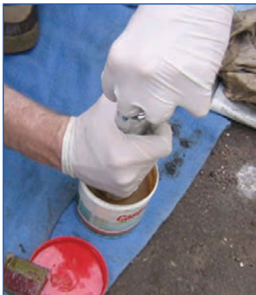
شکل ۴۸-۷- مراحل پر کردن گریس پمپ دستی
