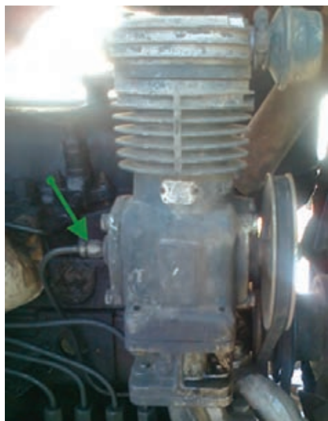
شکل ۵-۸- لوله روغن کاری کمپرسور در تراکتور U650
