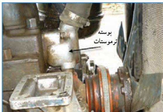
شکل ۳۷-۲ پوسته ترموستات تراکتور U650
