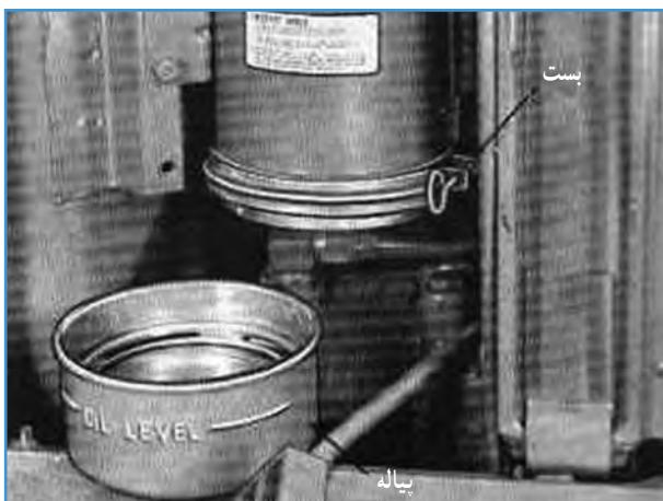
شکل ۱۷-۵ باز کردن پیاله زیر صافی
