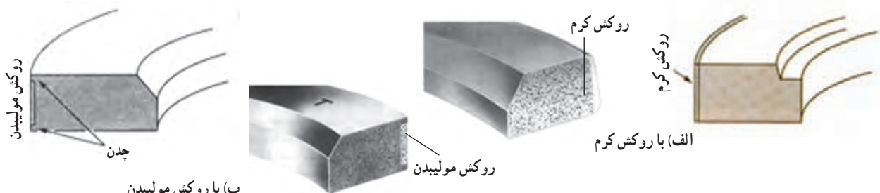
شکل ۲۴-۲ مقطع رینگ‌های تراکم روکش‌دار
