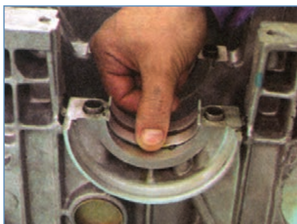
شکل ۴-۱۵۶ — خارج کردن یاتاقان‌های ثابت از روی تکیه‌گاه میل لنگ
