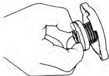
شکل ۱۷-۳- آزمون سوپاپ مکش در رادیاتور
