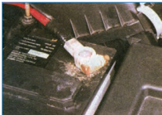
شکل ۲۱-۶- سولفاته کردن بست مثبت باتری
