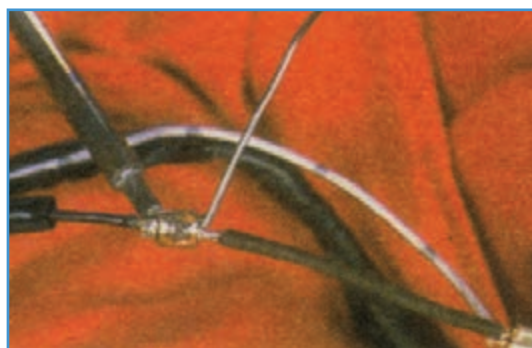
شکل ۶۴-۶- نحوه لحیم کاری سیم‌ها
