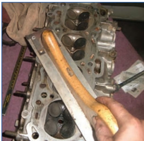
شکل ۴۴-۴- تمیز کردن سرسیلندر با سوهان نرم
