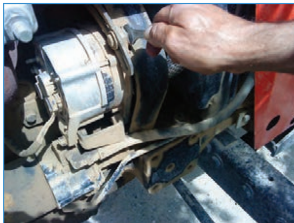
شکل ۲۹-۶ شل کردن پیچ و مهره تنظیم
