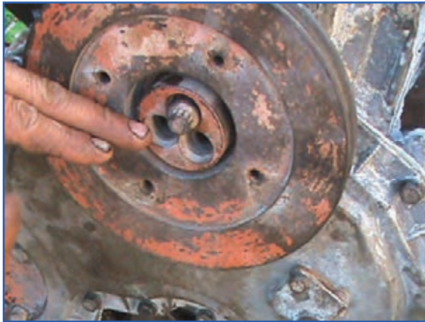
شکل ۴-۵۵- بستن پیچ سر میل لنگ تراکتور
