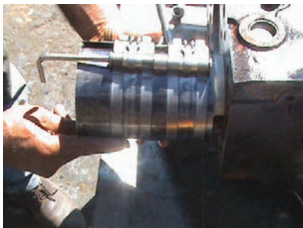
شکل ۱۹۸-۴- جمع کردن رینگ‌ها با رینگ جمع کن
