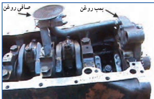
الف) محفظه میل‌لنگ بدون کارتر
