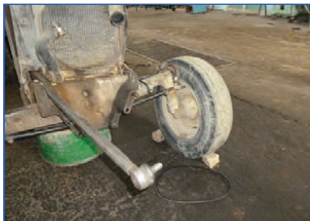
شکل ۱۹-۳ قسمت جلوی تراکتور جدا شده از موتور
