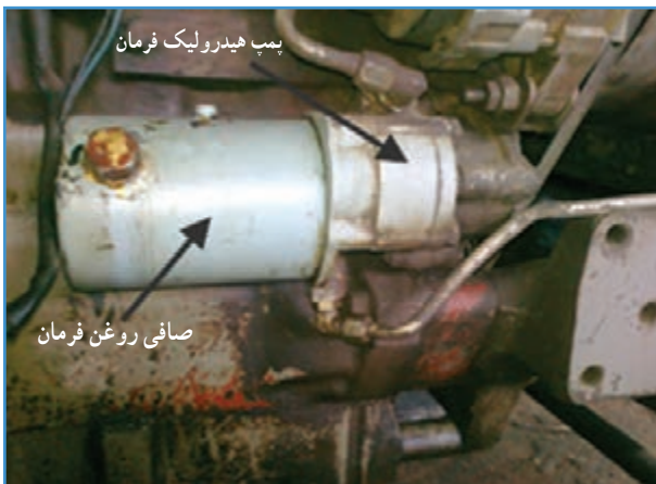
شکل ۲۳-۲. پمپ هیدرولیک فرمان و صافی تراکتور MF285
