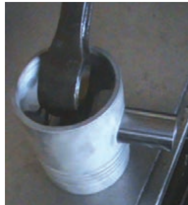
شکل ۱۲۲-۴ اتصال شاتون به پیستون و جازدن انگشتی
