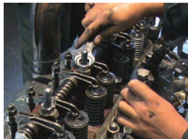
ب) باز کردن پایه محور اسبک تراکتور U 650
