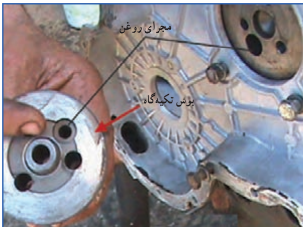
شکل ۶۸-۴ خارج کردن بوش تکیه‌گاه چرخ‌دنده واسط
