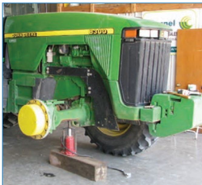
شکل ۱۱-۴- قرار دادن جک روغنی زیر جسم سنگین
