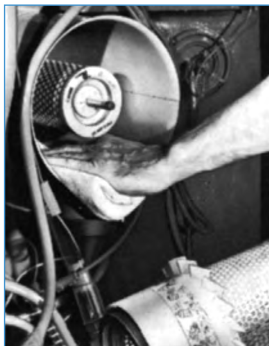
شکل ۱۳-۵ تمیز کردن بدنه صافی با پارچه
