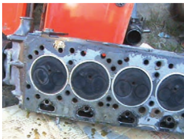
شکل ۱۵-۴ طرز قرار دادن سرسیلندر روی سطح صاف
