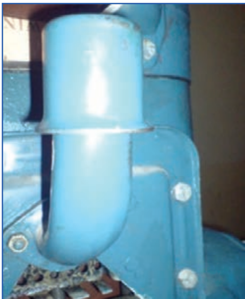
شکل ۲۹-۷ هواکش روغن U650M
