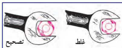
شکل ۲۹-۳ طرز درگیر کردن آچار تخت با مهره
