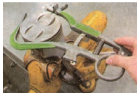
(ب) کاربرد ابزار تمیزکننده شیار رینگ‌ها
