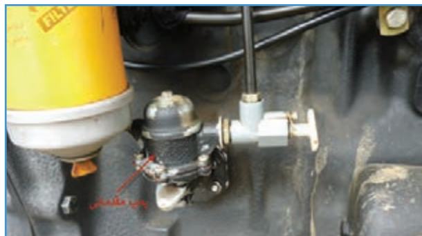
شکل ۲۹-۲ پمپ مقدماتی تراکتور MF285
