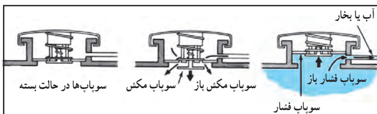
الف) وضعیت سوآپ‌های در رادیاتور
