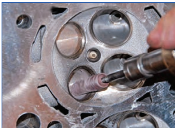
الف) نحوه تمیز کردن محفظه پشت سوپاپ
