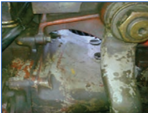
شکل ۹-۳- پیچ‌های اتصال موتور به جعبه‌دنده قسمت بالا
