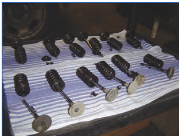
(الف) اجزای باز شده سوپاپ
