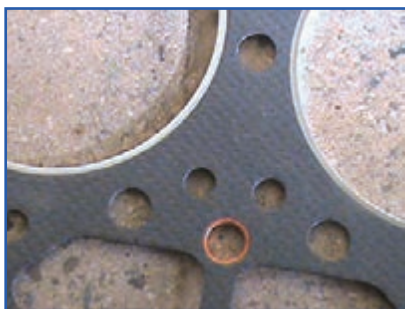
ب) سمت باریک نوار فلزی واشر سرسیلندر
