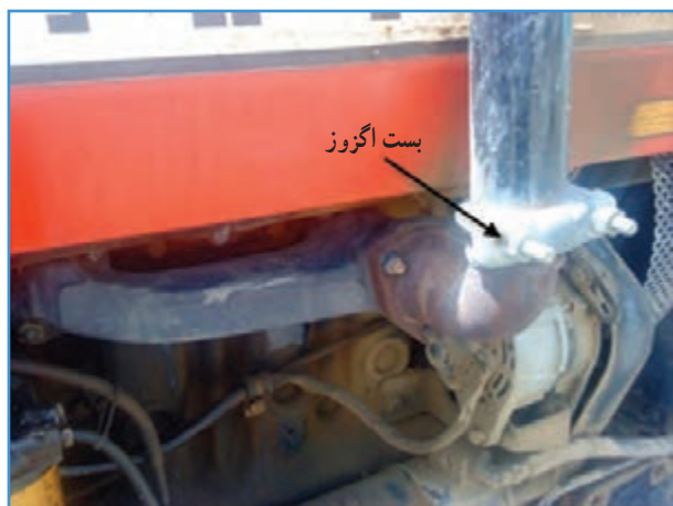
ب) بست اگزوز در تراکتور MF285
