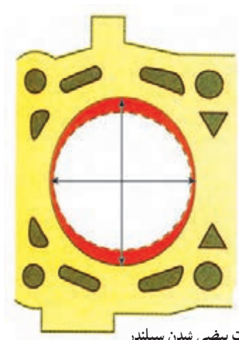
شکل ۱۴۹-۴ وضعیت بیضی شدن سیلندر
