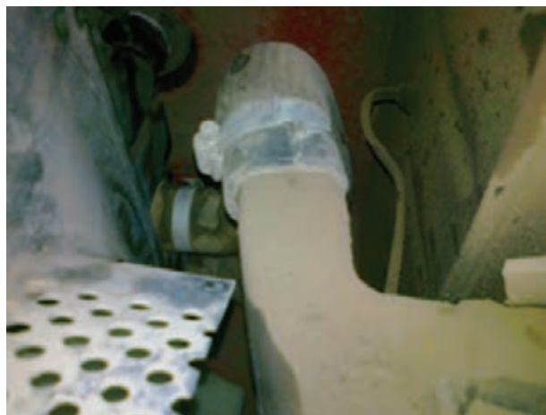
شکل ۱۵-۳- اتصال شیلنگ رادیاتور
