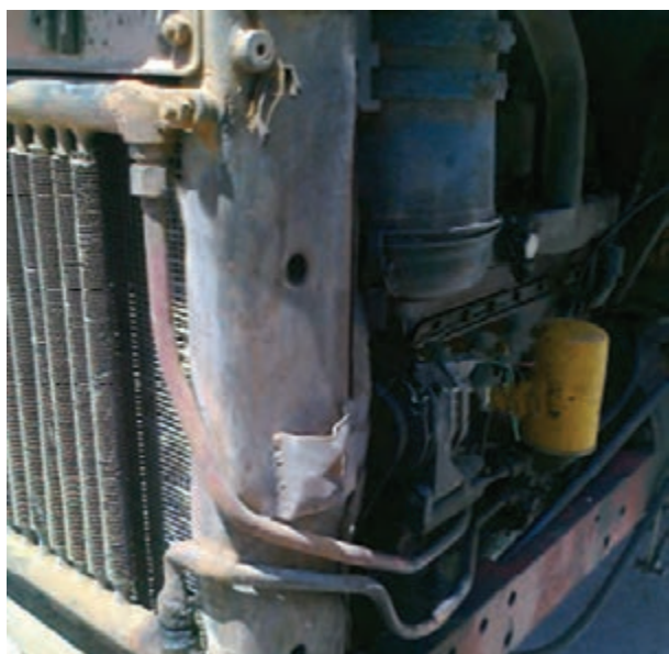
شکل ۱۲-۳- محل مهره‌های رادیاتور روغن
