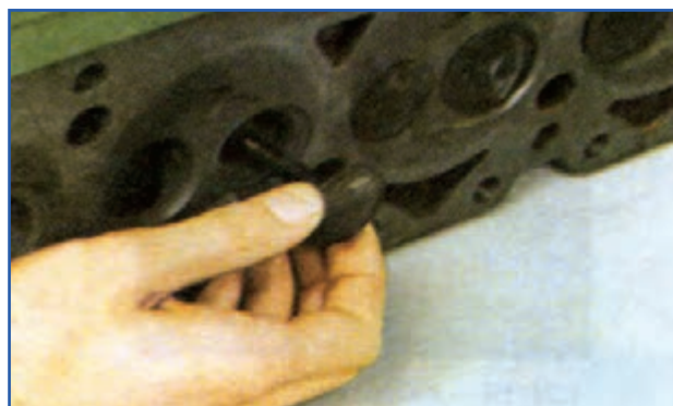
شكل ۲۳-۴- نحوه خارج کردن سوپاپ‌ها
