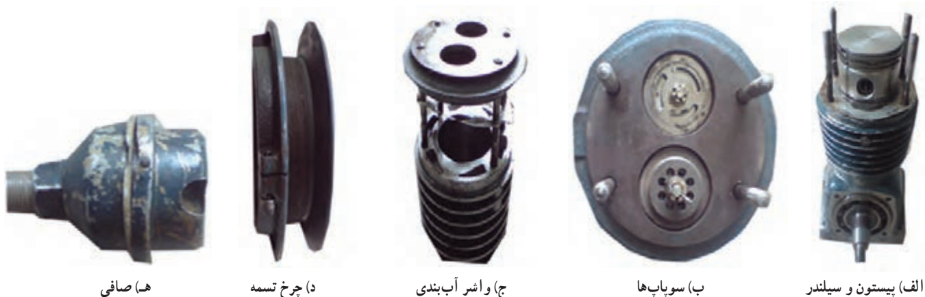
شکل ۳-۸- اجزای کمپرسور باد
