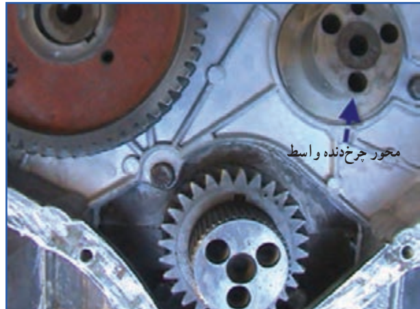
شکل ۶۷-۴ چرخ‌دنده واسط برداشته شده است.
