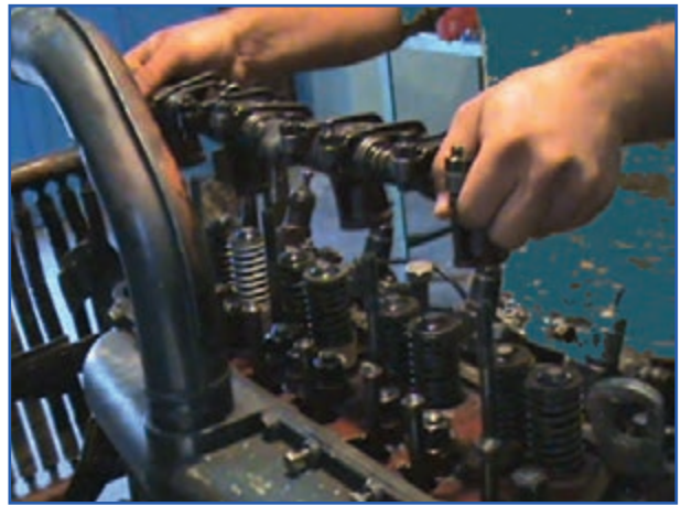
شکل ۹-۴ برداشتن محور اسبک و اسبک‌ها تراکتور U650
