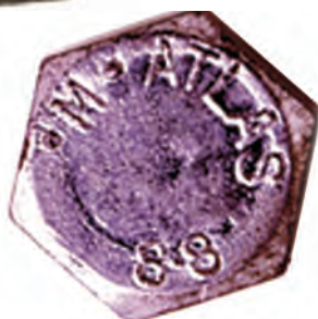
شکل ۱۵-۳ اعداد حک شده روی سر پیچ
