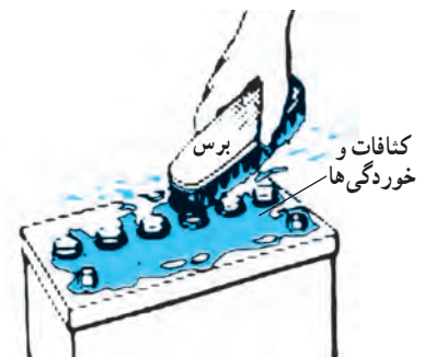
(الف) تمیز کردن با برس و آب
