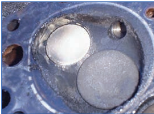
شکل ۴۱-۴ تمیز کردن اتاق احتراق
