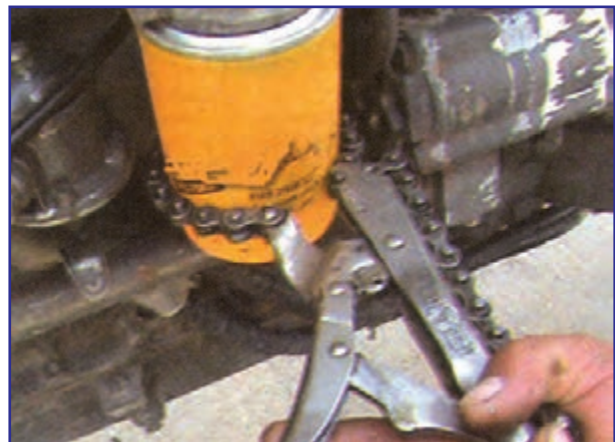
شکل ۱۶-۷ باز کردن صافی روغن با آچار مخصوص
