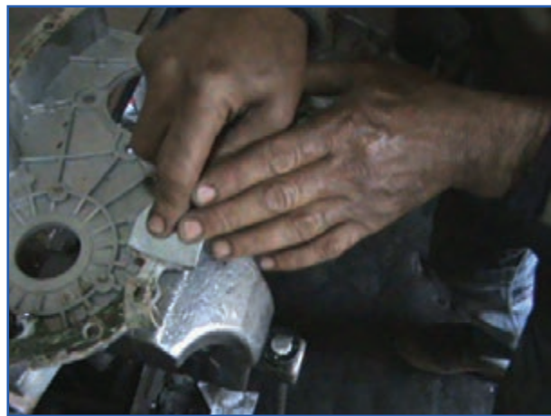
شکل ۴۱-۷ تمیز کردن واشر سینی جلو با کاردک
