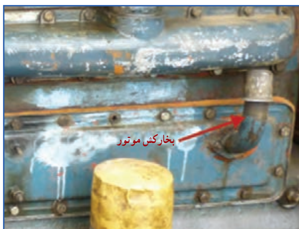
شکل ۲۶-۷- تهویه محفظه کارت تراکتور U650M
