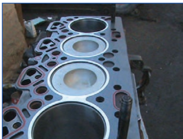
شکل ۵۲-۴ قرار دادن واشر سرسیلندر روی بدنه سیلندر
