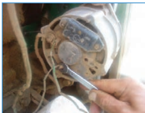
شکل ۳۵-۶ بستن سیم نازک
