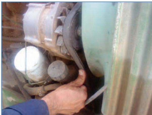
شکل ۲۸-۳ اندازه‌گیری کشش تسمه با فشار انگشت
