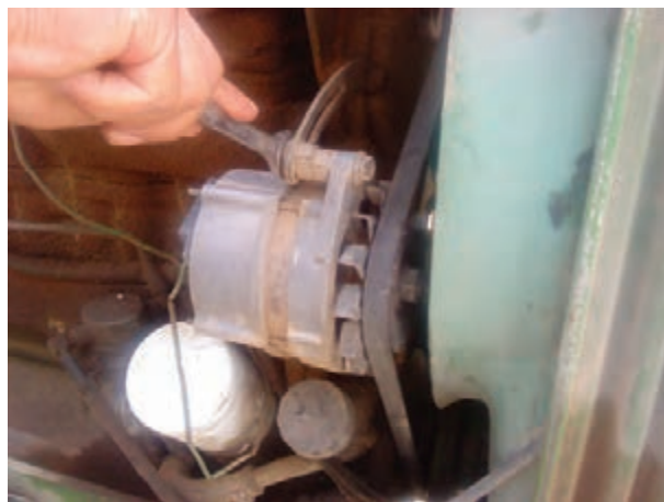
شکل ۳۸-۶ سفت کردن پیچ تنظیم آلترناتور
