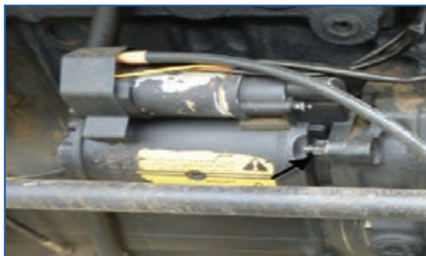
شکل ۳-۸ پیچ های نگه دارنده استارت تراکتور MF285
