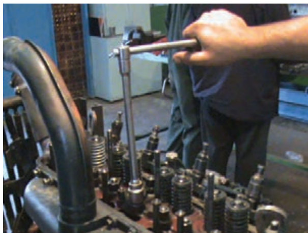
الف) باز کردن پیچ‌های سرسیلندر تراکتور U650
