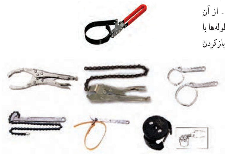
شکل ۶۲-۳- آچار فیلتر بازکن
