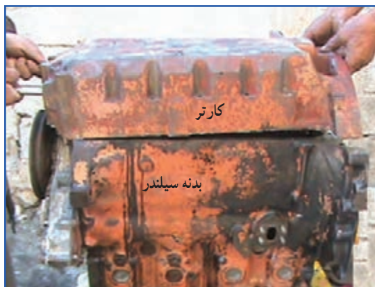
ب) برداشتن کارتر
