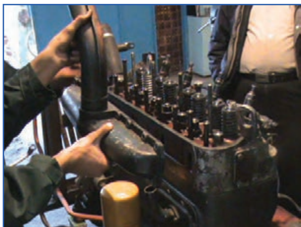
شکل ۴-۴- باز کردن مانیفولد هوا
