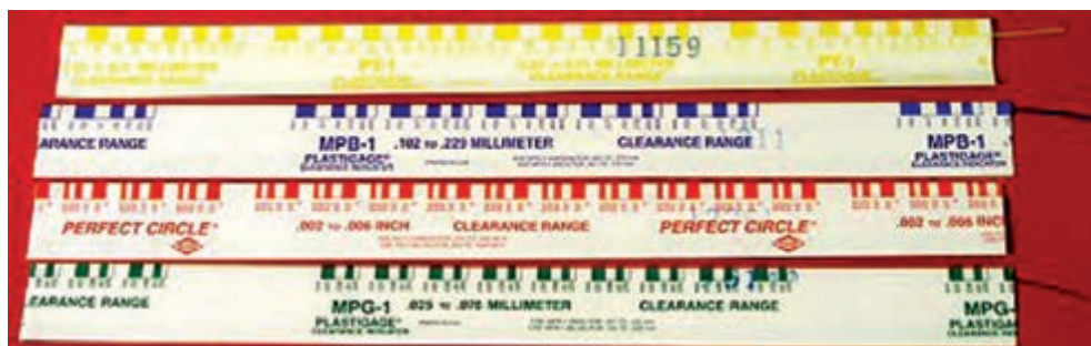
شکل ۱۷۸-۴ انواع پلاستیک گیج
