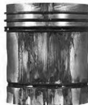
الف) خط و خش روی پیستون
