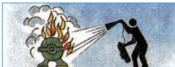
شکل ۱۴-۱- خاموش کردن آتش با دی اکسید کربن
