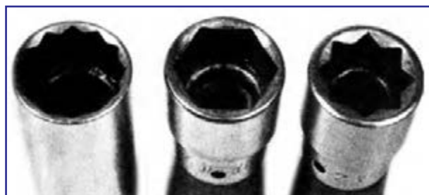
شکل ۳۵-۳- آچار بکس شش، هشت و دوازده گوش
