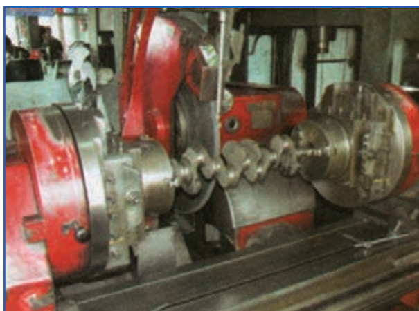
شکل ۱۶۴-۴ دستگاه میل لنگ تراشی
