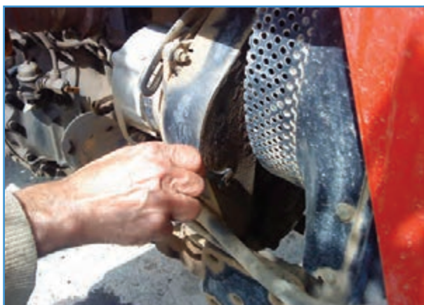
شکل ۳۲-۶ باز کردن روکش محافظ تسمه
