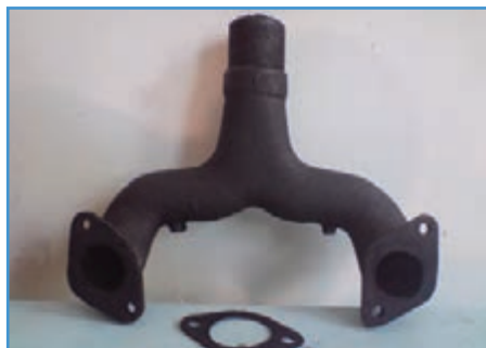
شکل ۵-۲۱- مانیفولد دود تراکتور U650
