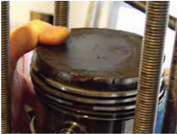
شکل ۴-۲۷- رسوبات کربن روی سطح پیستون
