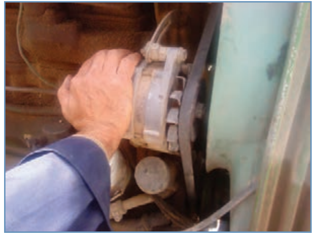
شکل ۳۰-۳ فشار دادن مولد به سمت موتور
