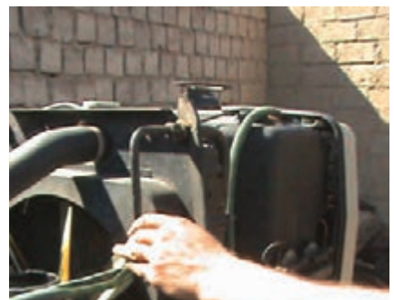
د) باز کردن لوله خنک کن روغن
