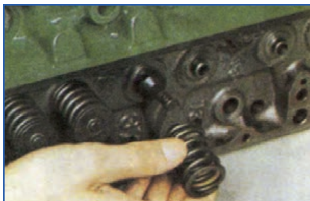
شکل ۴-۲۱- نحوه برداشتن فنر سوپاپ
