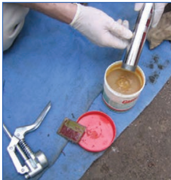
شکل ۴۸-۷- مراحل پر کردن گریس پمپ دستی
