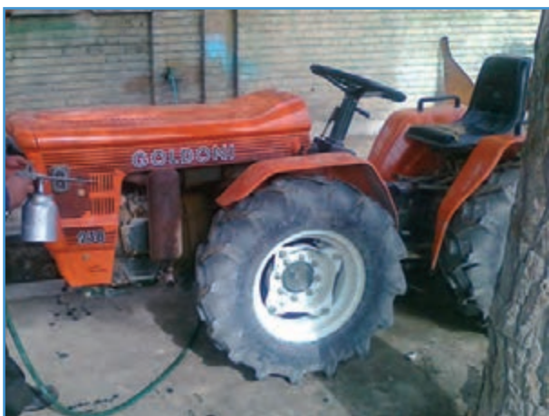
شکل ۱-۴- شستشوی موتور تراکتور با پیستوله شستشو
