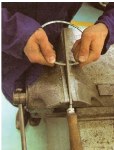
شکل ۱۳۰-۴ ساییدن دهانه رینگ با سوهان
