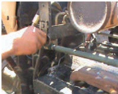
ج) باز کردن شاسی نگهدارنده رادیاتور
