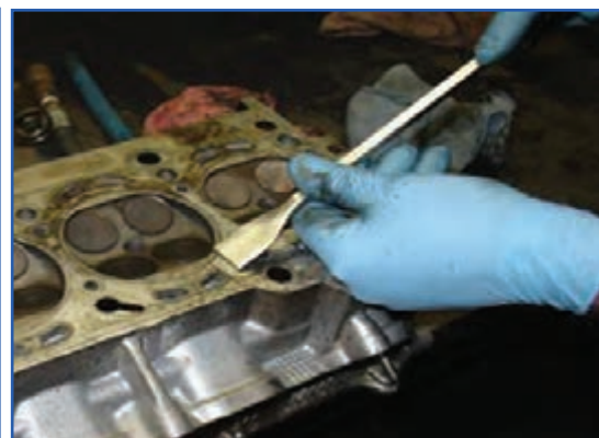
شکل ۴۲-۴ واشر سرسیلندر چسبیده به سیلندر
