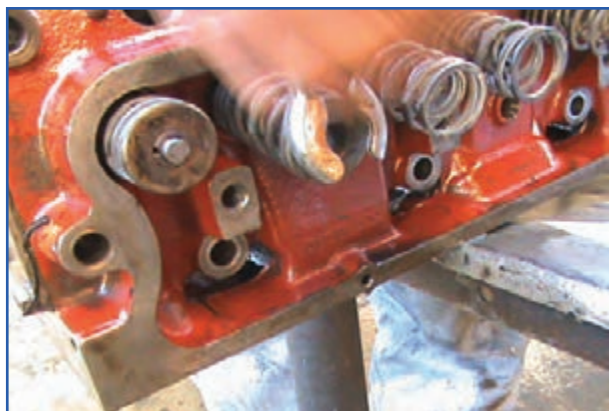
شکل ۴-۱۹- باز کردن اهرم فنر جمع کن
