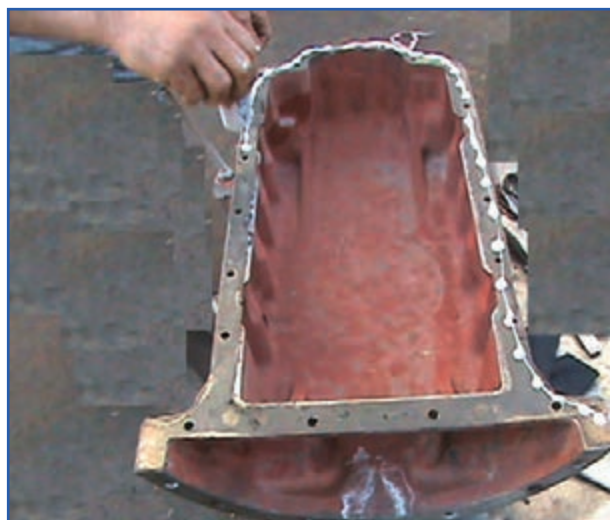
شکل ۳۲-۷ چسب زدن به محل قرارگیری واشر کارتر
