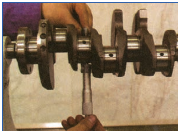
شکل ۱۶۲-۴ اندازه گیری قطر محورها میل لنگ
