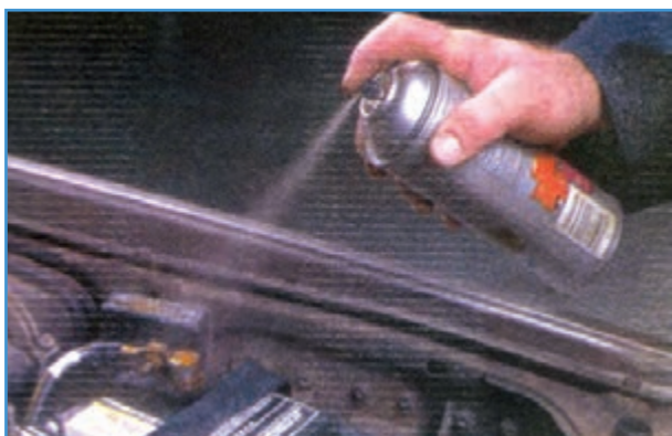
شکل ۱۱-۶ پاشیدن اسپری ضد خوردگی روی بست باتری
