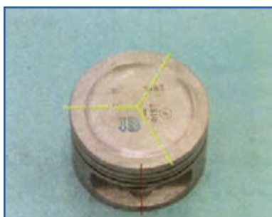
شکل ۱۳۵-۴- زاویه قرار گرفتن رینگ‌ها نسبت به هم
