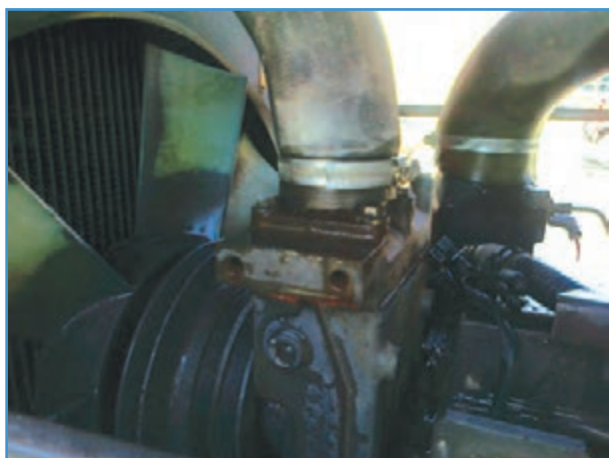
شکل ۱۱-۳- محل بست شیلنگ محفظه ترموستات
