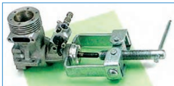
شکل ۷۷-۳- خارج کردن بلبرینگ با بلبرینگ کش
