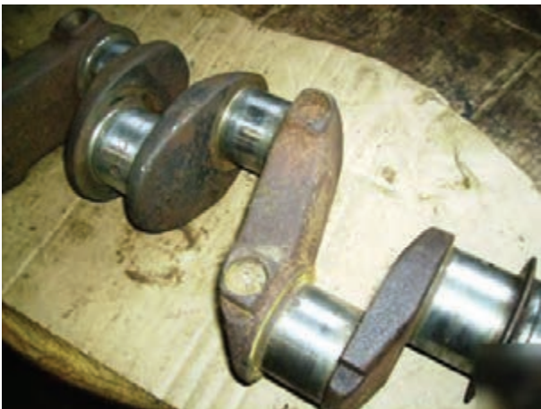
شکل ۴-۳۰- میل لنگ با رسوبات کربن
