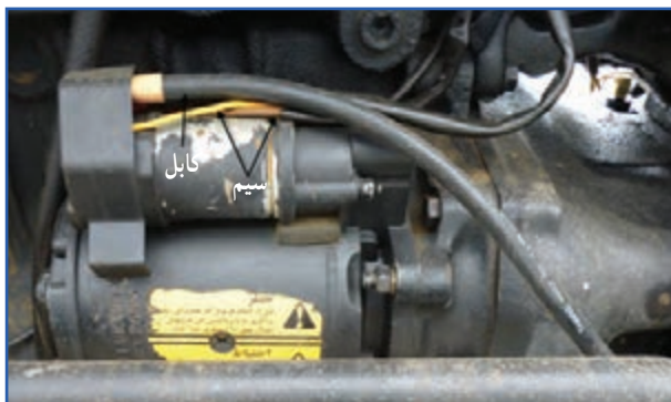
ب) سیم و کابل متصل به استارت
