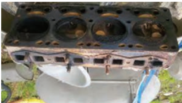
شکل ۴-۲۹- رسوبات کربن سطح سرسیلندر
