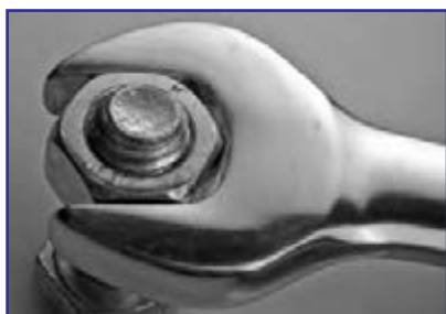
شکل ۲۸-۳ آچار تخت با سر زاویه دار (اینجی)
