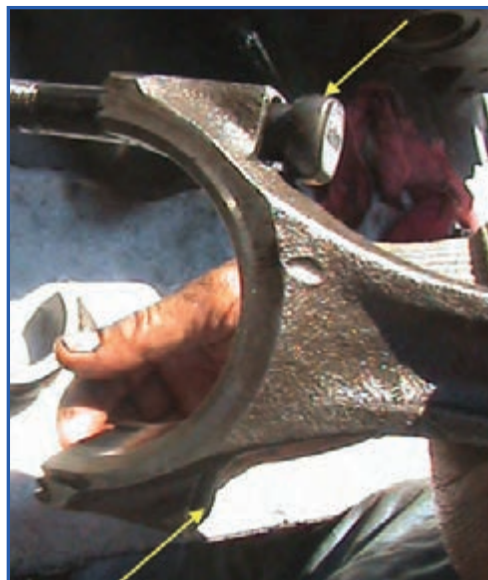
شکل ۸۵-۴- خارج کردن پیچ شاتون
