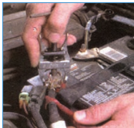
شکل ۸-۶ باز کردن بست مثبت باتری
