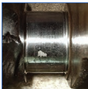
ب) پوسته کردن لایه سخت لنگ
