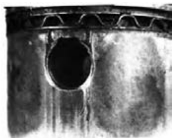
شکل ۱۱۹-۴ خراب شدن جای خار انگشتی
