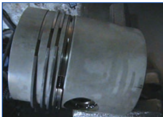
شکل ۱۳۹-۴ ترتیب قرار گرفتن رینگ‌ها روی شیار پیستون
