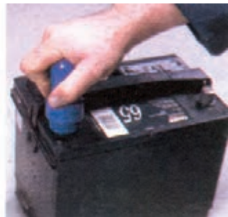
شکل ۲۳-۶- تمیز کردن قطب‌های باتری با ابزار مخصوص
