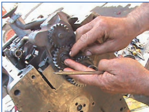
شکل ۷۹-۴- خارج کردن چرخ‌دنده پمپ روغن
