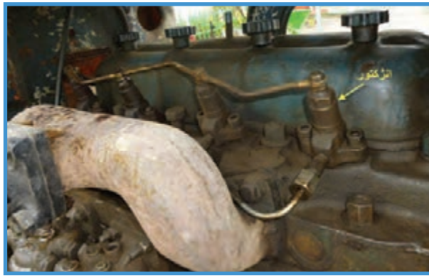
شکل ۳۲-۲ انژکتورهای تراکتور U650M
