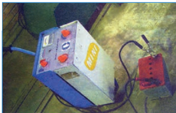
شکل ۱۸-۶ اتصال کابل‌های شارژر به باتری
