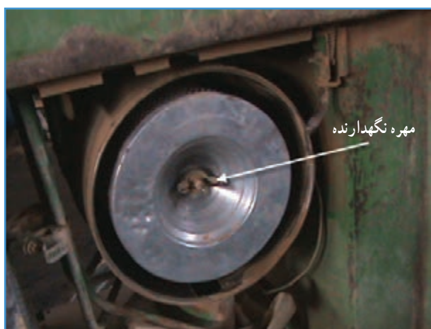
شکل ۱۰-۵ باز کردن شبکه بغل
