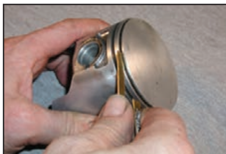
(د) تمیز کردن شیار با ابزار برنجی
