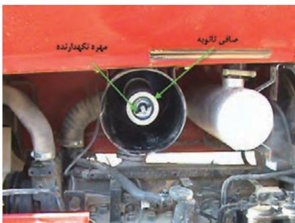
ب) محل قرار گرفتن صافی ثانویه
