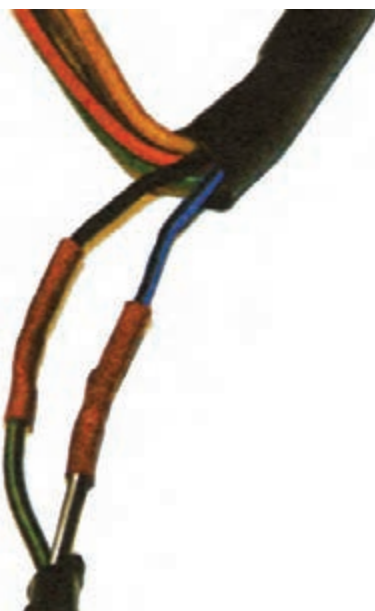
شکل ۶۷-۶- اتصال کامل سیم‌ها با روکش تیوپ عایق
