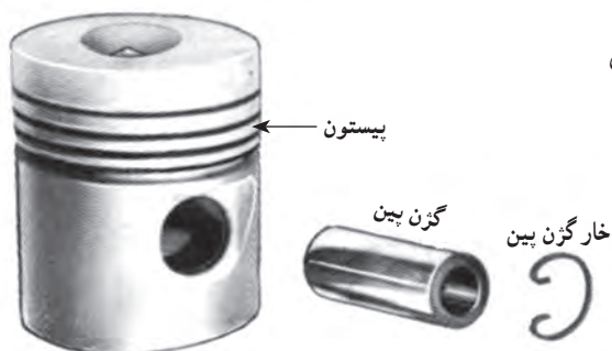
شکل ۳۰-۲- انگشتی و محل نصب آن روی پیستون
