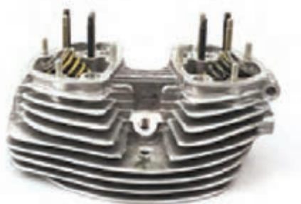
شکل ۳-۲ - سرسیلندر موتور هوا خنک
