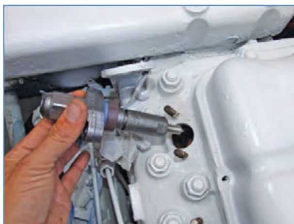
شکل ۲۳-۴ خارج کردن انژکتور
