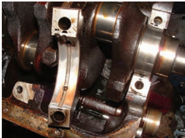
شکل ۱۸۲-۴ باز کردن کپه یاتاقان ثابت
