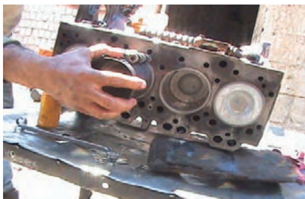
شکل ۱۹۹-۴- چسباندن رینگ جمع کن به سیلندر
