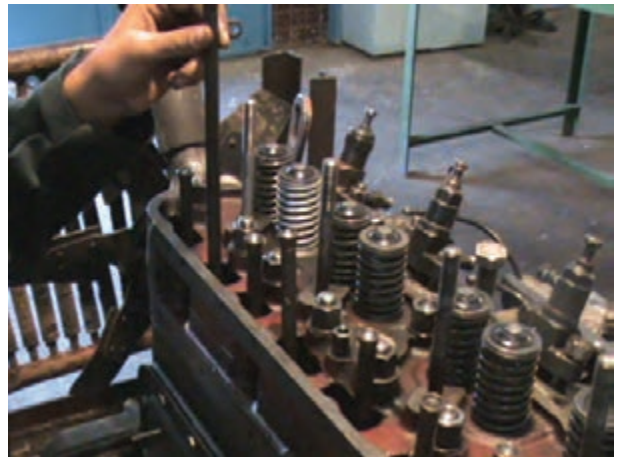
الف) برداشتن میل تایپت
