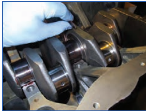
شکل ۱۸۳-۴ خارج کردن بغل یاتاقانی
