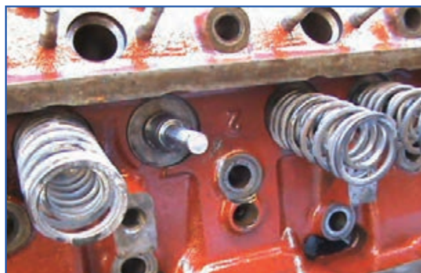
شکل ۴-۲۱- نحوه برداشتن فنر سوپاپ
