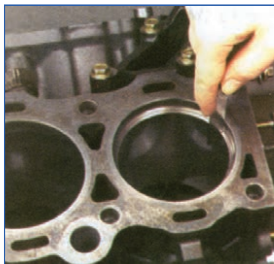
شکل ۱۲۸-۴ طرز اندازه گیری دهانه رینگ با فیلر
