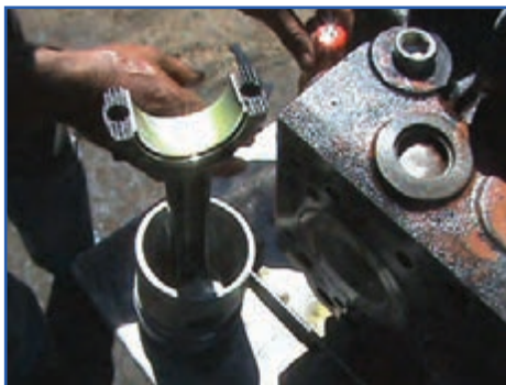
شکل ۱۹۲-۴ روغن‌کاری رینگ‌ها، پیستون و یاتاقان
