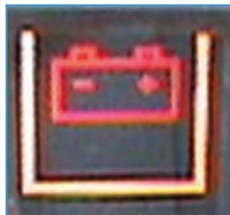
الف) چراغ هشداردهنده شارژ
