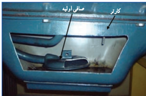
شکل ۲۴-۷- کارت برش خورده تراکتور U650
