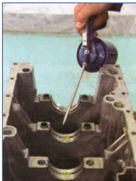
شکل ۱۸۷-۴ روغن کاری یاتاقان‌های ثابت
