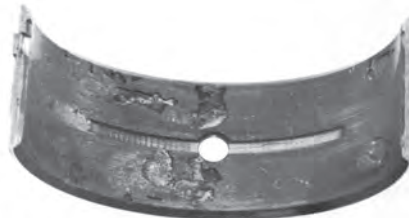
شکل ۱۶۷-۴ نقاط ذوب‌شده روی یاتاقان
