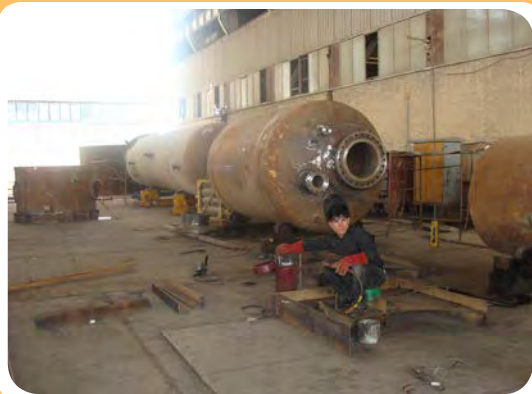
ب) کارگاه ساخت مخازن تحت فشار
