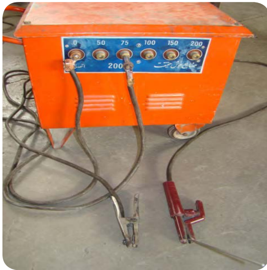
ترانسفورماتور جوشکاری جریان برق شهری را به جریان جوشکاری تبدیل می‌کند.
