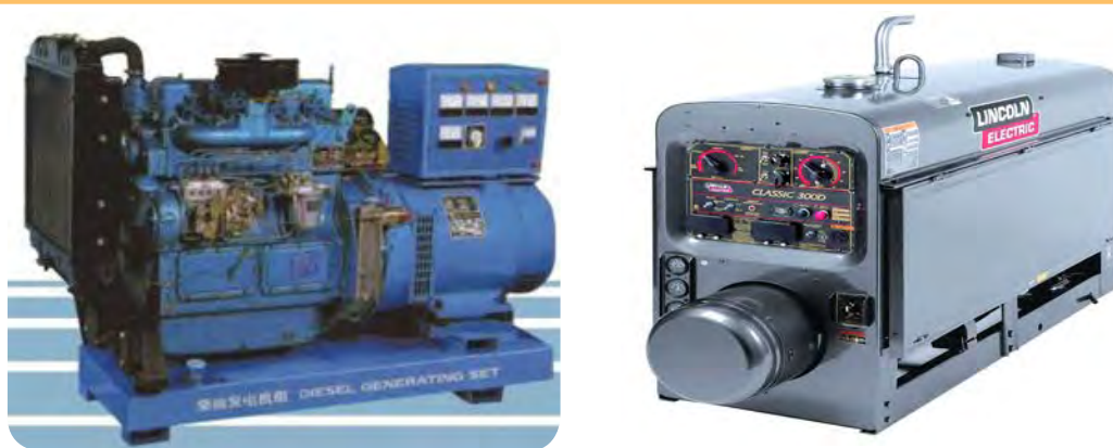
دو مدل از مولدهای جریان جوشکاری که با سوخت مایع کار می‌کنند.
