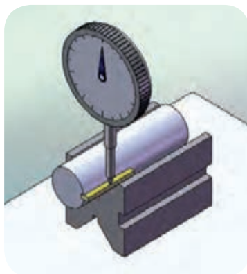
کنترل شیار از نظر طولی
