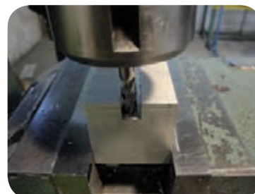
شیار تراشی با تیغه فرز انگشتی
