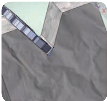
باقیمانده قسمتی از راس شیار در شیارهای V کمتر از ۹۰ درجه
