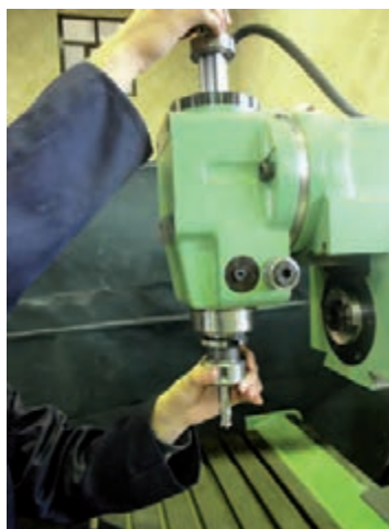
نحوه بستن کُلت بر روی دستگاه
