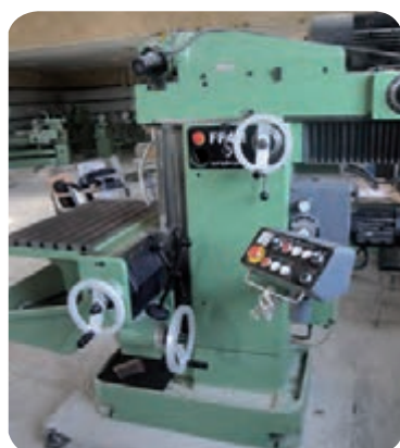
فلکه‌های دستگاه برای جابجایی دستی
