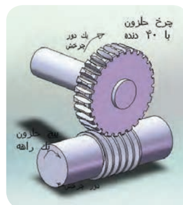
سیستم چرخ حلزون و پیچ حلزون
