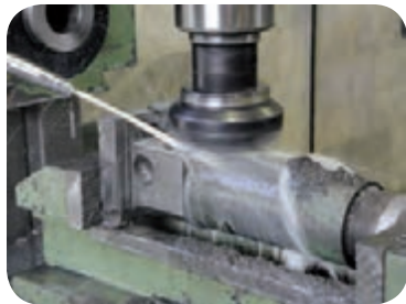
اعمال مایع خنک کننده بر سطح قطعه کار
