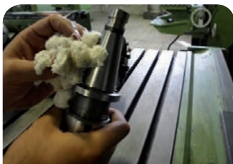
تمیز کردن دنباله میله فرزگیر
