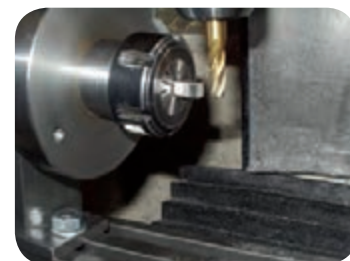
چهارگوش کردن قطعه به کمک دستگاه تقسیم
