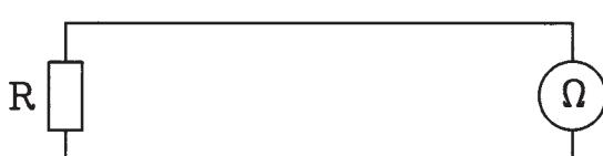
شکل ۵-۵۴- مدار اتصال اهم متر به مقاومت
