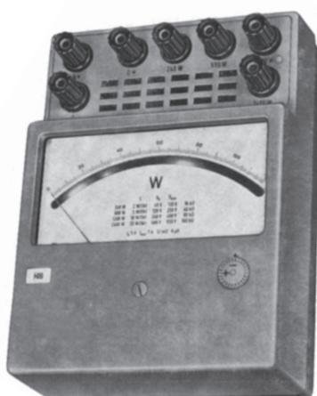
شکل ۵-۳۶—شكل ظاهری وات‌متر
