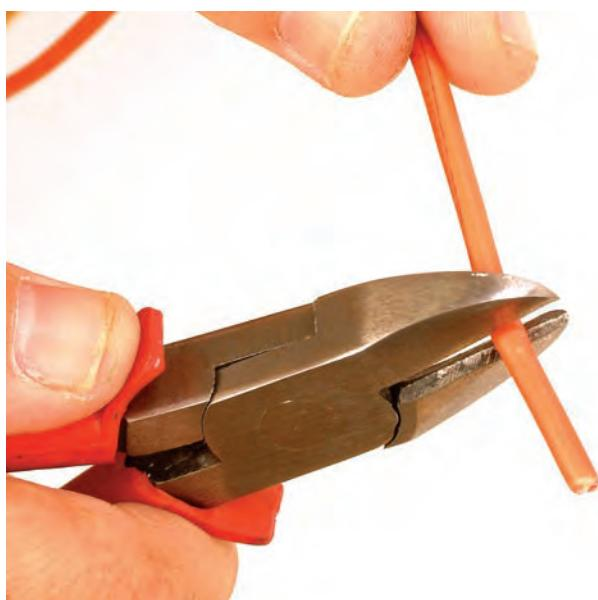
شکل ۱-۱۰- هنگام بریدن سیم سر آن به سمت زمین گرفته شود.
