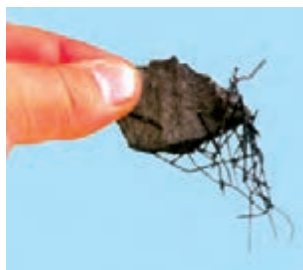
شکل ۱-۱- آهنربای طبیعی براده‌های آهن را جذب می‌کند.
