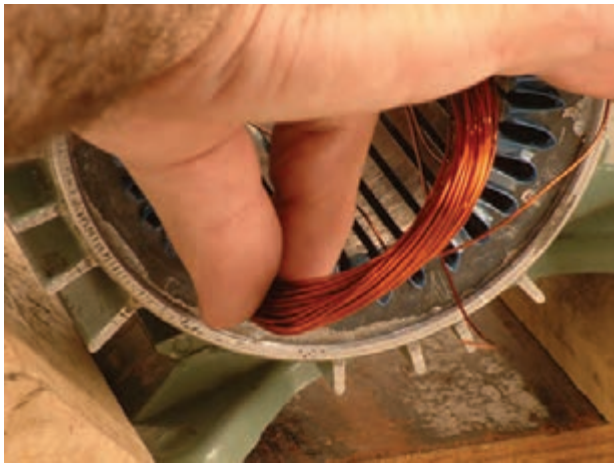
شکل ۲-۶- موقعیت انگشتان شست و سبابه در جای‌گذاری کلاف‌ها در داخل شیار استاتور
