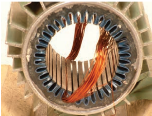
شکل ۲-۱۰- طول کاغذ پرشمان از هر طرف شیار حدود ۲ تا ۲/۵ میلی‌متر بیشتر است.
