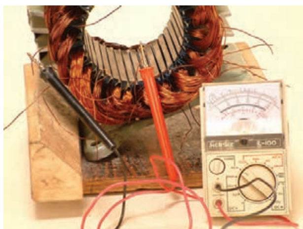
شکل ۱-۳- سر و ته یک گروه کلاف مقاومت ناچیزی نشان می‌دهد.
