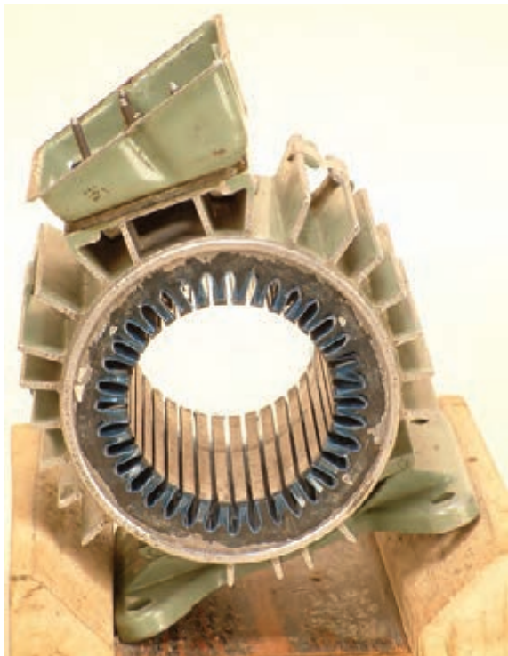
شکل ۱۳-۲- انتخاب شیار شروع و مسیر کلاف‌گذاری
