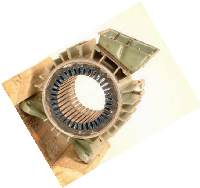
شکل ۱۲-۲- پوسته موتور سه فاز ۳۶ شیار
