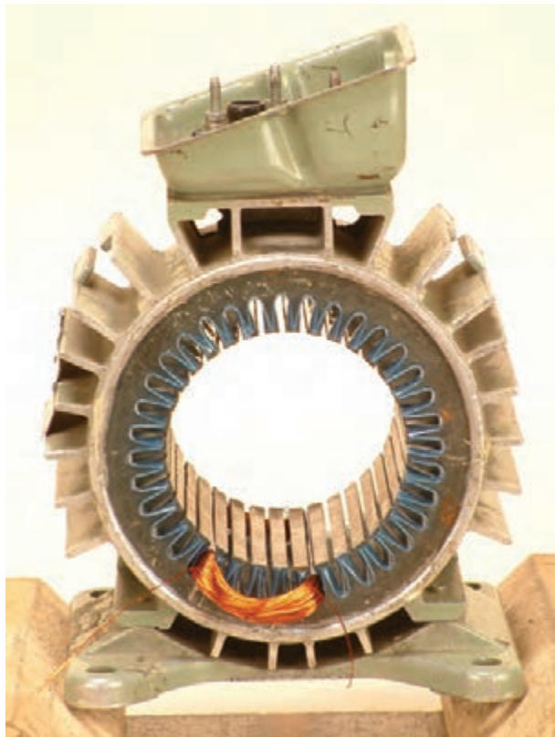
شکل ۲۹-۲-ج - قراردادن کلاف شماره ۱
