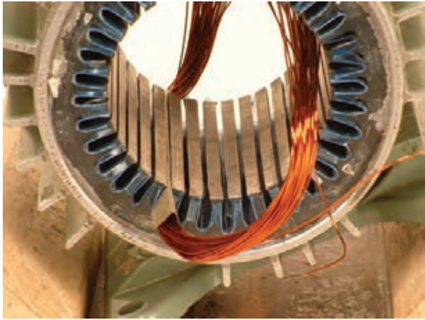
شکل ۲-۹- پوشاندن روی بازوها توسط کاغذ پرشمان
