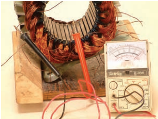
شکل ۳-۴- آزمایش ارتباط کلاف‌های گروه کلاف شماره ۱
