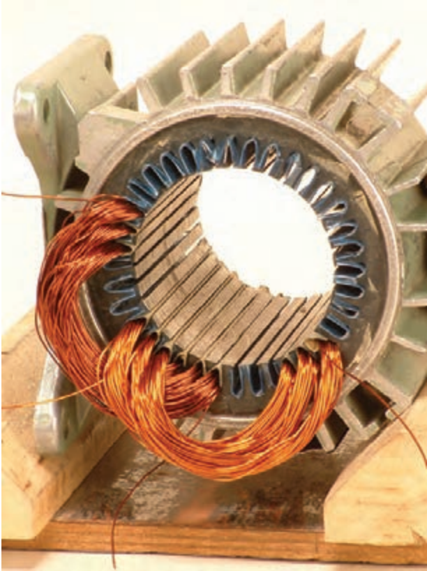
شکل ۲-۲۲- شروع گروه کلاف سوم از شیار شماره ۱۳
