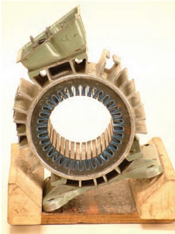
شکل ۲۹-۲-ب - انتخاب شیار شروع سیم بندی
