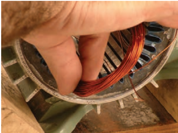
شکل ۱۵-۲- قراردادن بازوی شماره یک در شیار شماره ۱
