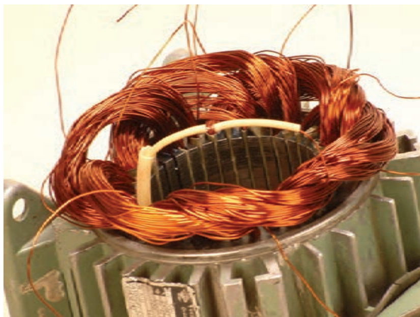
شکل ۳-۹- هدایت وارنیش‌ها به محل لحیم شده
