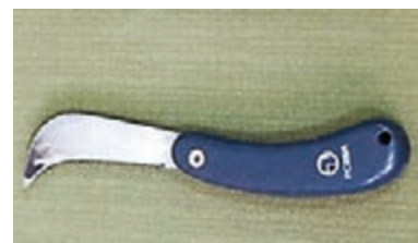
شکل (۱-۳۰) چاقوی مخصوص روپوش برداری کابل
