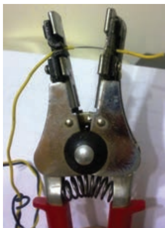
شکل (۱-۴) برداشتن روکش سیم‌ها
