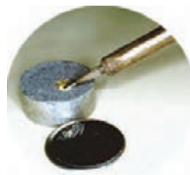
د- تمیز کردن سر هویه
