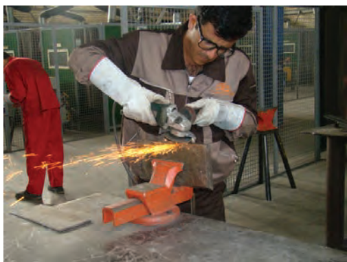
تشخیص نوع فولاد بر اساس آزمایش جرقه
