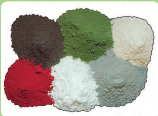
مواد پودری تشکیل دهنده روپوش الکتروده
