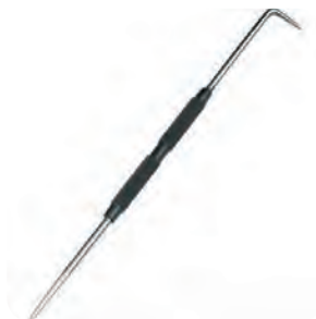
سوزن خط کشی روی قطعات فلزی
