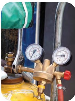
محکم کردن اتصالات رگولاتور به کپسول گاز
