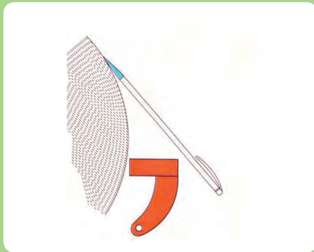
تیز کردن سوزن خط کش
