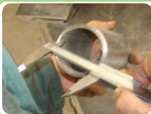
اندازه‌گیری قطر داخلی لوله توسط کولیس
