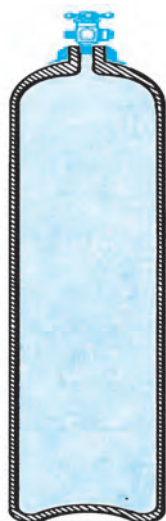
کپسول فولادی مخصوص برای ذخیره اکسیژن
