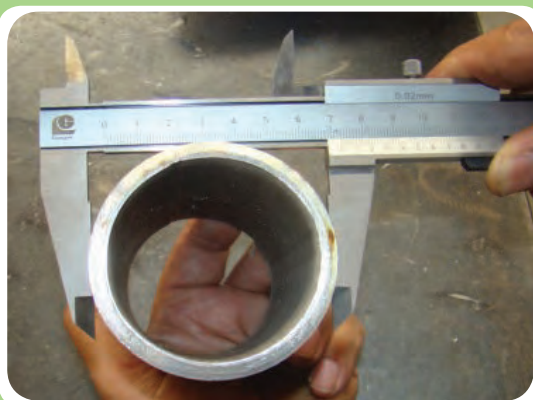
اندازه‌گیری قطر خارجی لوله توسط کولیس
