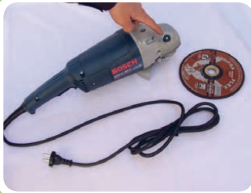
کلید مخصوص قفل کردن محور سنگ
