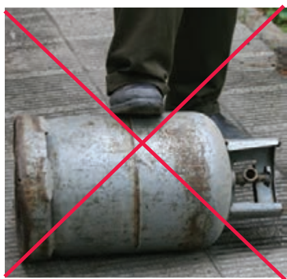
شکل ۶۹-۱ حمل و نقل نادرست کپسول گاز مایع
