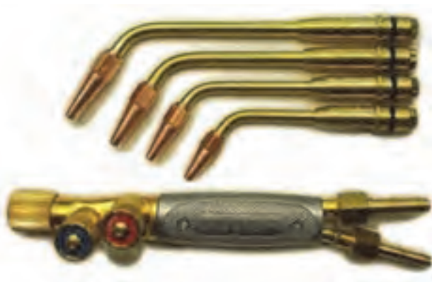
شکل ۶- مشعل جوشکاری و سرمشعل‌های آن
