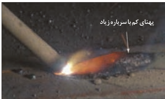
شکل ۳۰- جوشکاری با طول قوس بسیار کم
