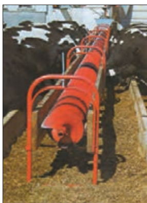
شکل ۲۲- توزیع خوراک به وسیله نقاله پیچی
