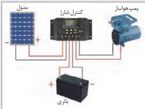
شکل ۴۱- مدار الکتریکی هواساز
