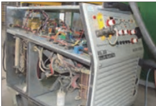
شکل ۱۱- ساختمان داخلی رکتیفایر
