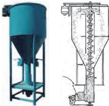
شکل ۷- مخلوط‌کن عمودی و نحوه عملکرد آن
