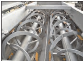
شکل ۸- مخلوط‌کن افقی و مارپیچ‌های آن
