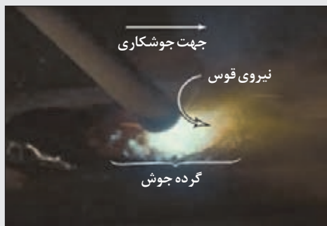
شکل ۳۹- جوشکاری با زاویه پیشران
