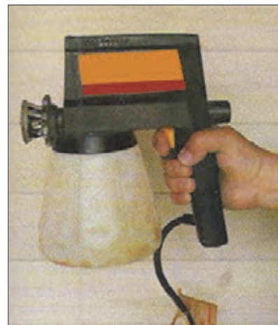
شکل ۶۱- پیستوله بدون کمک هوای فشرده (Airless)
