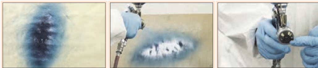
شکل ۶۶- تنظیم جهت پاشش
