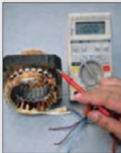
شکل ۷- آزمایش اتصال بدنه
