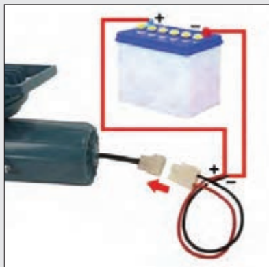
شکل ۴۲- اتصال پمپ با سوکت به باتری
