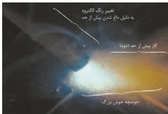
شکل ۲۷- جوشکاری با آمپر بسیار بالا
