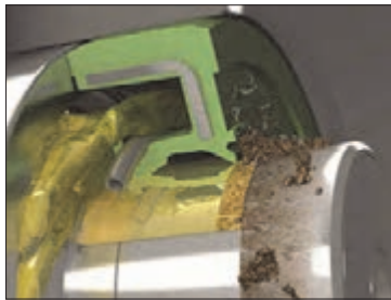
شکل ۶۸- کاسه نمد و نحوه عمل آن
