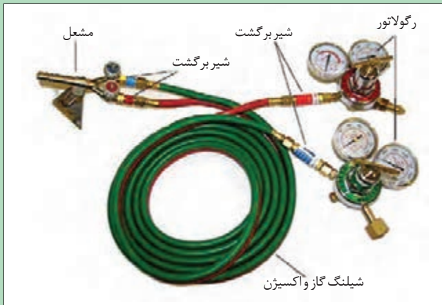
شکل ۱۸- محل نصب سوپاپ‌های یک طرفه (شیر برگشت)
