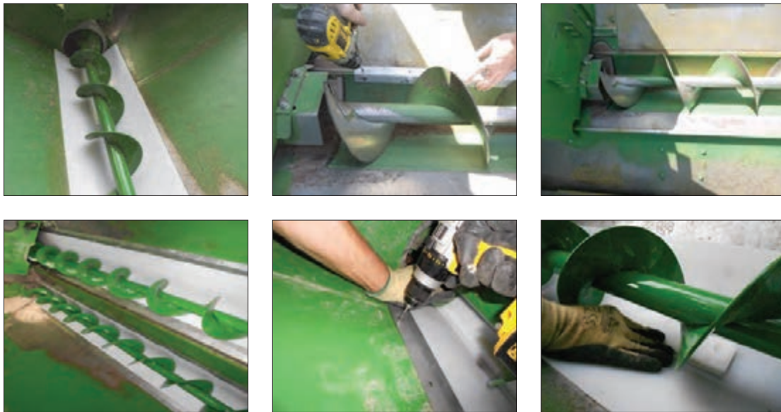
شکل ۳۵- تعمیر محفظه زیرین هلیس مخزن کمباین
