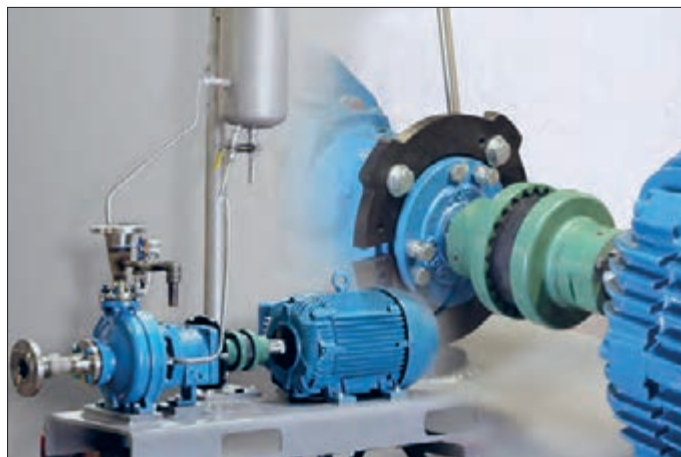
شکل ۸- انتقال قدرت مستقیم از موتور به دستگاه
