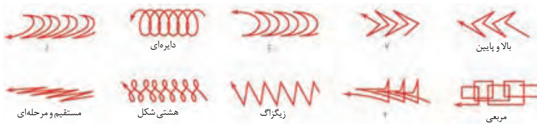
شکل ۴۴- انواع الگوهای حرکتی موجی شکل
