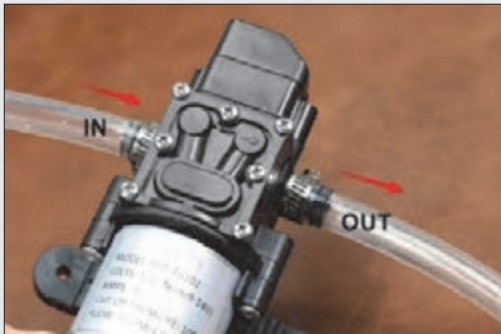
شکل ۳۲- اتصال پمپ و رعایت جهت حرکت سیال
