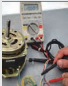
شکل ۷- آزمایش اتصال بدنه
