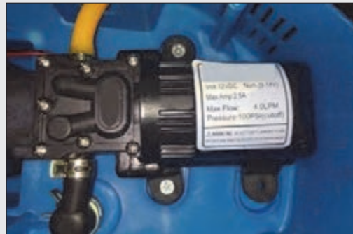
شکل ۳۲- اتصال پمپ و رعایت جهت حرکت سیال
