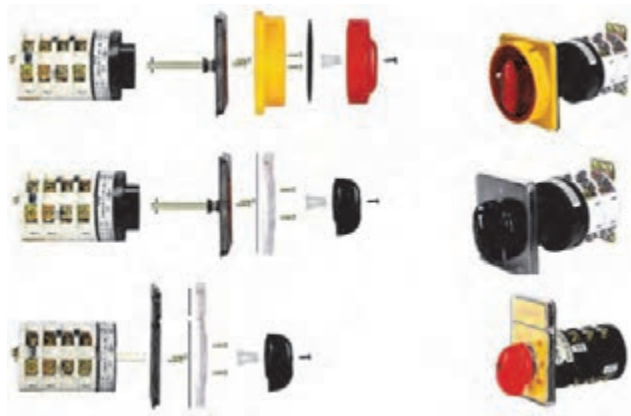
شکل ۱۳- نقشه تفکیکی کلید زبانه‌ای تابلویی (سلکتور)
