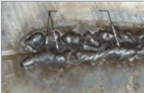
شکل ۵۱- عیب ایجاد شده در اثر حرکت سریع الکتروود در عرض جوش
