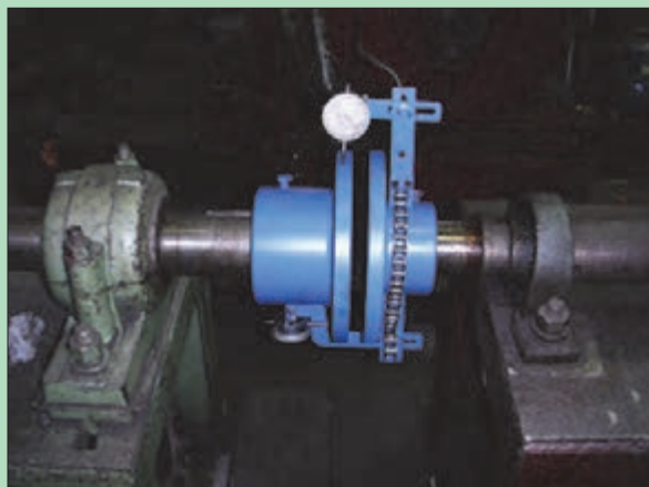
شکل ۷۷- هم‌راستا کردن محورها با ساعت اندازه‌گیری
