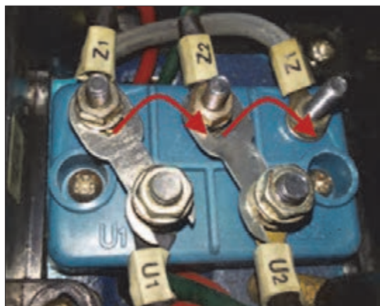
شکل ۱۵- تخته کلم و اتصال سیم پیچ‌های موتور تک فاز در جهت راست گرد و تبدیل آن به وضعیت چپ گرد با جابه‌جایی تسمه
