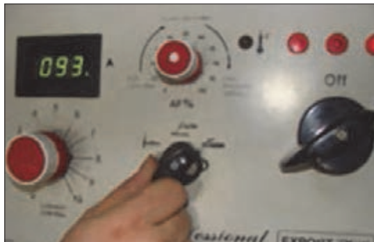
شکل ۱۲- کلیدهای مختلف برای تنظیم دستگاه جوشکاری
