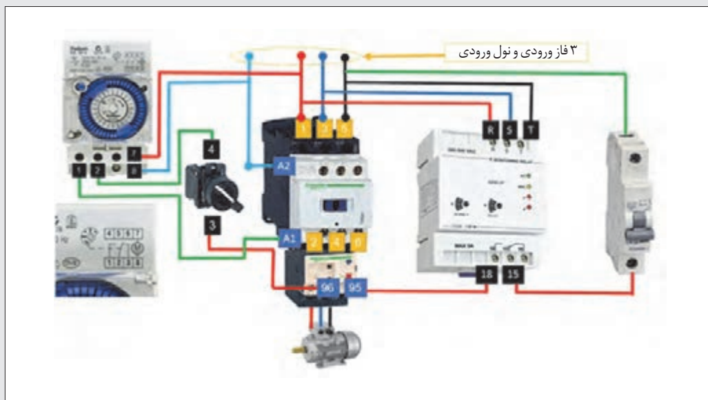
شکل ۳۵- مدار راه‌اندازی موتور سه فاز با حفاظت کامل و با استفاده از تایمر
