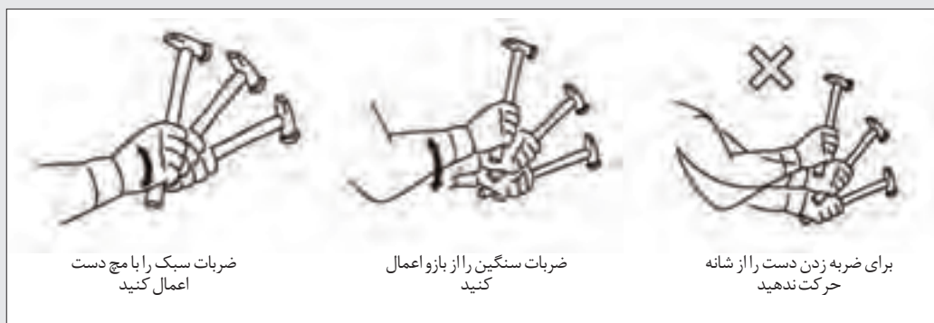
شکل ۵۰- روش ضربه زدن با چکش
