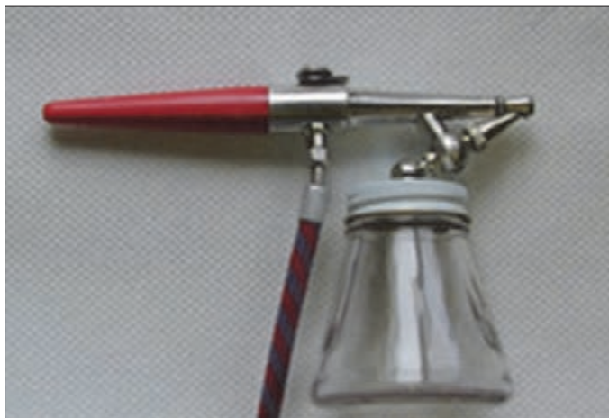
شکل ۶۲- ایربراش یا قلم رنگ پاش (Airbrush)
