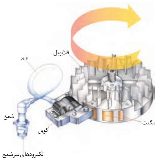
شکل ۷- طرز کار سیستم جرقه‌زنی
