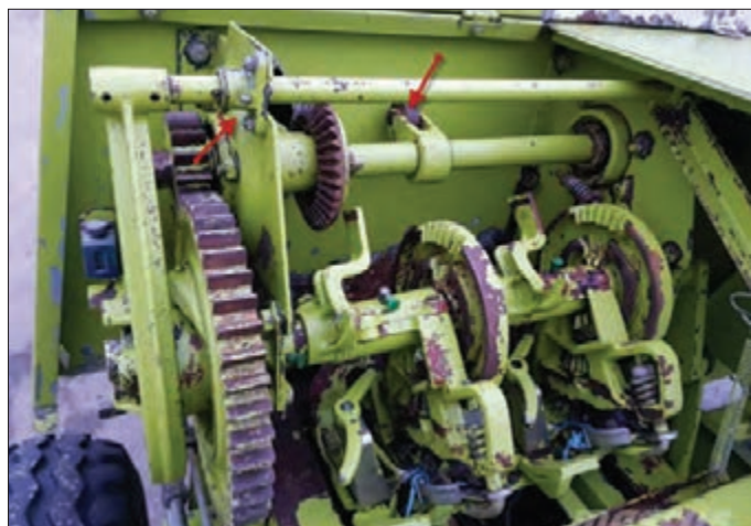
شکل ۷۵- یاتاقان‌ها و نگهدارنده فرمان‌دهنده گره‌زن
