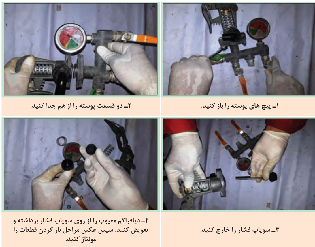
شکل ۵۲- تعویض دیافراگم رگولاتور مدل کمت
