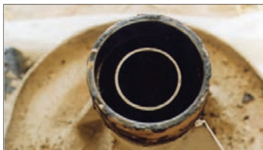
شکل ۴۳- ساییدگی جای بلبرینگ
