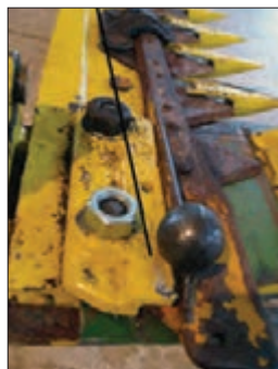
شکل ۶۳- تنظیم لقی سر شانه برش
