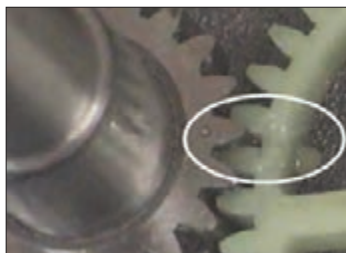
شکل ۳۳- علامت تایم کردن میل بادامک
