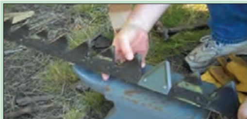
۶- وضعیت تیغه و پرچ‌ها را بررسی کنید.
