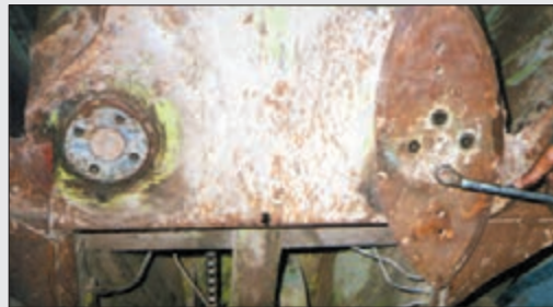
شکل ۳۱- باز کردن تیغه متحرک
