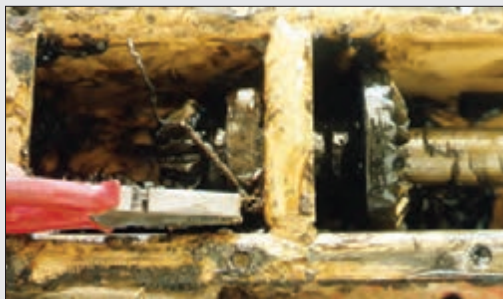
شکل ۲۶- باز کردن سیم مفتولی
