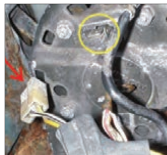
شکل ۲۶- جدا کردن کاتوچویی سیم‌کشی لامپ شارژ
