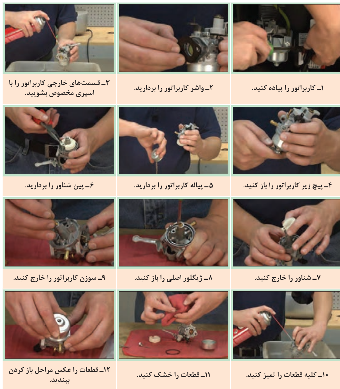
شکل ۲۵- باز کردن و تمیز کردن قطعات کاربراتور
