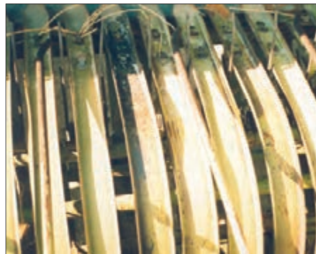
شکل ۶- ساییده شدن انگشتی‌ها به تسمه‌های راهنما
