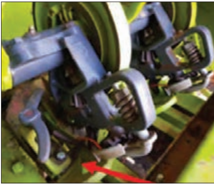
شکل ۳۸- هادی نخ و موقعیت آن روی گره‌زن
