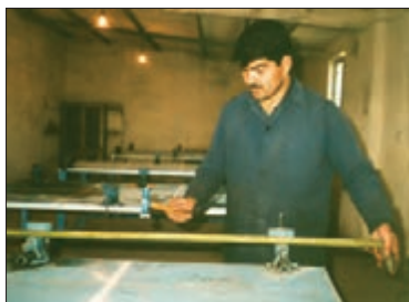
شکل ۱۱- صاف کردن محور انگشتی
