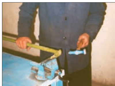
شکل ۱۵- صاف کردن پایه بلبرینگ
