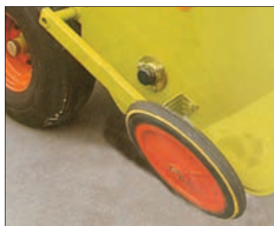
شکل ۲۸- چرخ تنظیم کج شده
