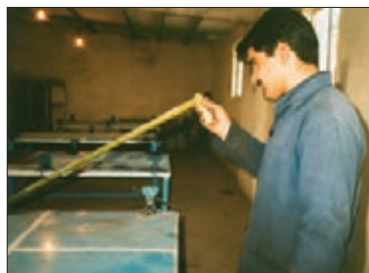
شکل ۱۰- آزمایش کجی محور انگشتی
