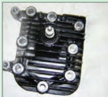
۸- سر سیلندر را پیاده کرده و پیچ‌های آن را به ترتیب در محل رسم شده روی کارت بچینید.
