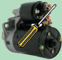
شکل ۴۳- اتصال کوتاه موتور استارت
