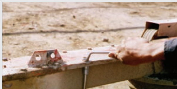
شکل ۲۰- باز کردن پیچ‌های سرپوش جعبه دنده
