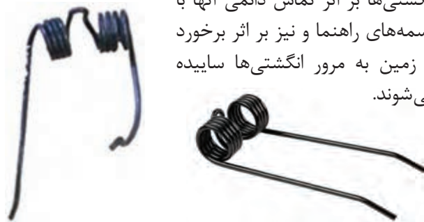
شکل ۴- تفاوت انگشتی سالم و انگشتی معیوب
