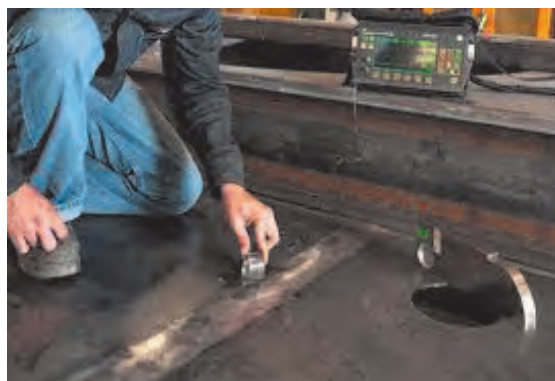
شکل ۹۱ ▲ بازرسی به روش اولتراسونیک
