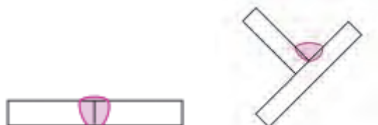
شکل ۷۷ ▲ جوشکاری در وضعیت تخت
