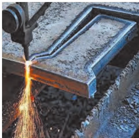
شکل ۴۸ ▲ برش کاری ورق کله‌گای
