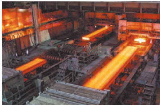
شکل ۳ ▲ نورد گرم ورق فولادی
