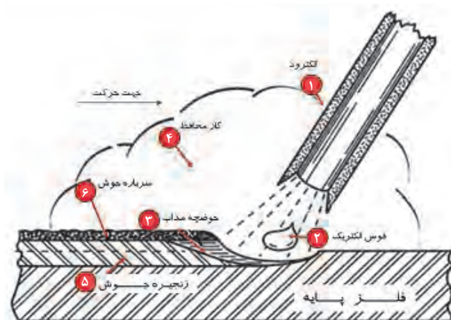
شکل ۷۰ ▲ جوش با قوس الکتریکی و الکتروود روکش‌دار
