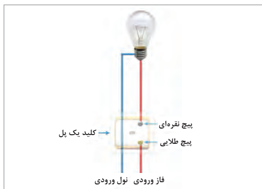
شکل ۳-۳۵- مدار الکتریکی کلید یک پل
