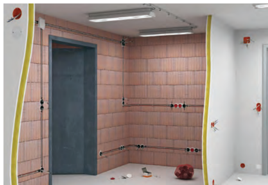
شکل ۳-۳۳- سیم‌کشی توکار
