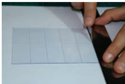
شکل ۵-۸۷- ساخت نمای چوبی: چسباندن برچسب‌های شفاف و ایجاد شیار بر روی آن شکل ۵-۸۸- ساخت نمای شیشه‌ای با استفاده از طلق
