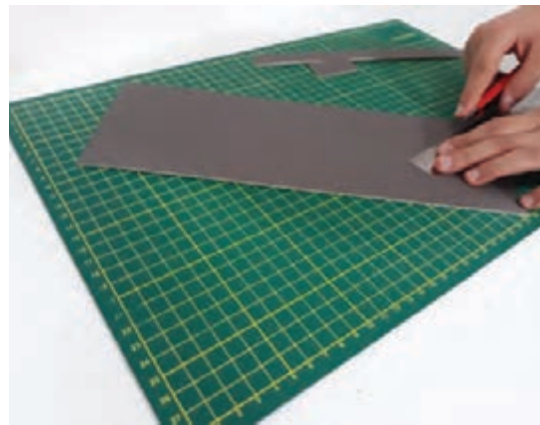
شکل ۱۰۹-۵- اجرای شیارهای رامپ با کاتر و فشار دست
