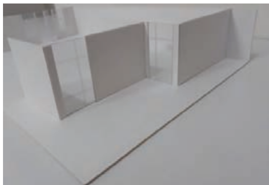
شکل ۷۹-۵- برش و اتصال دیواره‌های داخلی و نصب درهای ورودی
