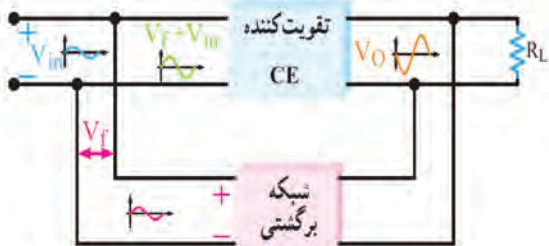
شکل ۱۷-۱۰. بلوک دیاگرام تقویت کننده با فیدبک مثبت
