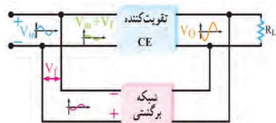
شکل ۱۸-۱۰. بلوک دیاگرام تقویت کننده با فیدبک منفی
