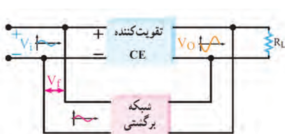
شکل ۱۶-۱۰. بلوک دیاگرام تقویت کننده با فیدبک
