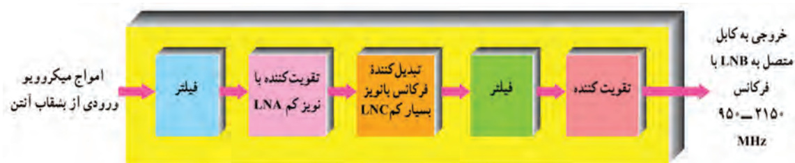
شکل ۴-۲۶ بلوک دیاگرام ساده LNB
