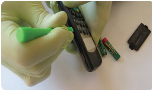
شکل ۸-۱ آزاد کردن خارهای قاب دستگاه ریموت کنترل
