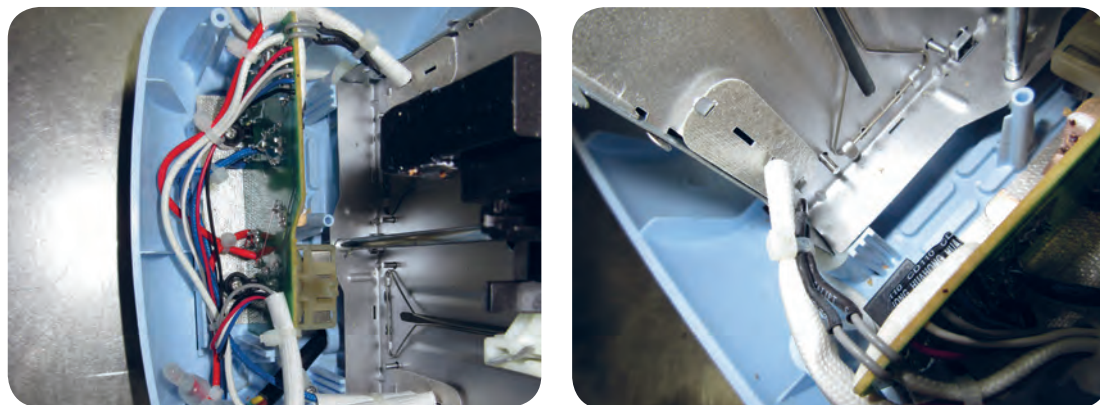
الف شکل ۶-۴۹ محل قرار گرفتن حسگر حرارتی
