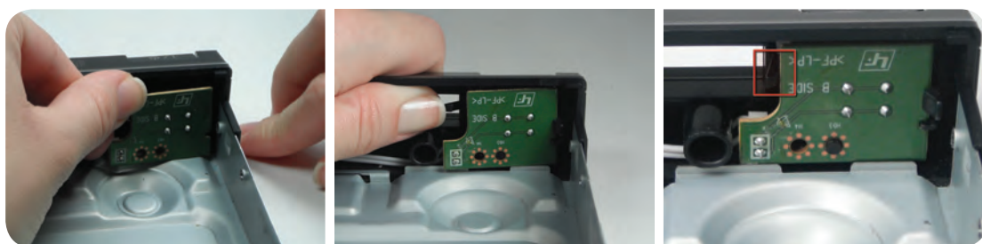
شکل ۶-۳۳ محل زائده پلاستیکی شکل ۶-۳۴ فشار دادن زائده پلاستیکی شکل ۶-۳۵ ديمونتاژ برد کوچک
