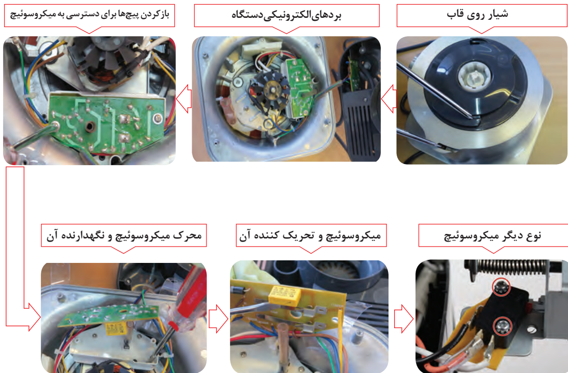
شکل ۲۵-۱- اینفوگرافی جدا کردن میکروسوییچ
