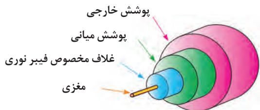
شکل ۴-۸- فیبر نوری و اجزای آن
