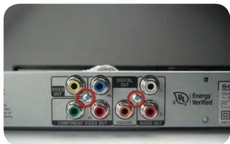
شکل ۲۲-۶ باز کردن پیچ‌نهایی برد پردازشگر
