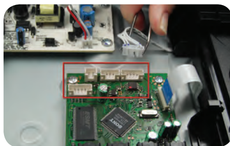
شکل ۱۹-۶ جدا کردن سوکت‌ها از برد پردازشگر
