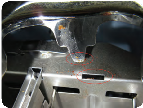
شکل ۶-۵۸ خار نر و ماده جهت اتصال
