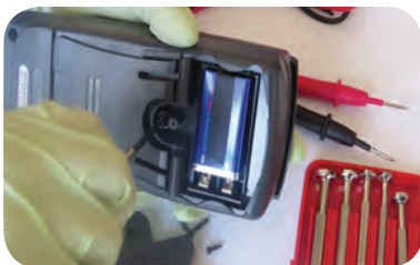
شکل ۱۴-۱- باز کردن پیچ‌ها و آزادسازی خارها
