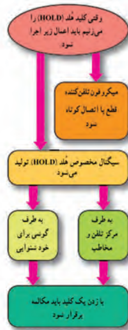
شکل ۳۲-۵- عملکرد مدار هلد
