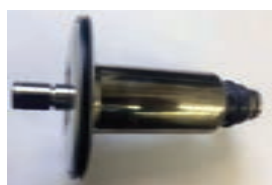
شکل ۱۱- روتور داخل محفظه فولادی
