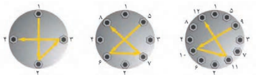
شکل ۲۳- ترتیب سفت کردن پیچ‌های فلنج
