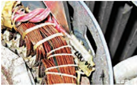
شکل ۳۶- محافظ حرارتی سیم پیچ موتور
