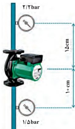
شکل ۳۲- وجود فشارسنج دو سمت پمپ با اختلاف سطح
