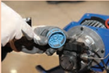
بازکردن درپوش پمپ و تمیز کردن فیلتر
