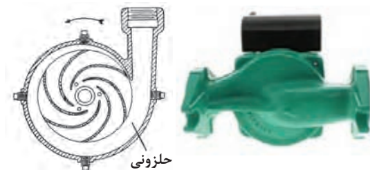
شکل ۷- پوسته حلزونی در پمپ خطی و زمینی
