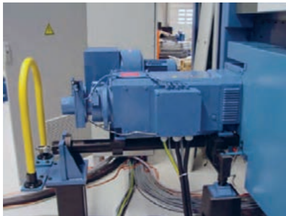
شکل ۲۷- الکترو موتور DC کمپوند
