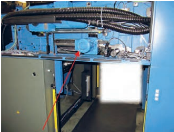
شکل ۳۱- موتور AC برای بالا پایین بردن تخته یدک کاغذ در بخش تغذیه
