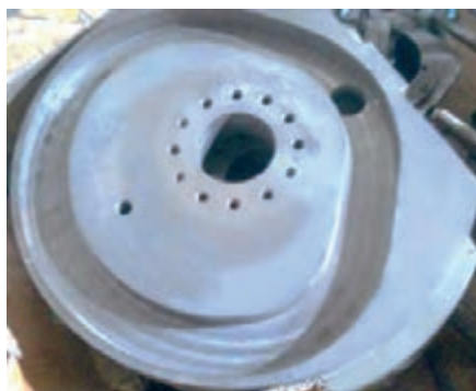
شکل ۱۴-پ) یک لنگ شیاردار در ماشین دایکات
