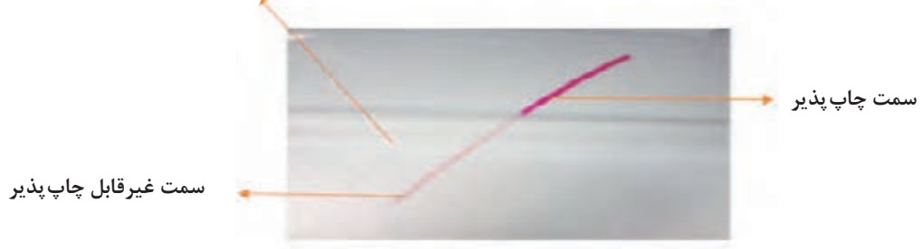
شکل ۲۲- نتیجه تست کرونا تریمنت
