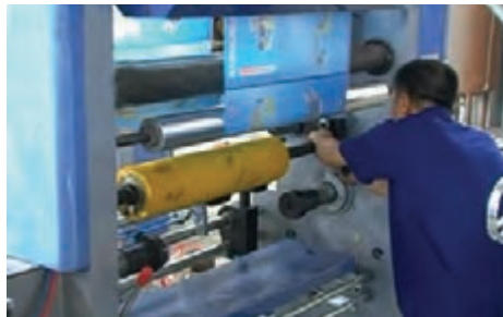
شکل ۶۴- نصب پرس رول سمت اپراتور
