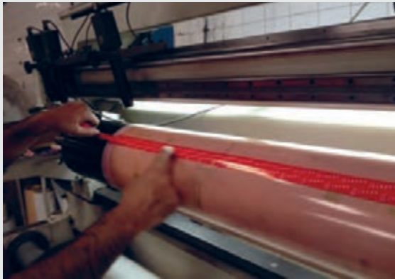
شکل ۲۸- نحوه چسباندن چسب لبه کلیشه
