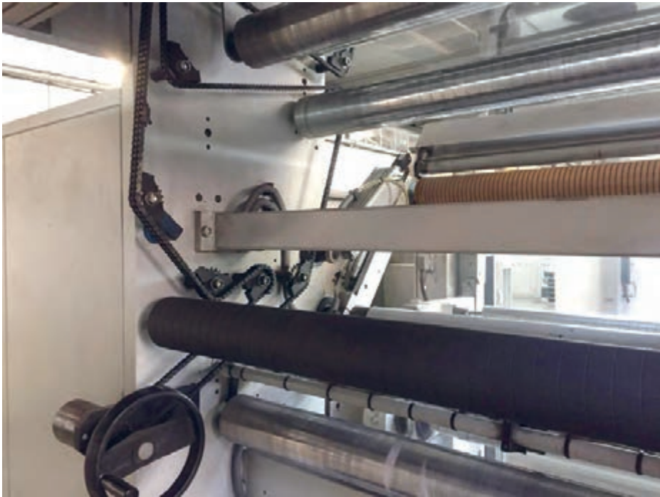
شکل ۵۵- مسیر عبور سطح چاپ شونده از لابه لای رول های آزاد چرخ
