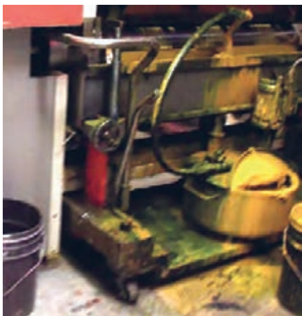
شکل ۴۸- سر ریز شدن مرکب
