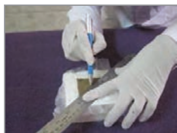
الف ب ج شکل ۷- ساخت نمونه انقباض و رسم قطرهای
