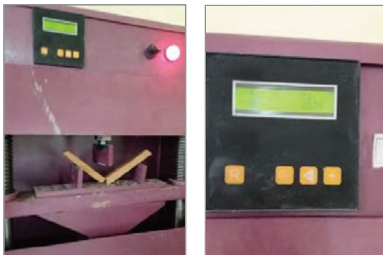
شکل ۲۴- اندازه‌گیری استحکام خمشی خشک نمونه‌ها
