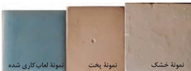
شکل ۱۲- تأثیر انقباض پخت بر ابعاد نمونه
