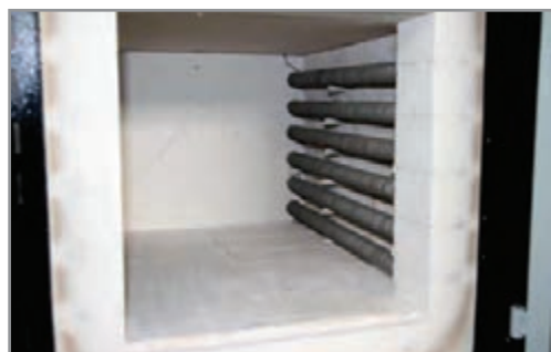
شکل ۱۲- نصب المنت بر روی پایه
