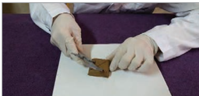
شکل ۸- علامت‌گذاری به وسیله کولیس
