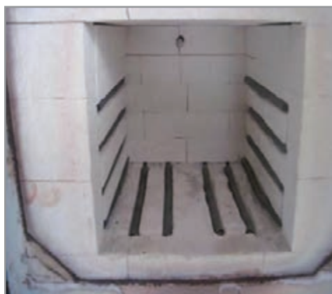
شکل ۱۳- نصب المنت درون شیار
