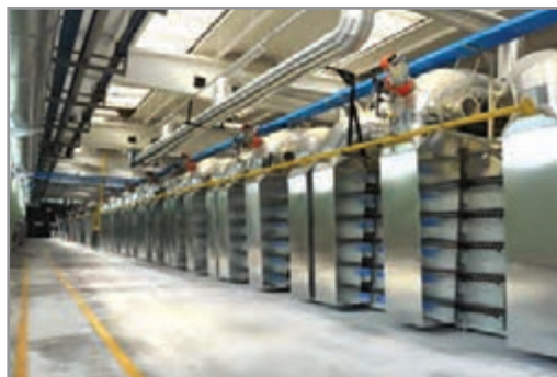
شکل ۱۳- خشک کن پیوسته
