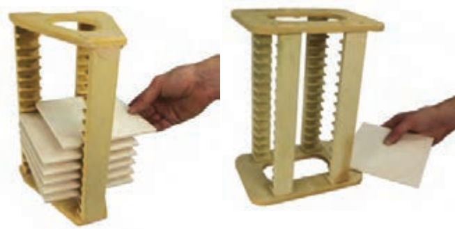
شکل ۵۱ - چیدمان کاشی در چنگک
