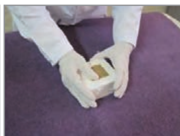
الف ب ج شکل ۷- ساخت نمونه انقباض و رسم قطرهای
