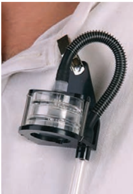
نصب صافی در ناحیه تنفسی شخص نمونه‌گیر
