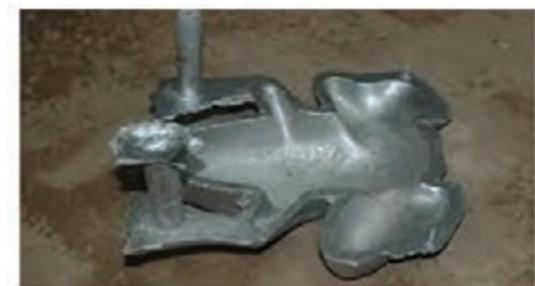
شکل ۲- یک قطعه خام با ناصافی‌ها در سطح
