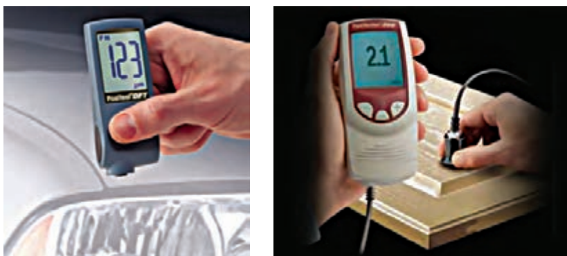
شکل ۲۲- انواع ضخامت‌سنج فیلم خشک رنگ (غیر تخریبی)
