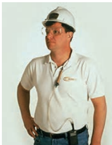
شکل ۱۸- شیوه اتصال دستگاه لوله جذب به شخص نمونه‌گیر
