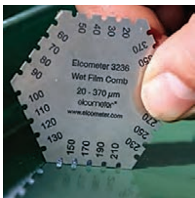
شکل ۱۹- شانه مخصوص اندازه‌گیری ضخامت فیلم تر رنگ
