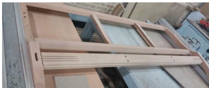
شکل ۵۰- جا زدن پشتی مبل با تنگ پنوماتیکی
