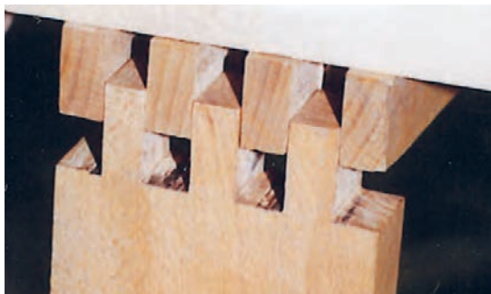
شکل ۱۲- اتصال انگشتی با تعداد زبانه فرد
