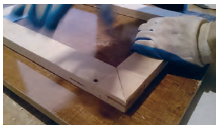
شکل ۲۴- جا زدن اتصالات در جای خود و بستن قاب با گیره تسمه‌ای
