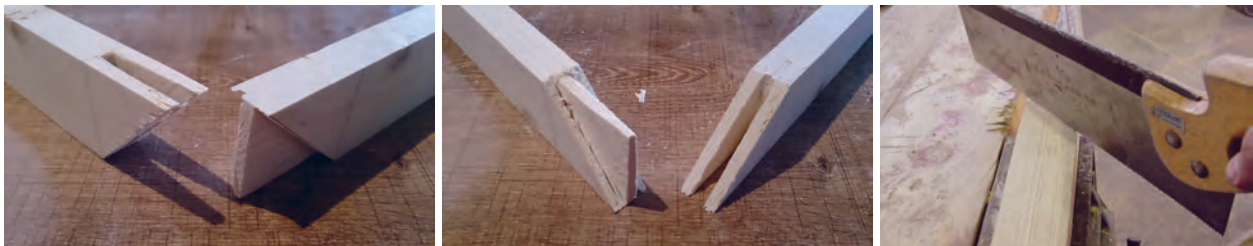
شکل ۲۰- برشکاری اتصال دو رو فارسی
