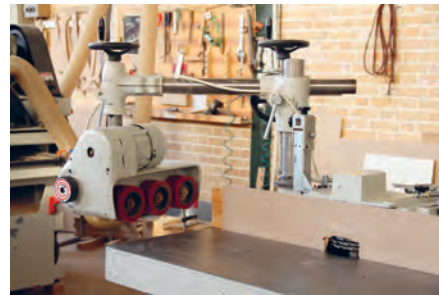
شکل ۹۳- اتصال انگشتی با دستگاه فرز میزی و دستگاه هدایت
