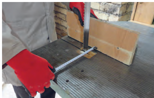
شکل ۷۴- اندازه‌گیری فاصله تیغه با گونیا
