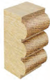
شکل ۶۰- ایجاد اتصال انگشتی با دستگاه فرز میزی و استفاده از دستگاه هدایت
