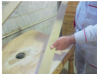
شکل ۷۴- ایجاد شیار به عمق ۸ و پهنای ۵ میلی متر برای قرارگیری آینه
