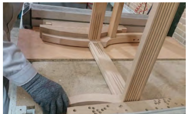
شکل ۵۵- جا زدن اتصالات با تنگ پنوماتیکی
