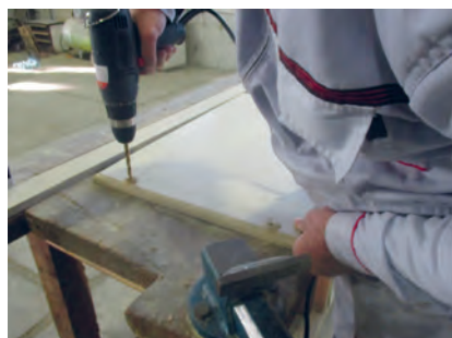
شکل ۶۶- عملیات اتصال دوبل به وسیله دریل دستی
