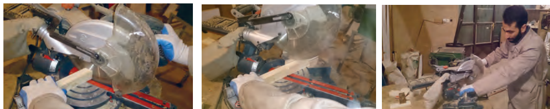
شکل ۳۰- برش قیده‌های شش ضلعی توسط دستگاه فارسی بر
