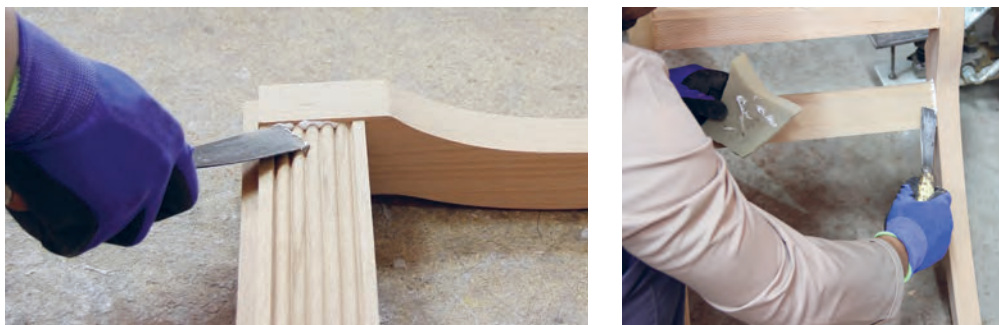
شکل ۶۷- تمیز کردن چسب اضافی با کاردک
