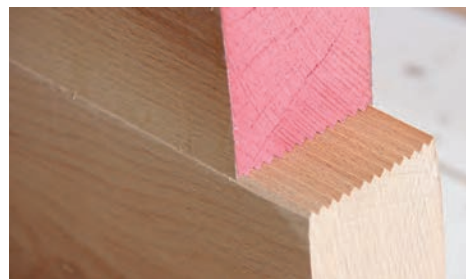
شکل ۱۳- اتصال انگشتی ساخته شده با دستگاه فرز
