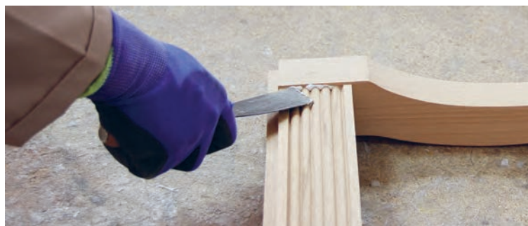
شکل ۱۰۲- تمیز کردن چسب اضافی با کاردک
