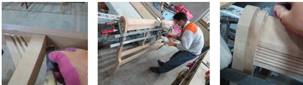
شکل ۵۲- تمیز کردن چسب اضافی روی قطعه کار
