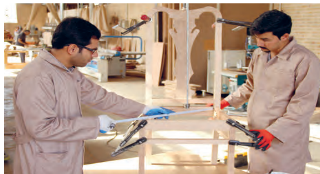
شکل ۱۰۹- کنترل دوئیدگی با متر
