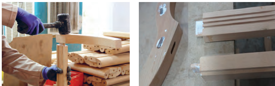
شکل ۴۵- روش چسب زدن با قلم‌مو داخل کام پایه‌های عقب
