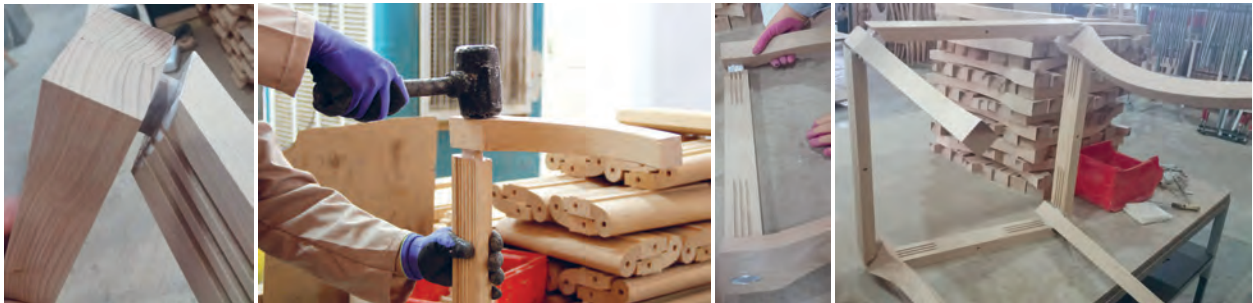
شکل ۶۵- جا زدن زبان‌ها و مراحل مونتاژ پایه‌ها و قیدهای جلو
