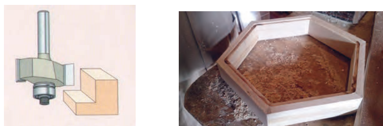
شکل ۴۰- دوراها زدن کف قاب شش ضلعی
