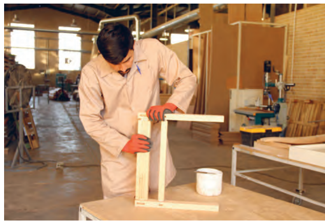
شکل ۱۰۱- استفاده از چکش لاستیکی برای جا زدن زبانه‌ها و مراحل مونتاژ پایه‌ها و قیده‌های جلو
