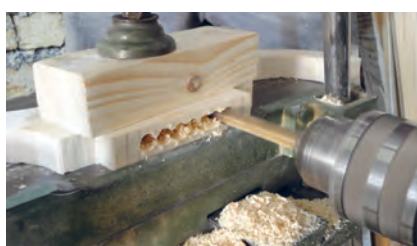
شکل ۸۸- عملیات کم کنی با دستگاه سه کاره
