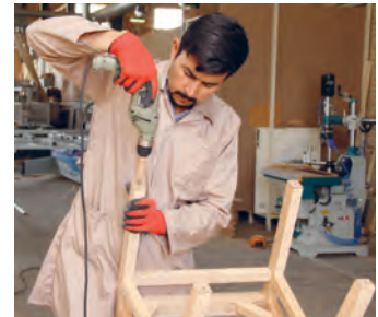
شکل ۱۱۲- سوراخکاری کف پایه با دریل
