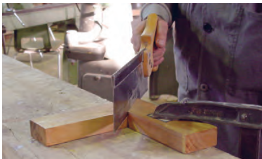
شکل ۲۱ - چگونگی اره‌کشی درز بین اتصال
