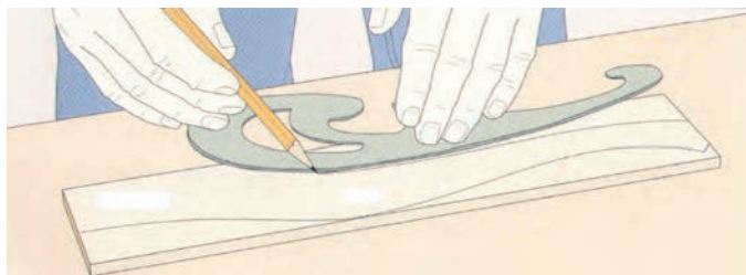
شکل ۴۲- آماده کردن الگوی پایه به وسیله پیستوله
