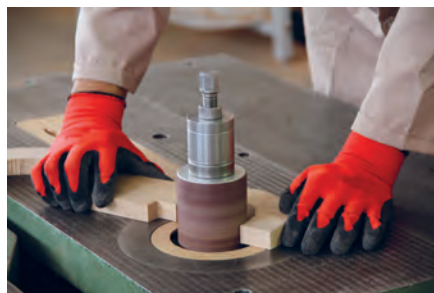
شکل ۸۵- عمل پرداخت تاج صندلی با ماشین سنباده تویی
