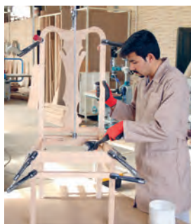
شکل ۱۰۷- جا زدن نبشی به وسیله چکش لاستیکی
