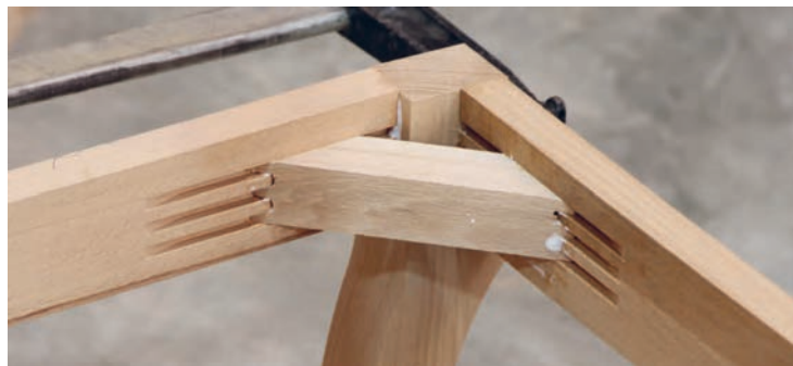
شکل ۱۲- اتصال انگشتی نبشی (بلوک سه‌گوش)
