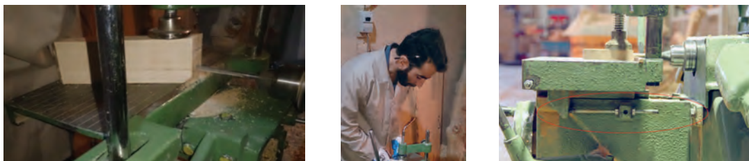
شکل ۳۲- عملیات سوراخکاری اتصال دوبل
