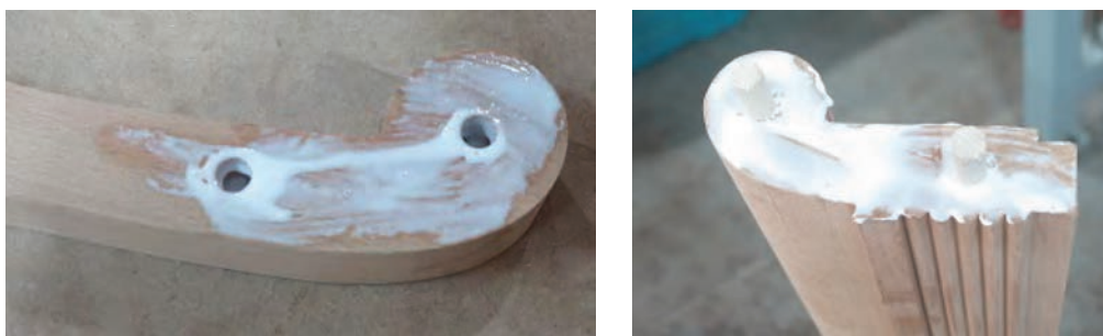
شکل ۴۶- روش چسب زدن اتصال دوبل پایه‌های عقب
