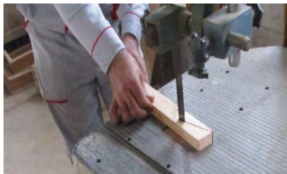
شکل ۶۳- پایان قوس بری با دستگاه اره نواری
