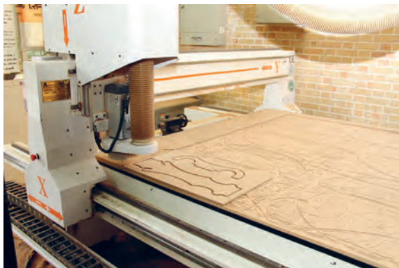
شکل ۶۷- تهیه شابلون با دستگاه فرز CNC
