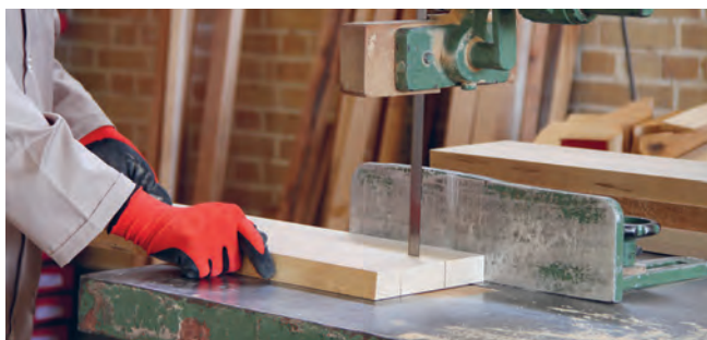
شکل ۷۶- نحوه برش کاری صحیح، چوب و وضعیت استقرار دست‌ها هنگام برش کاری مستقیم
