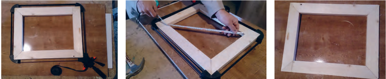
شکل ۲۵- کنترل دوئیدگی و صحیح بودن قاب
