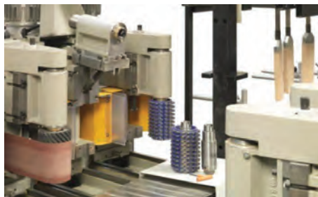
شکل ۳۹- پرداخت قطعه کار به وسیله دستگاه اتوماتیک شیپر
