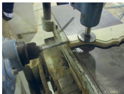
شکل ۶۵- عملیات اتصال دوبل با دستگاه کم‌کن
