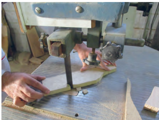
شکل ۶۲- عملیات قوس‌بری با دستگاه اره نواری
