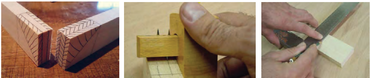
شکل ۱۹- اندازه‌گذاری و خط‌کشی اتصال فاق و زبانه دو رو فارسی
