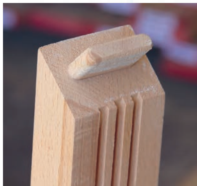
شکل ۵۹- اتصال کام تحت زاویه ۴۵ درجه
