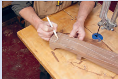
شکل ۴۷- خط کشی دوباره روی چوب
