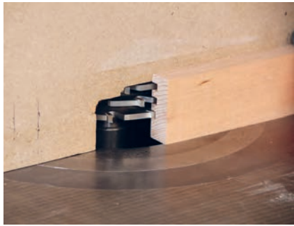
شکل ۶۱- تیغ فرز مخصوص زهوار صفحه
