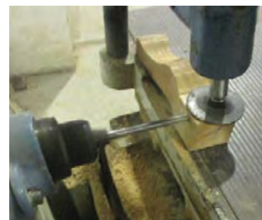
شکل ۶۵- عملیات اتصال دوبل با دستگاه کم‌کن
