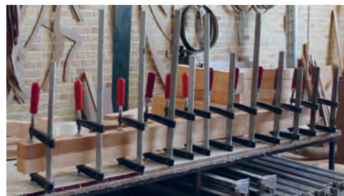
شکل ۱۴- چسباندن و عریض کردن چوب ها به وسیله چسب و گیره دستی
