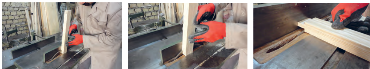
شکل ۹۱- عملیات برش زبانه با دستگاه اره گرد
