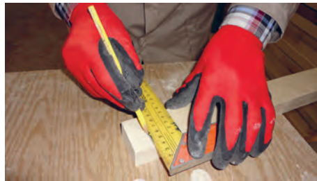
شکل ۸۷- علامت زدن قطعات مختلف برای انجام اتصال
