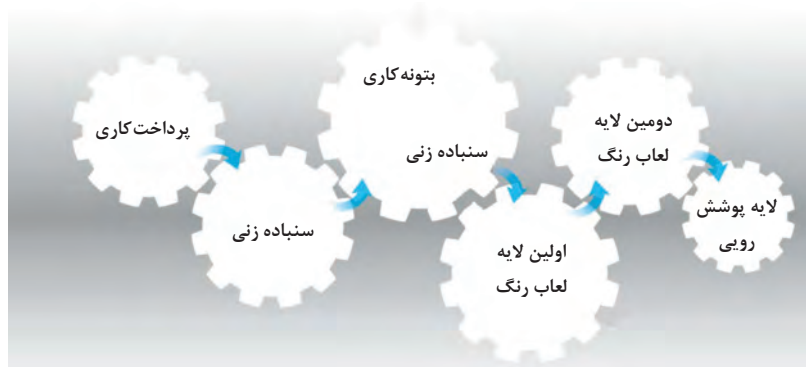
شکل ۱۱۵- مراحل اجرای رنگ کاری
