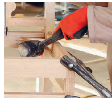
شکل ۱۰۷- جا زدن نبشی به وسیله چکش لاستیکی
