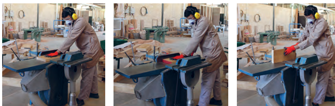
شکل ۷۰- یک رو و یک نرکردن چوب
