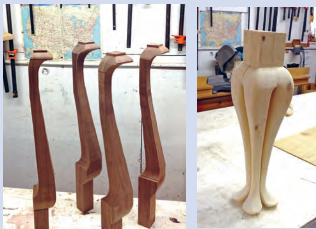
شکل ۵۱- آماده شدن پایه‌ها برای ایجاد کام
