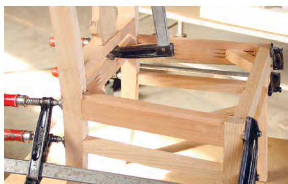
شکل ۱۱۰- نصب نبشی ها
