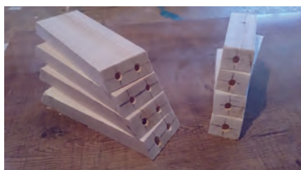
شکل ۳۳- سوراخ کردن قیده‌ها تحت زاویه
