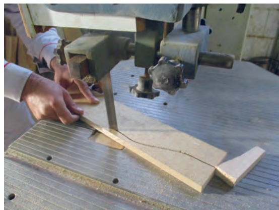
شکل ۶۲- عملیات قوس‌بری با دستگاه اره نواری
