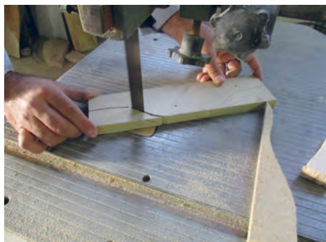
شکل ۶۳- پایان قوس بری با دستگاه اره نواری
