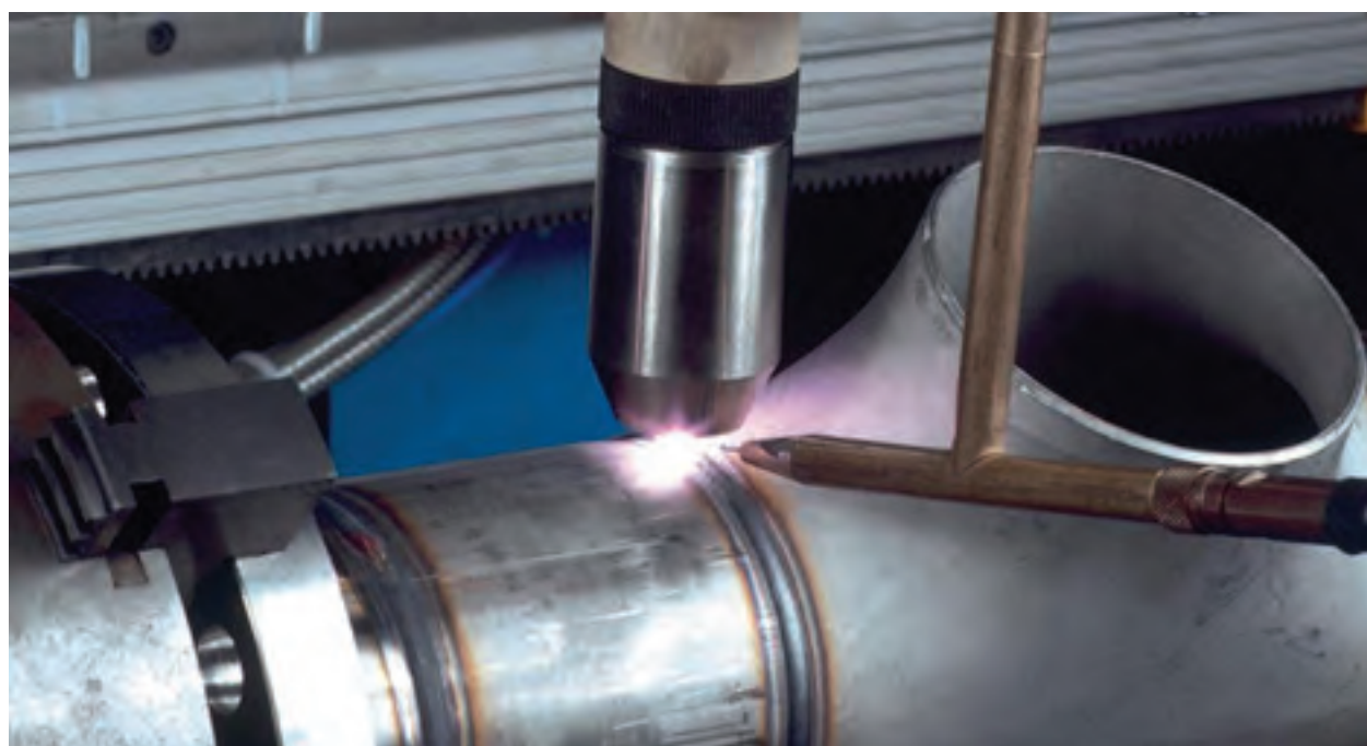
شکل ۲۸: جوشکاری قوس پلاسما
