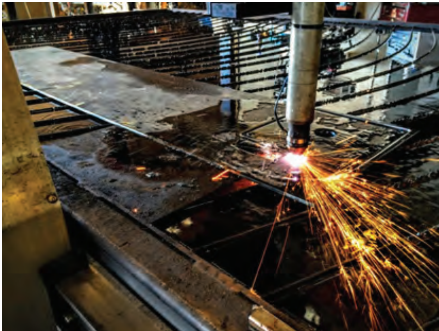
شکل ۲۴: برشکاری پلاسما
