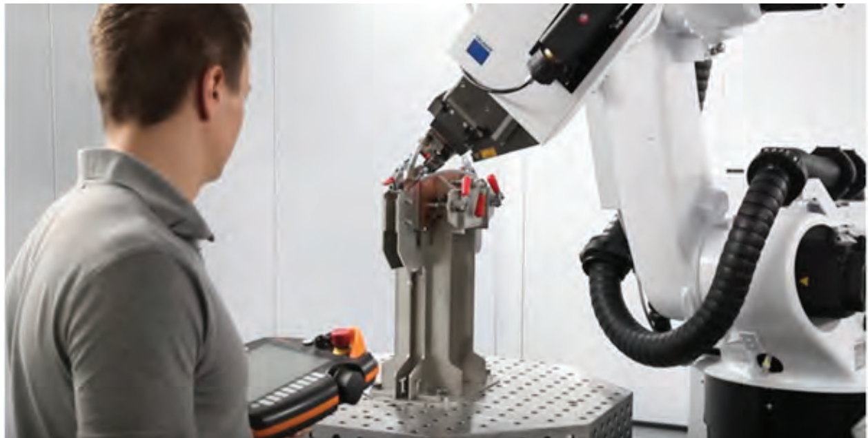
شکل ۲۲: جوشکاری لیزر
